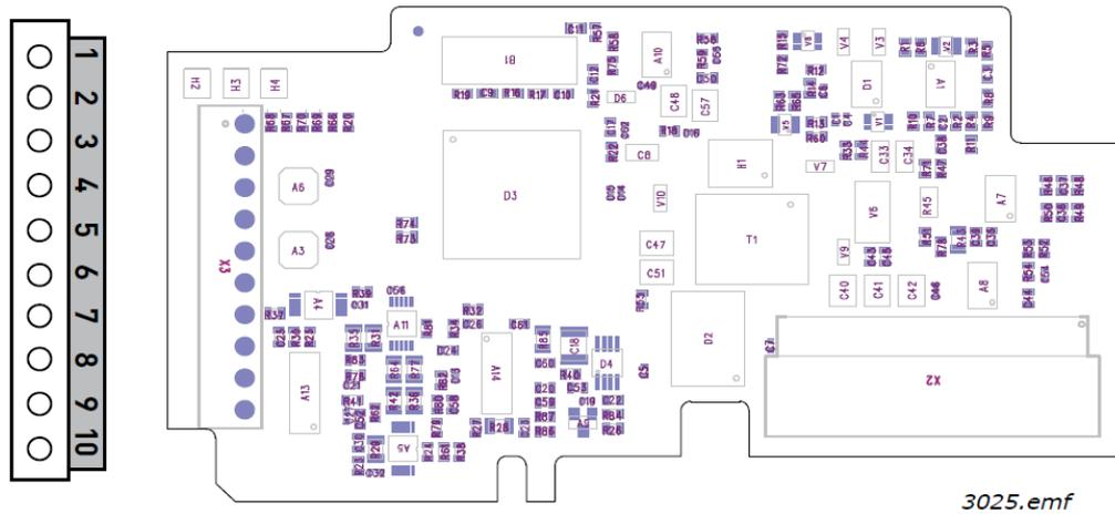
**Descripción:** Tarjeta de medición de temperatura con tres canales individuales.
