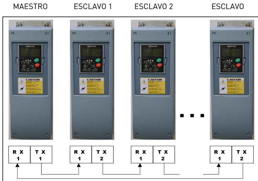
Figura 3-18. Ejemplo de conexión de convertidores de frecuencia con OPT-D2
