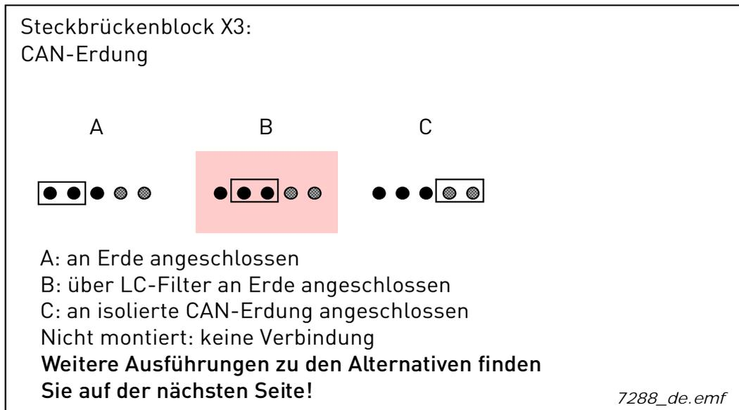
Abbildung 26. X3-Steckbrückenauswahl für OPTD2 ab Version H
