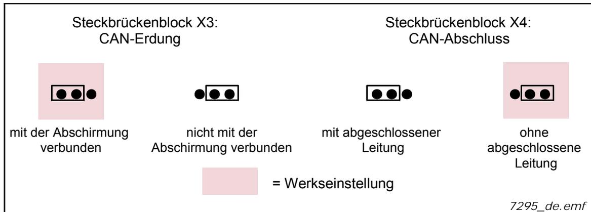
Abbildung 30. Steckbrückenauswahl für OPTD6 bis Version E
