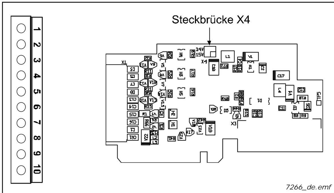
Beschreibung: Encoderkarte für VACON® NXP. Encodereingangskarte mit programmierbarer Steuerspannung für einen Encoder.
