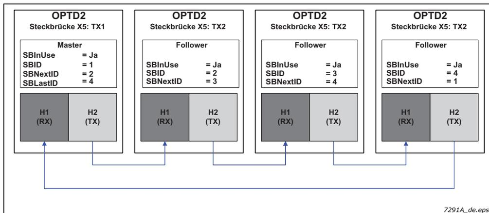
Abbildung 29. Schaltungsbeispiel für Frequenzumrichter mit OPTD2
