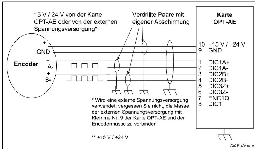
Abbildung 21. Encoderverbindung des Typs HTL (Open Collector) mit einpolig geerdeten Eingängen
