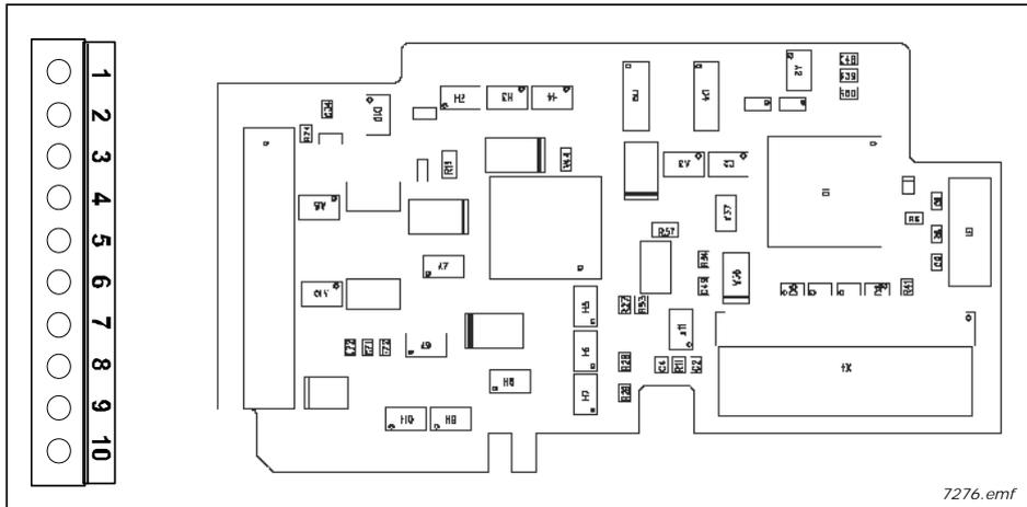
Beschreibung: VACON® NX-E/A-Zusatzkarte mit einem galvanisch getrennten Analogeingang und zwei galvanisch getrennten Analogausgängen (Standardsignale 0(4)–20 mA)
