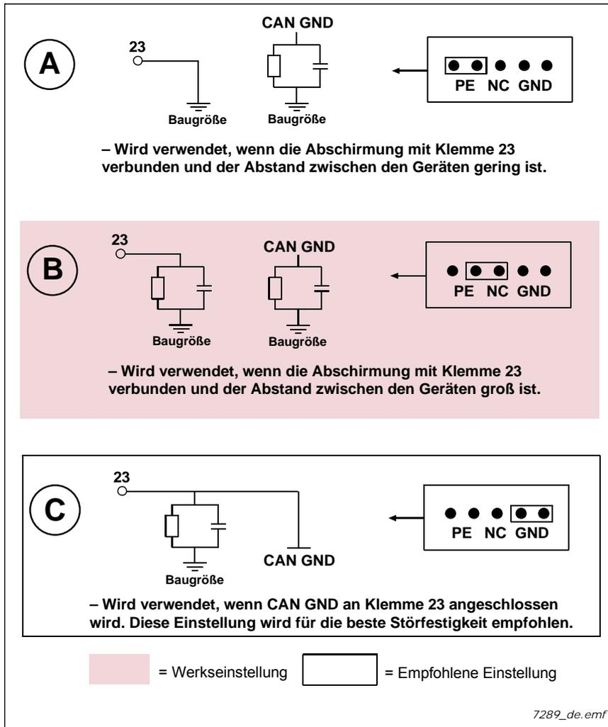
Abbildung 27. CAN-Erdungsalternativen
