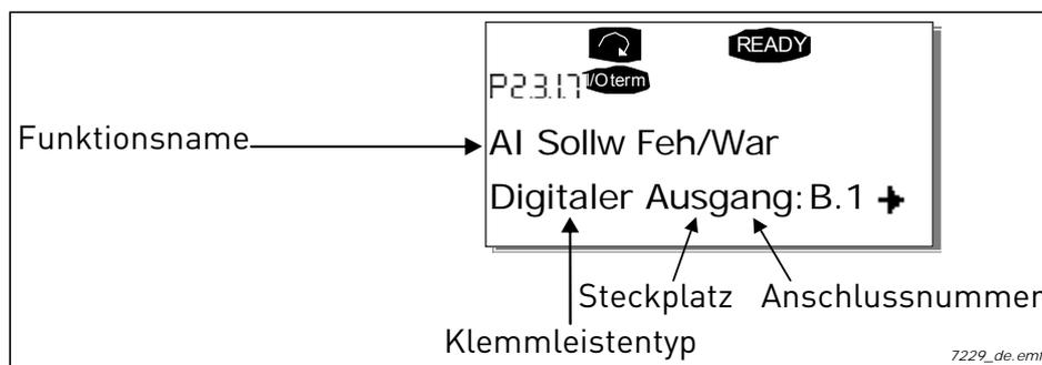
Beispiel: Sie verwenden die Pumpen- und Lüftersteuerungsanwendung. Sie möchten die Digitalausgang-Funktion Sollwert Fehler/Warnung (Parameter 2.3.1.7) mit dem Digitalausgang DO1 auf der Basiskarte OPTA1 verbinden.
