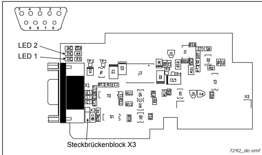
Beschreibung: RS-232-Adapterkarte. Galvanisch entkoppelt. Hauptsächlich für das Engineering von Anwendungen verwendet, um eine andere Steuertafel anzuschließen
