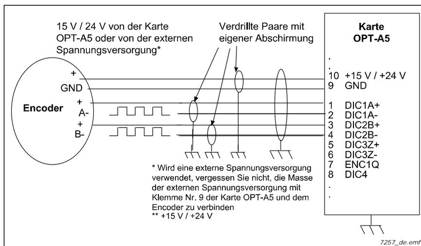
Abbildung 16. Encoderverbindung des Typs HTL (Open Collector) mit einpolig geerdeten Eingängen
