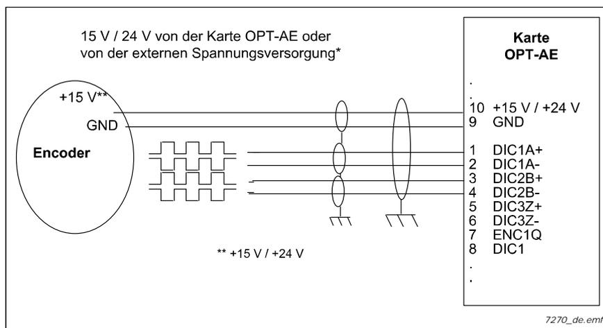
Abbildung 22. Encoderverbindung des Typs HTL mit Differenzialeingängen
