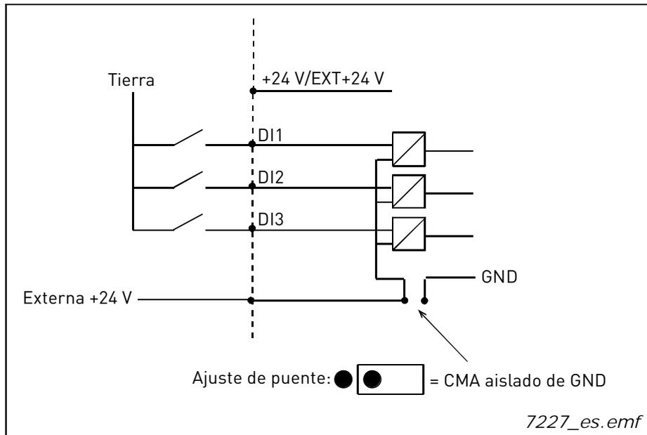
Figura 6. Lógica negativa con +24 V externos si el CMA está aislado con un puente interior.
