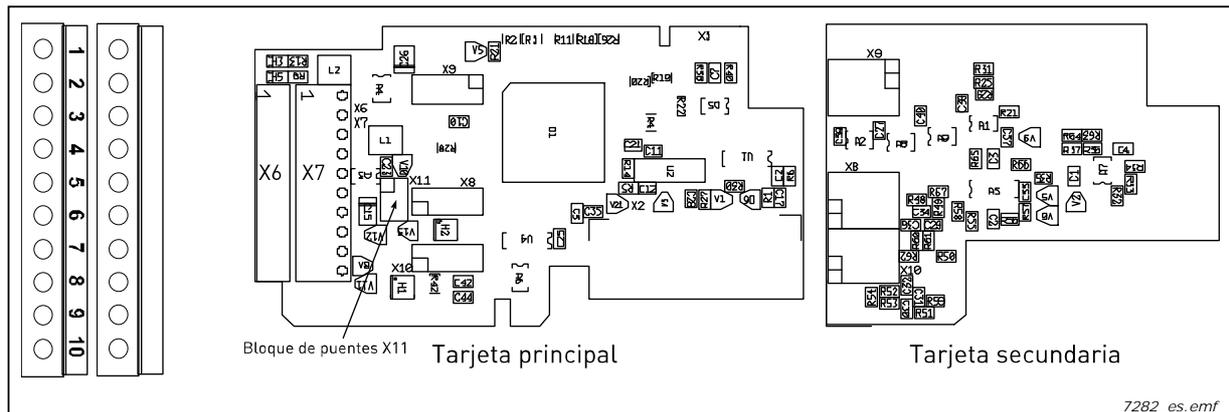
**Descripción:** Tarjeta de encoder absoluto para VACON® NXP con entradas de un encoder de tipo Endat. Tensión de control programable, entradas digitales rápidas y salida de pulsos simulados.
