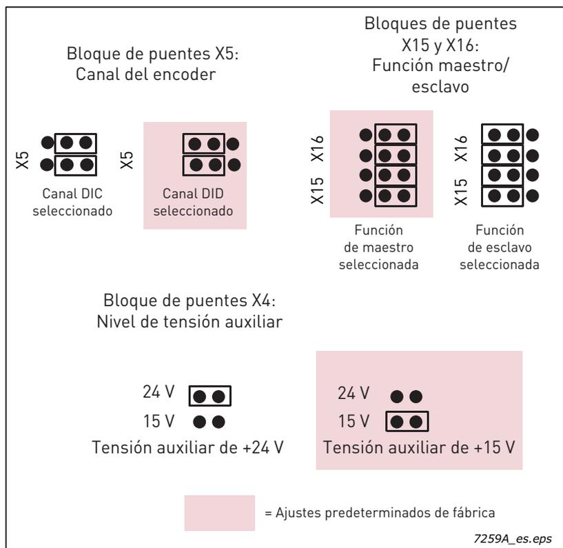
Uso: Control vectorial de lazo cerrado, aplicaciones de posicionamiento. La tarjeta del encoder OPTA7 se usa principalmente en aplicaciones de sistema exigentes, como al medir la velocidad del motor con dos encoders.
