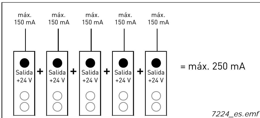
Figura 3. Cargas máximas en la salida +24 V/EXT+24 V
