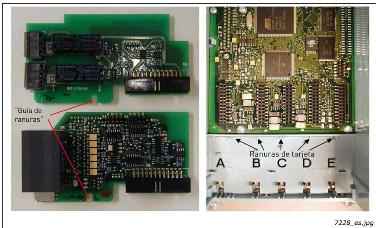
Figura 7. Guía de tarjetas para evitar instalaciones incorrectas
