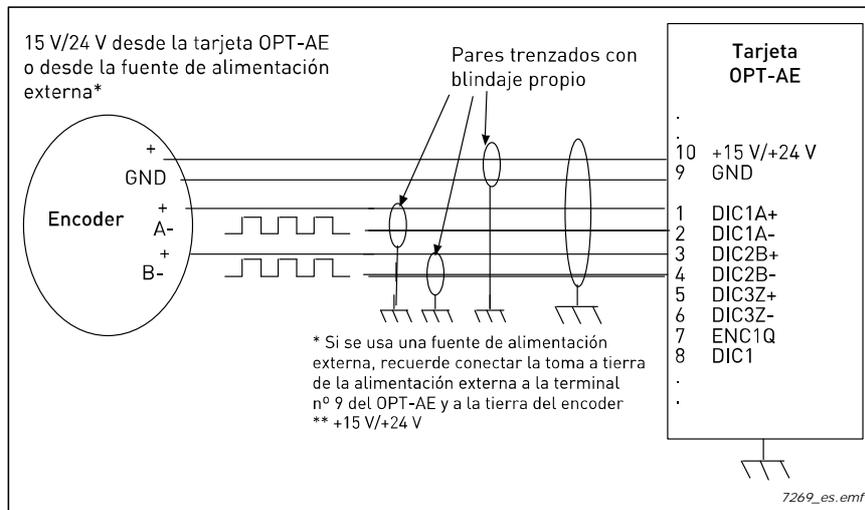
Figura 21. Conexión del encoder de tipo HTL (colector abierto) con entradas de terminación única
