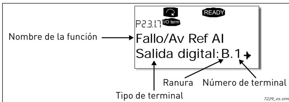
Ejemplo: Utilice la Aplicación de control de bombas y ventiladores. Desea conectar la función de salida digital "Advertencia/fallo de referencia" (parámetro 2.3.1.7) a la salida digital DO1 de la tarjeta básica OPTA1.
