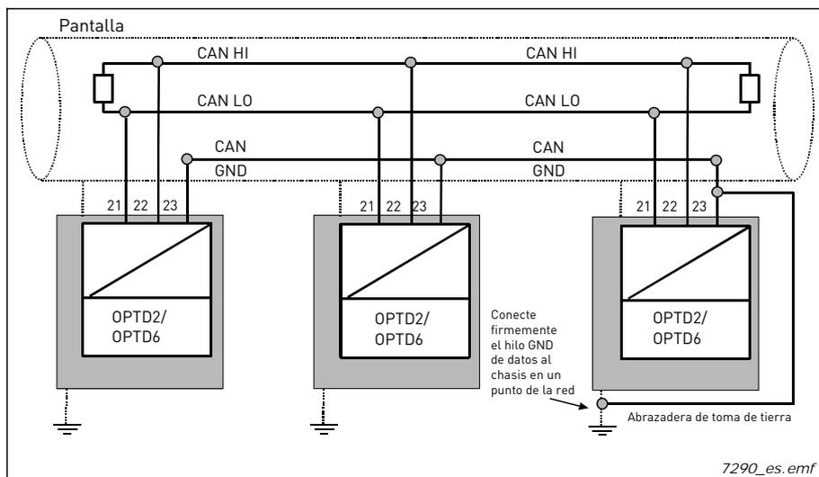
Figura 28. Conexión alternativa de la señal "CAN GND"
