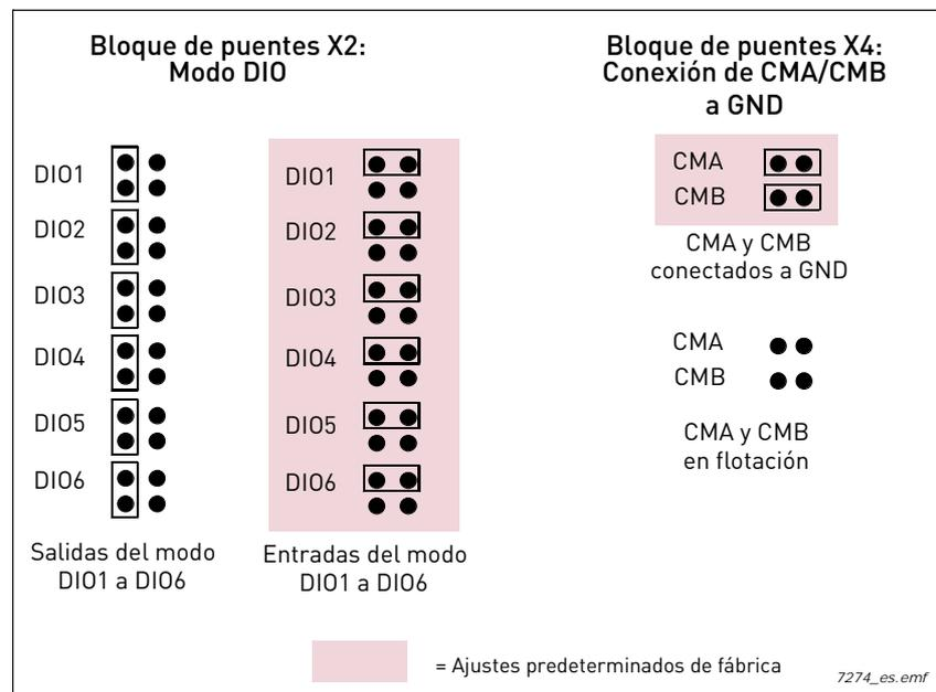
Figura 23. Posiciones de puente para OPTB1
