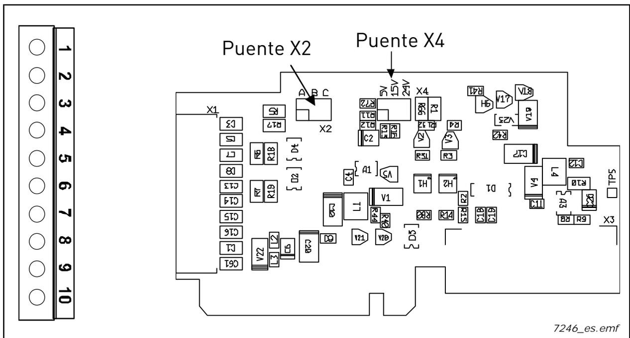
Descripción: Tarjeta de encoder para el VACON® NXP. Tarjeta de entrada de encoder con tensión de control programable para un encoder.
