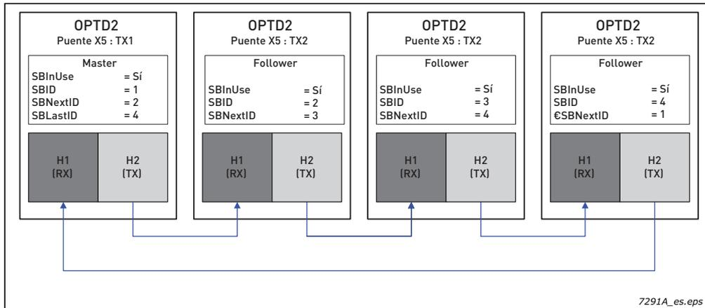
Figura 29. Ejemplo de conexión entre convertidores de frecuencia con OPTD2
