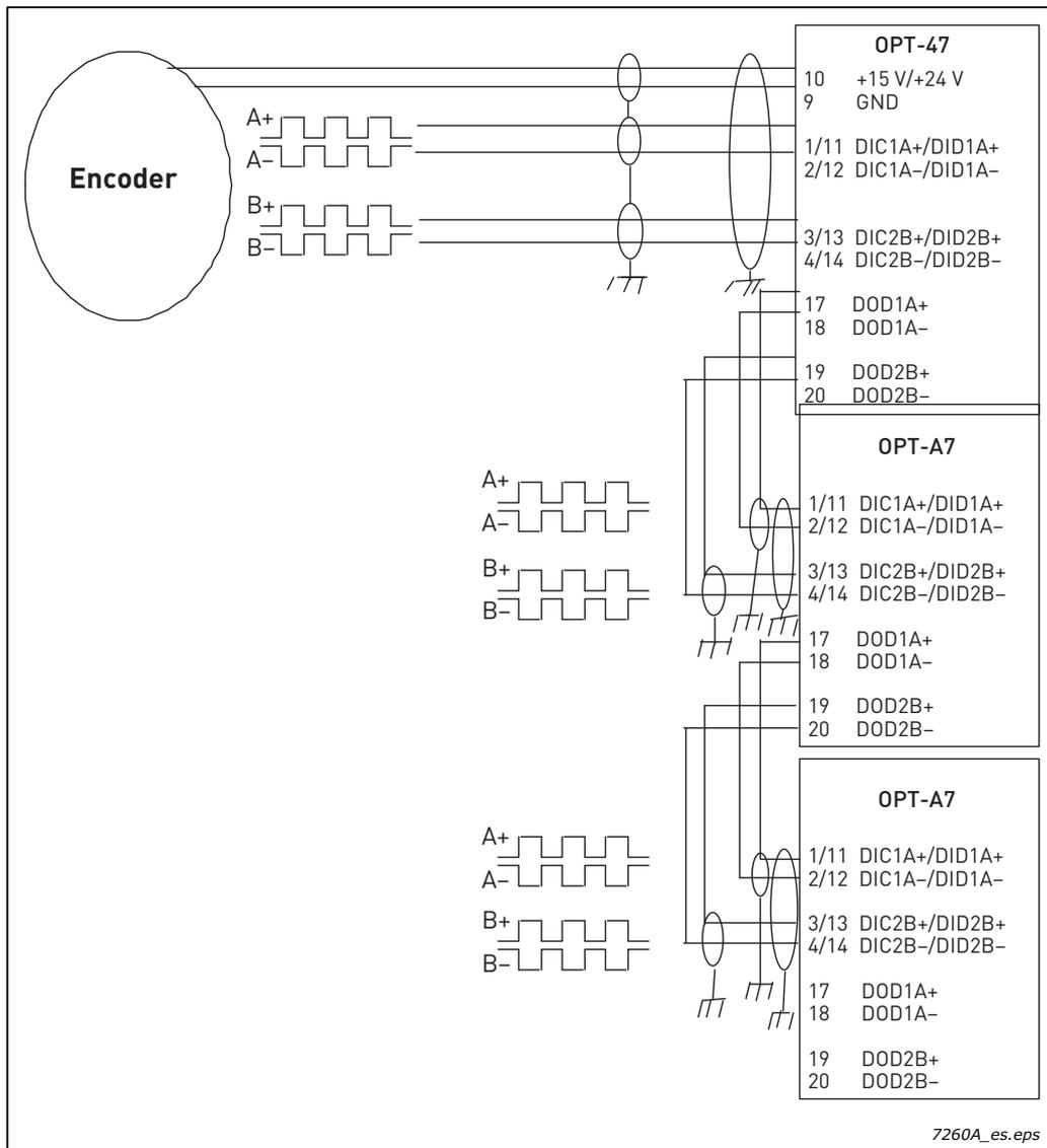
Figura 17. Conexión del encoder y tres tarjetas OPTA7
