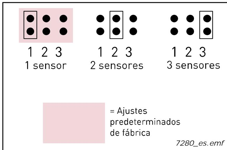
Pueden conectarse hasta tres sensores PT100 a la tercera entrada PT100. Es posible seleccionar el número de sensores que se utilizarán con el bloque de puentes X2.
