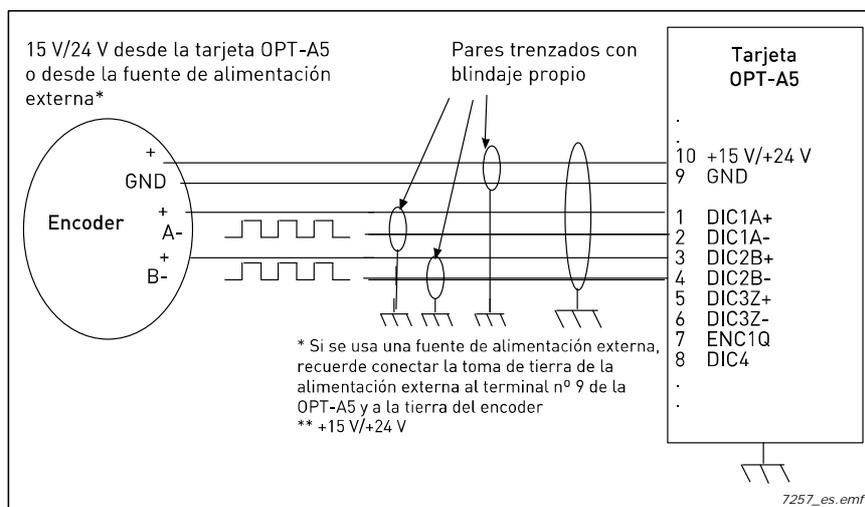
Figura 16. Conexión del encoder de tipo HTL (colector abierto) con entradas de terminación única
