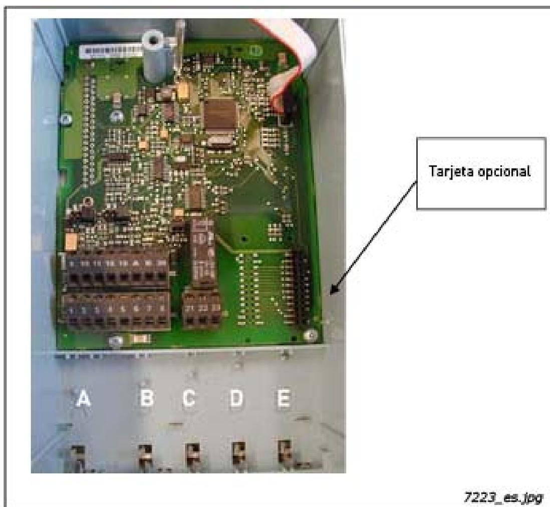
Figura 2. Ranuras en la tarjeta de control de VACON® NXL
