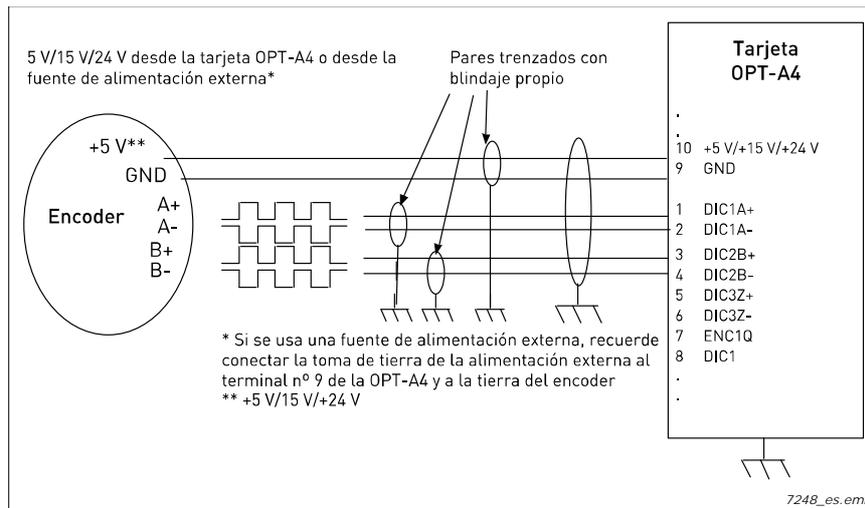
Figura 13. Conexión del encoder tipo RS-422 con entradas diferenciales
