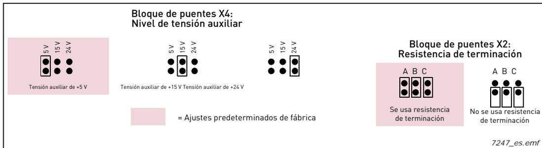
**NOTA:** Si hay un solo encoder conectado a un único convertidor, debe usarse la resistencia de terminación de la tarjeta. Si el encoder está conectado a varios convertidores, debe utilizarse la resistencia de terminación del último convertidor.
