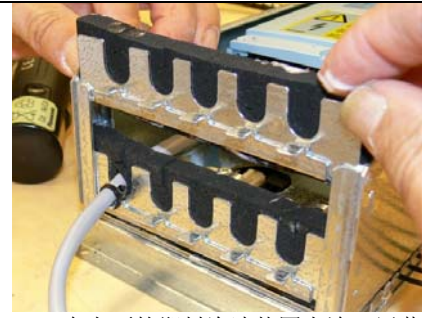
12. 在上面的塑料泡沫垫圈上涂一层薄薄的润滑油并将其固定在原位。
