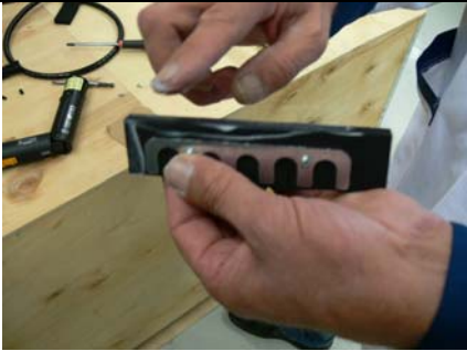
7.在泡沫塑料垫圈内涂上薄薄的一层润滑油。
