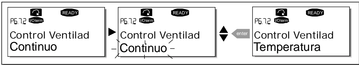
Figura 7-18. Función de control del ventilador
