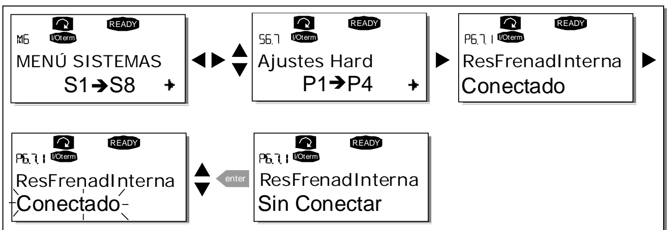
Figura 7-17. Conexión de resistencia de frenado interna
