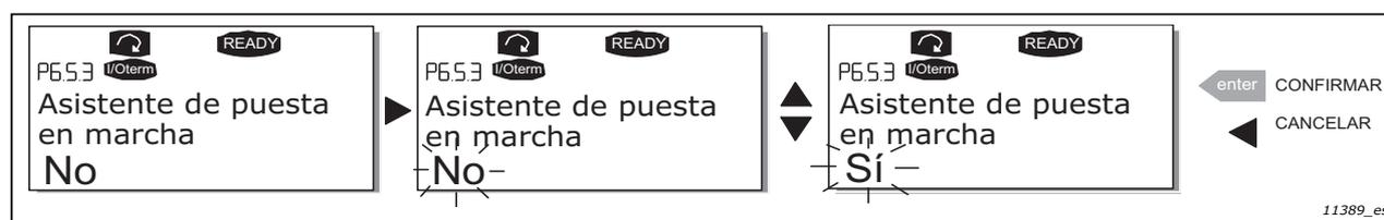
Figura 75. Activación del asistente de puesta en marcha
