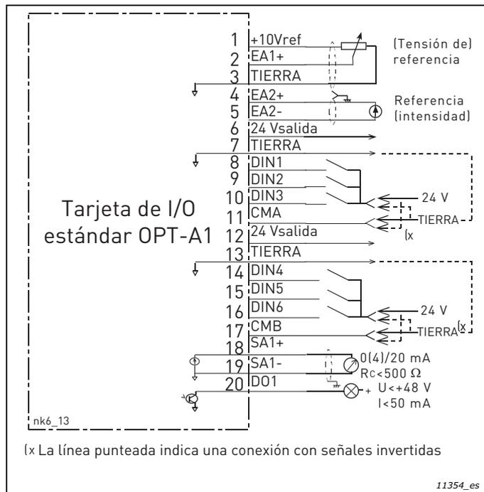
Figura 46. Diagrama de cableado general de la tarjeta de I/O estándar (OPT-A1)
