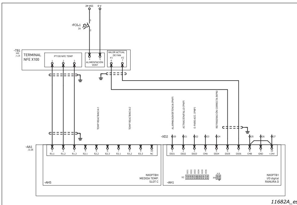
Figura 102. Diagrama de cableado de los controles, OPTBH, OPTB1
