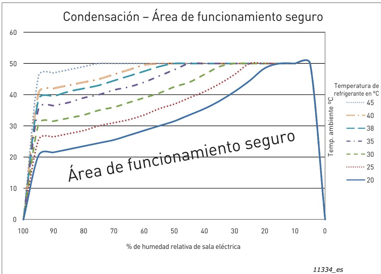
Figura 26. Condiciones de funcionamiento seguras en relación con la condensación
