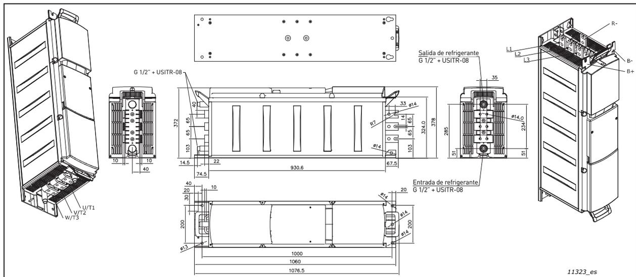
Figura 15. Convertidor de frecuencia de refrigeración líquida VACON® (6 pulsos) con chopper de frenado interno
