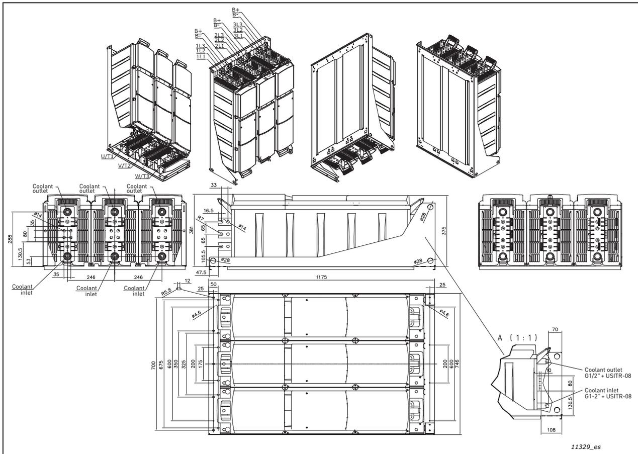
Figura 21. Dimensiones del convertidor de frecuencia de refrigeración líquida VACON® NX (6 pulsos), CH74, IP00 (tipo abierto UL)
