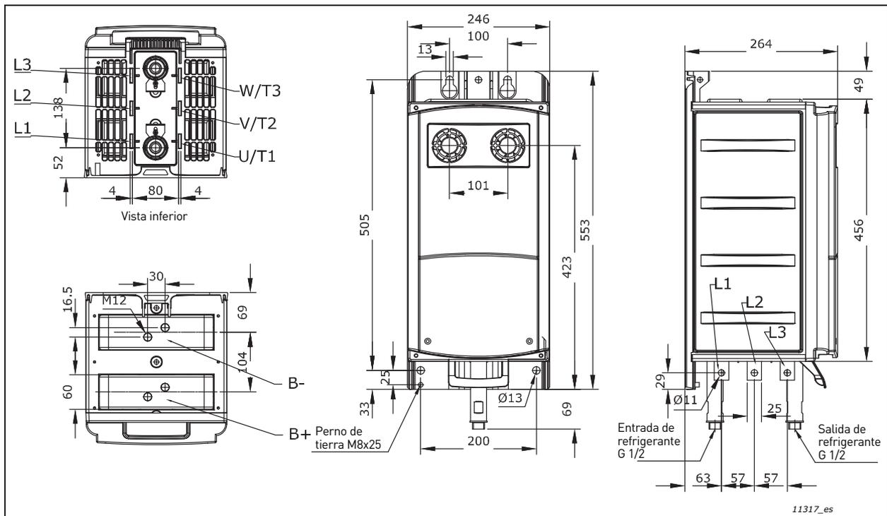
Figura 9. Dimensiones del VACON® NX de refrigeración líquida, convertidor de frecuencia CH5
