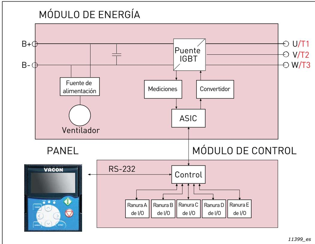
Figura 88. Diagrama de bloque de la unidad Active Front End
