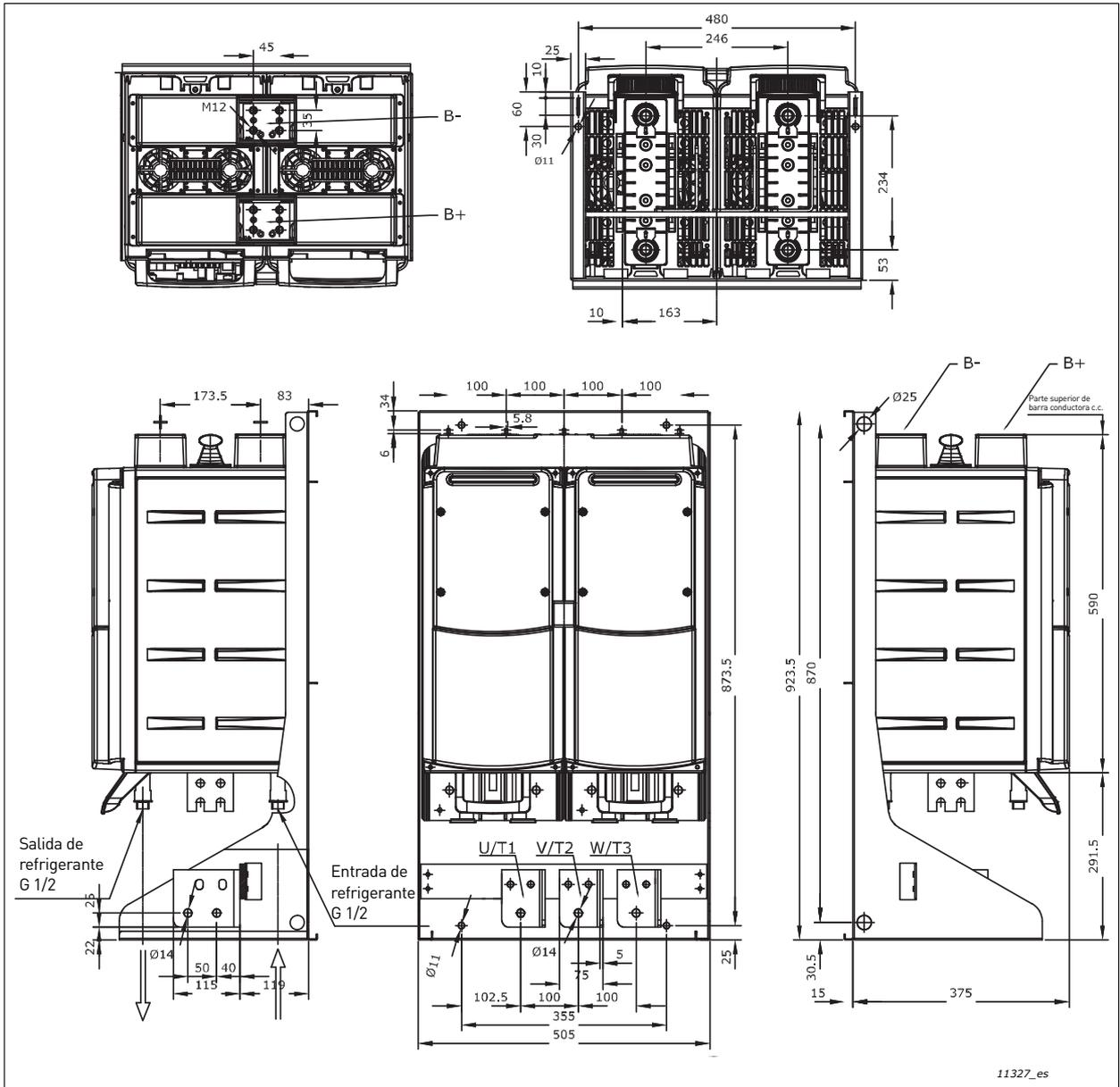
Figura 19. Inversor de refrigeración líquida VACON® con soporte de montaje, CH63
