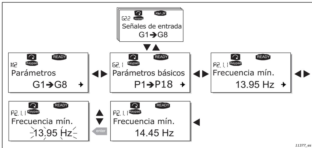
Figura 66. Procedimiento para cambiar el valor de los parámetros
