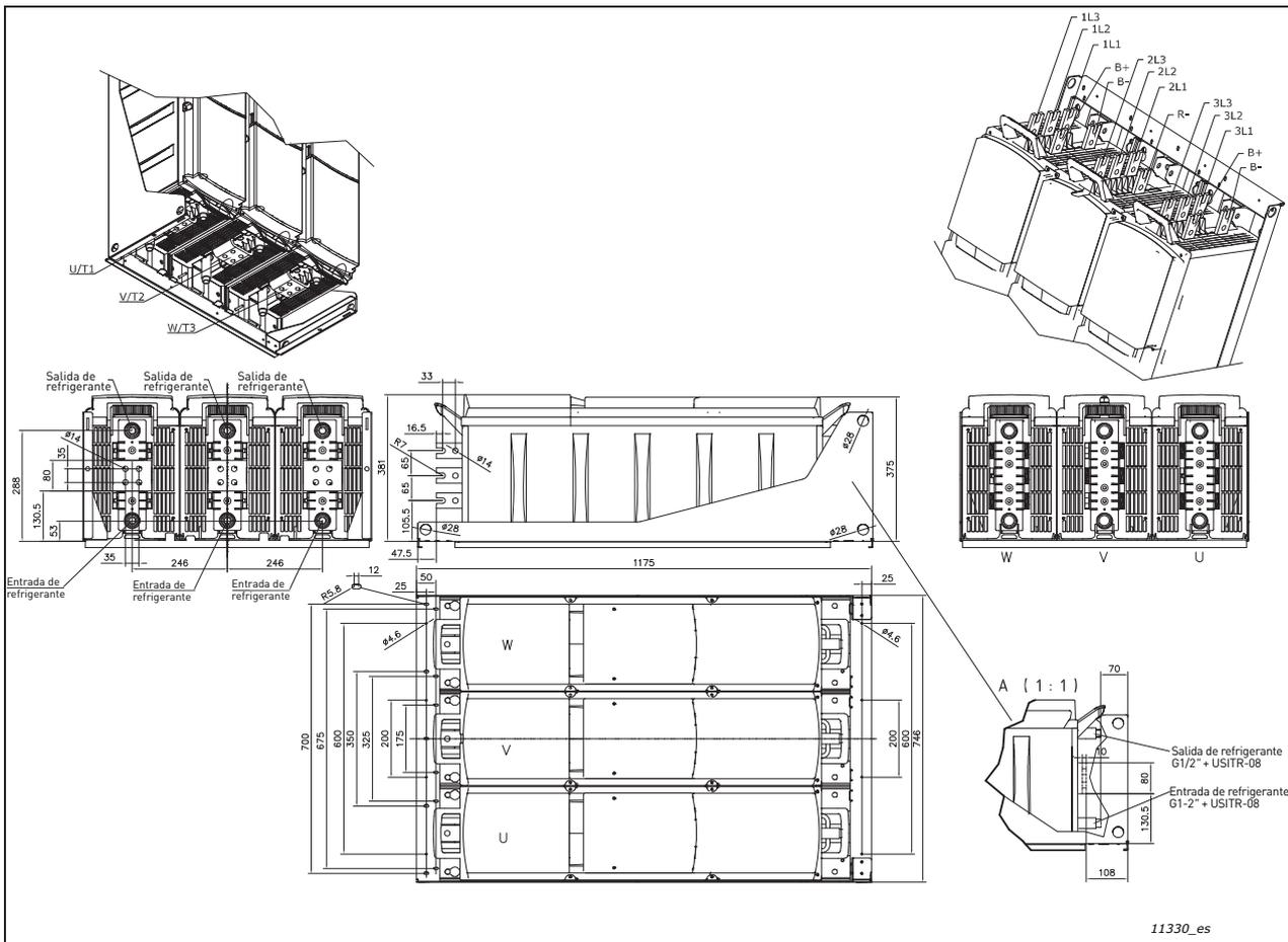
Figura 22. Dimensiones del convertidor de frecuencia de refrigeración líquida VACON<sup>®</sup> NX (6 pulsos) con chopper de frenado interno, CH74, IP00 (tipo abierto UL)
