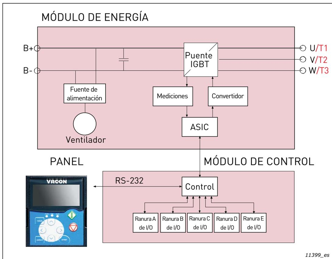
Figura 108. Diagrama de bloque de BCU
