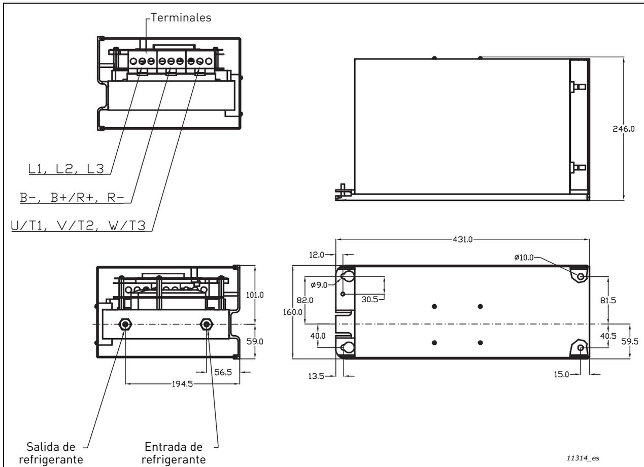
Figura 6. Dimensiones del convertidor de refrigeración líquida VACON® NX, CH3
