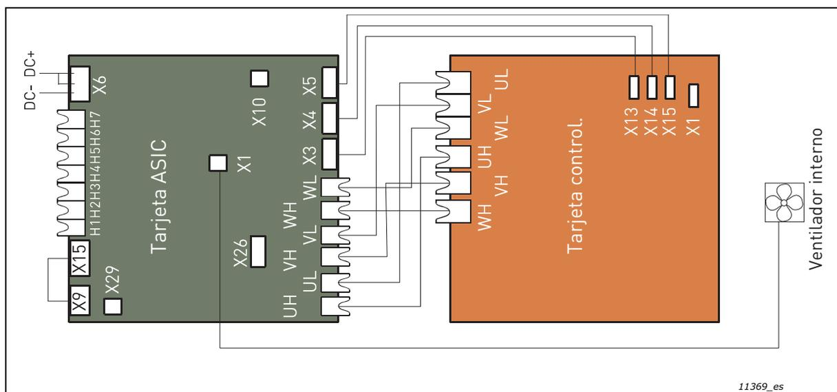
Figura 54. Terminales y conexiones entre ASIC y la tarjeta de controladores (CH61, CH62 y CH72)
