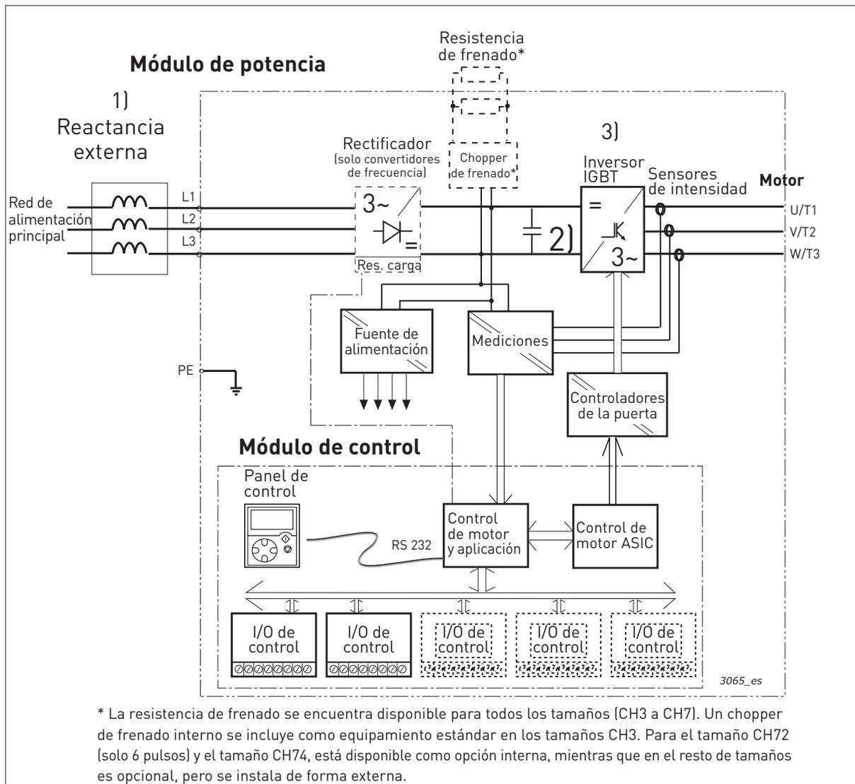
Figura 1. Diagrama de bloques principal del convertidor de frecuencia de refrigeración líquida VACON® NX
