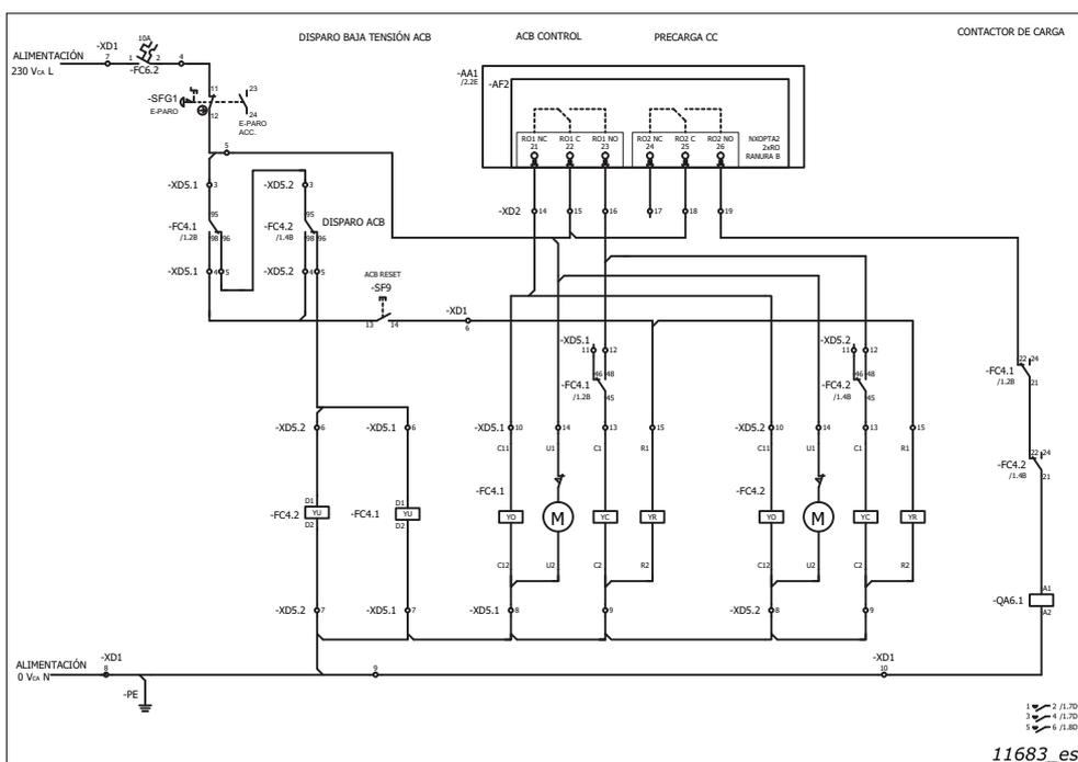
Figura 103. Diagrama de cableado de los controles, OPTA2
