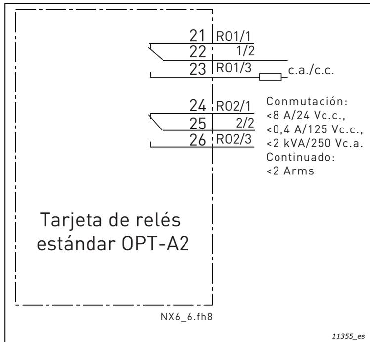
Figura 47. Diagrama de cableado general de la tarjeta de relés estándar (OPT-A2)
