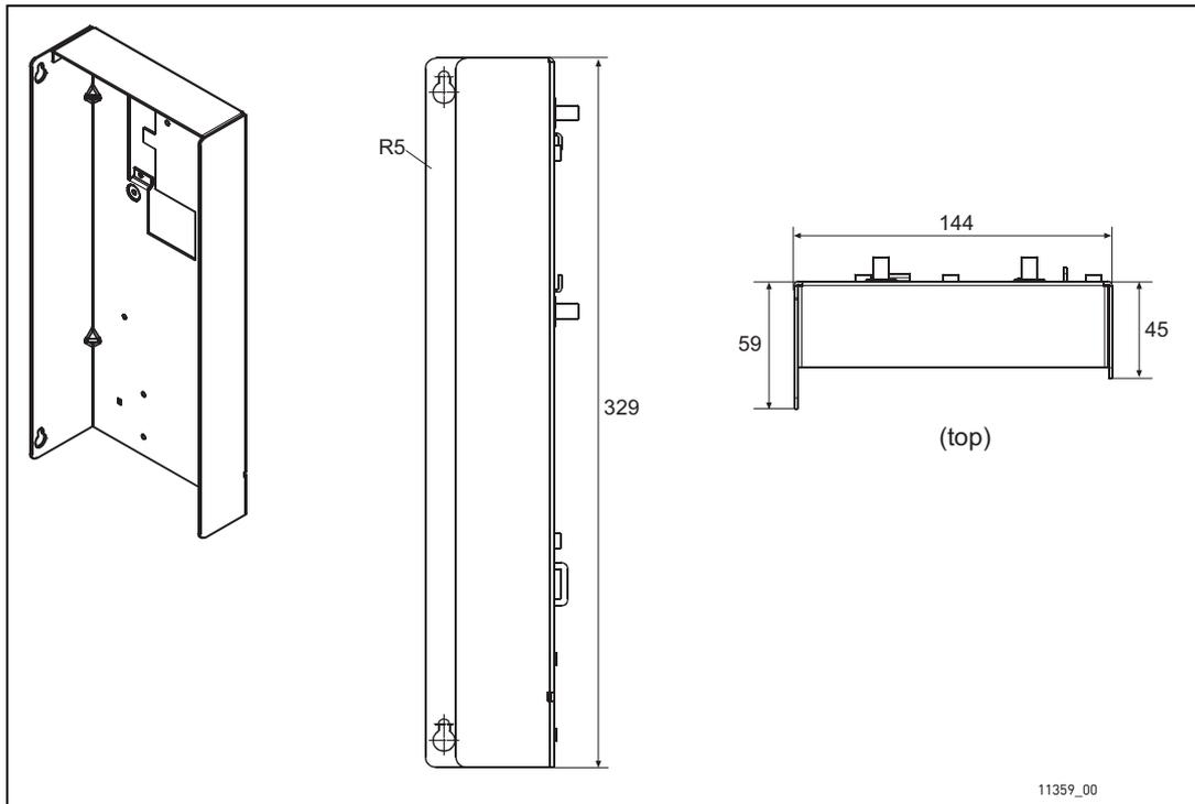
Figura 52. Dimensiones de la caja de montaje de la unidad de control
