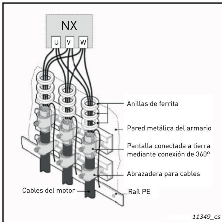
Figura 42. Instalación de anillas de ferrita
