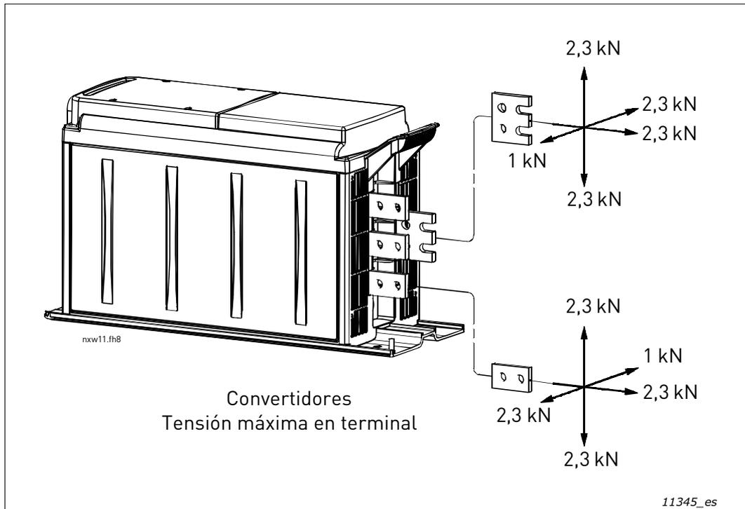
Figura 39. Tensiones máximas en terminal
