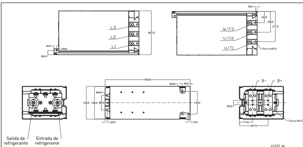
Figura 7. Dimensiones de la unidad de refrigeración líquida VACON® NX (convertidor de frecuencia), CH4
