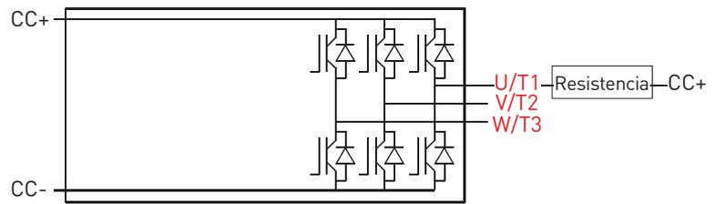
NXB (unidad de chopper de frenado) + dos resistencias = una unidad de control de potencia de frenado. La energía no necesaria se quema
