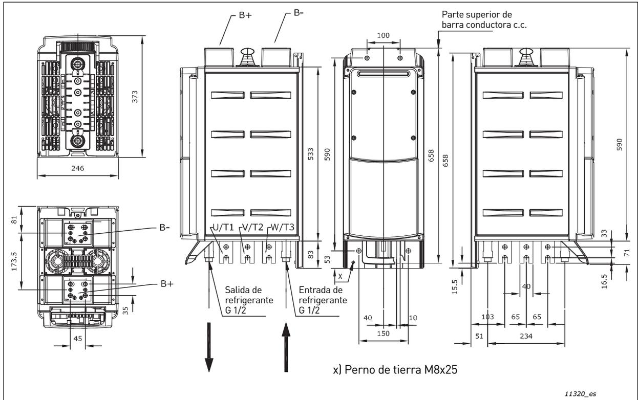
Figura 12. Inversor de refrigeración líquida VACON<sup>®</sup>, CH61
