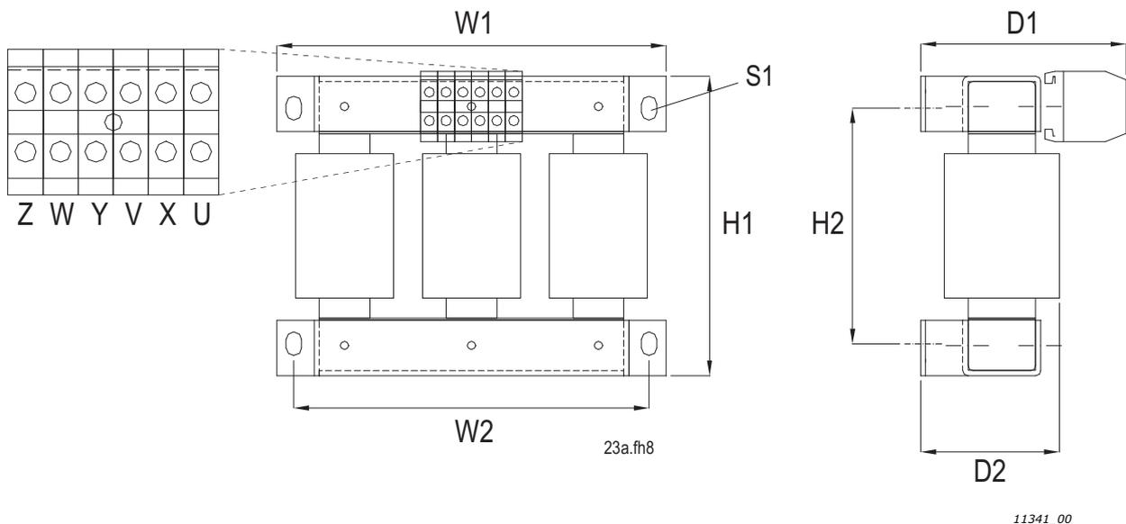
Figura 35. Ejemplo de reactancias de entrada de refrigeración por aire para convertidores VACON® de refrigeración líquida. Tamaños de hasta 62 A
