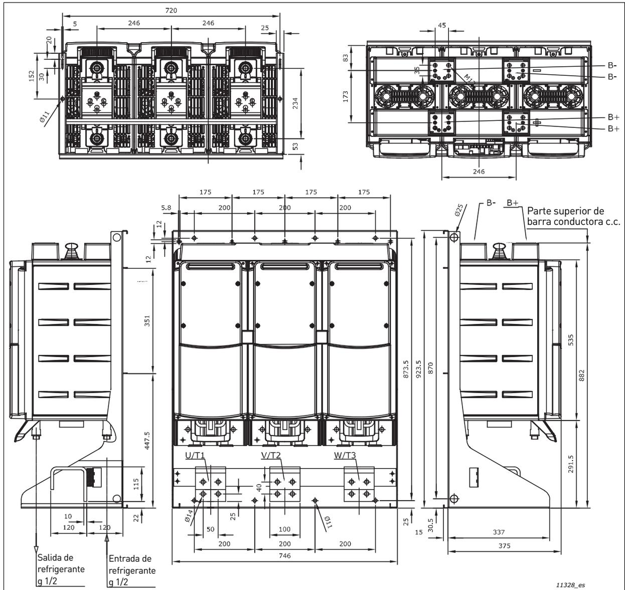
Figura 20. Dimensiones del inversor de refrigeración líquida VACON® NX, CH64, IP00 (tipo abierto UL)
