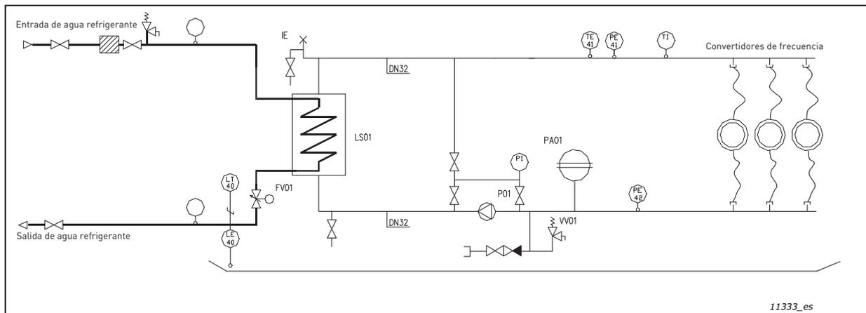
Figura 25. Ejemplo: Diagrama PI del sistema de refrigeración y las conexiones
