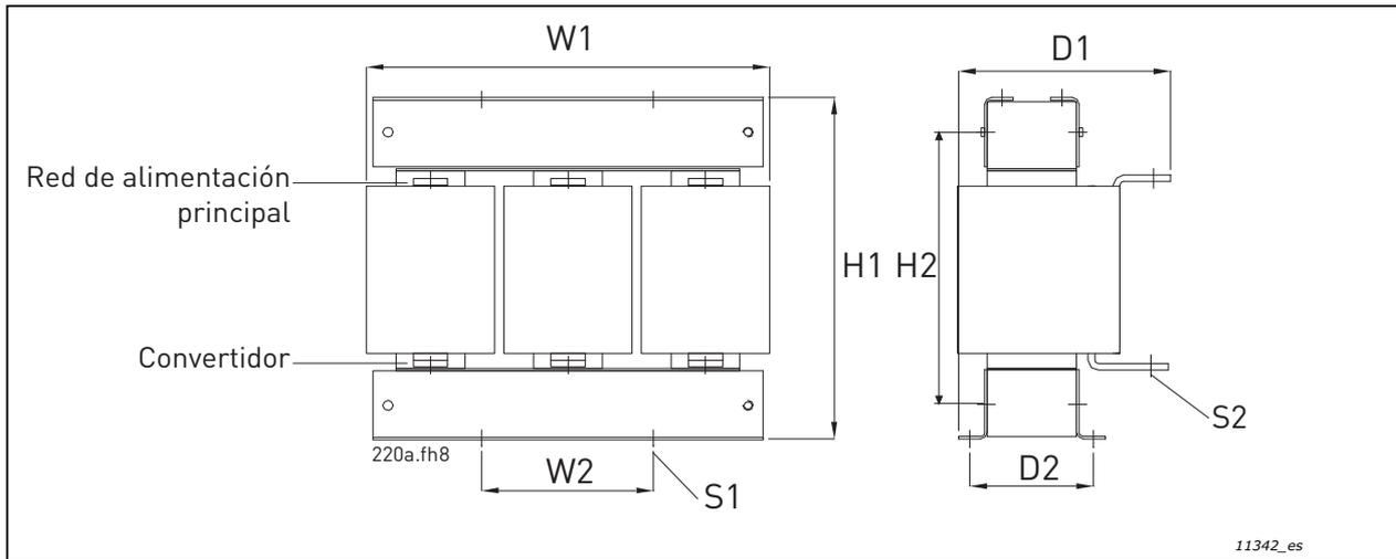
Figura 36. Ejemplo de reactancias de entrada de refrigeración por aire para convertidores VACON® de refrigeración líquida. Tamaños de 87 A...145 A y 590 A
