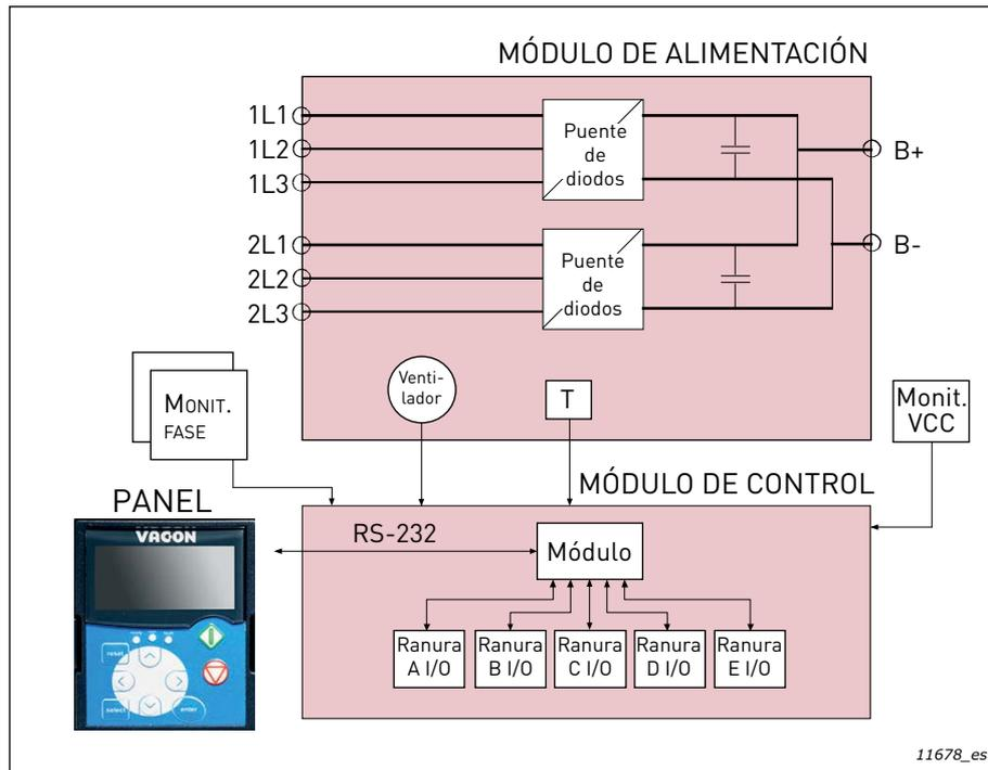
Figura 104. Diagrama de bloques del front end no regenerativo
