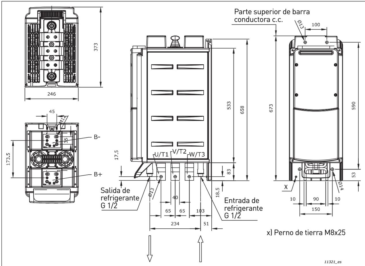
Figura 13. Inversor de refrigeración líquida VACON<sup>®</sup>, CH62
