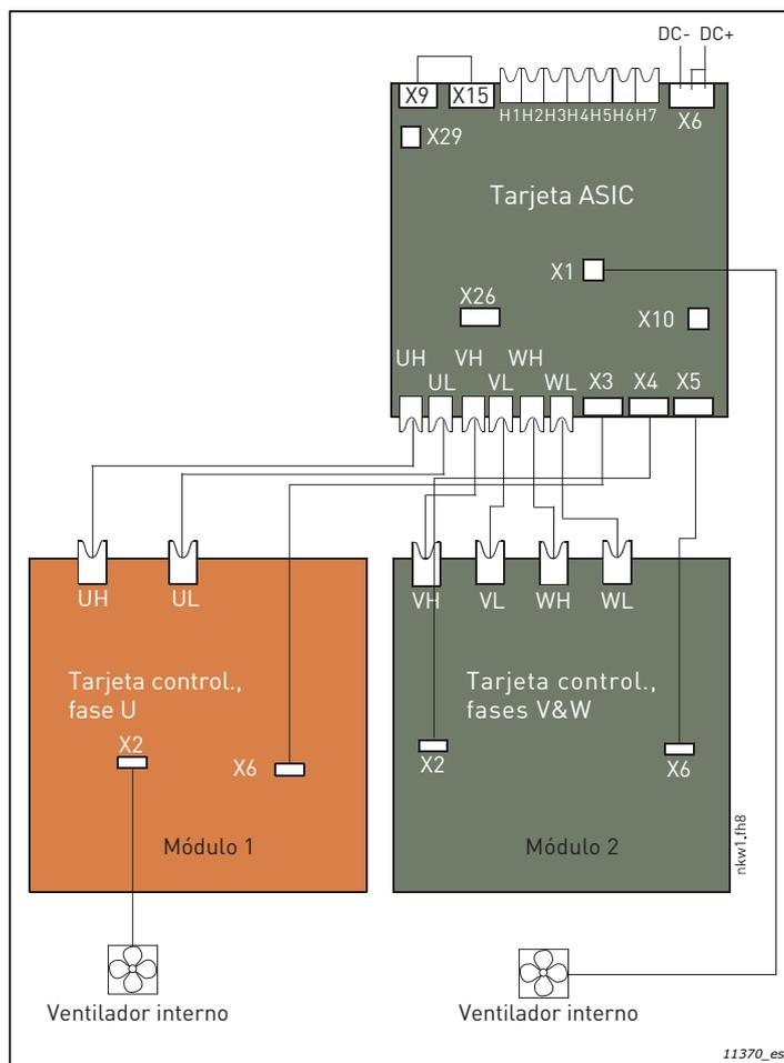
Figura 55. Terminales y conexiones entre ASIC y las tarjetas de controladores (CH63)
