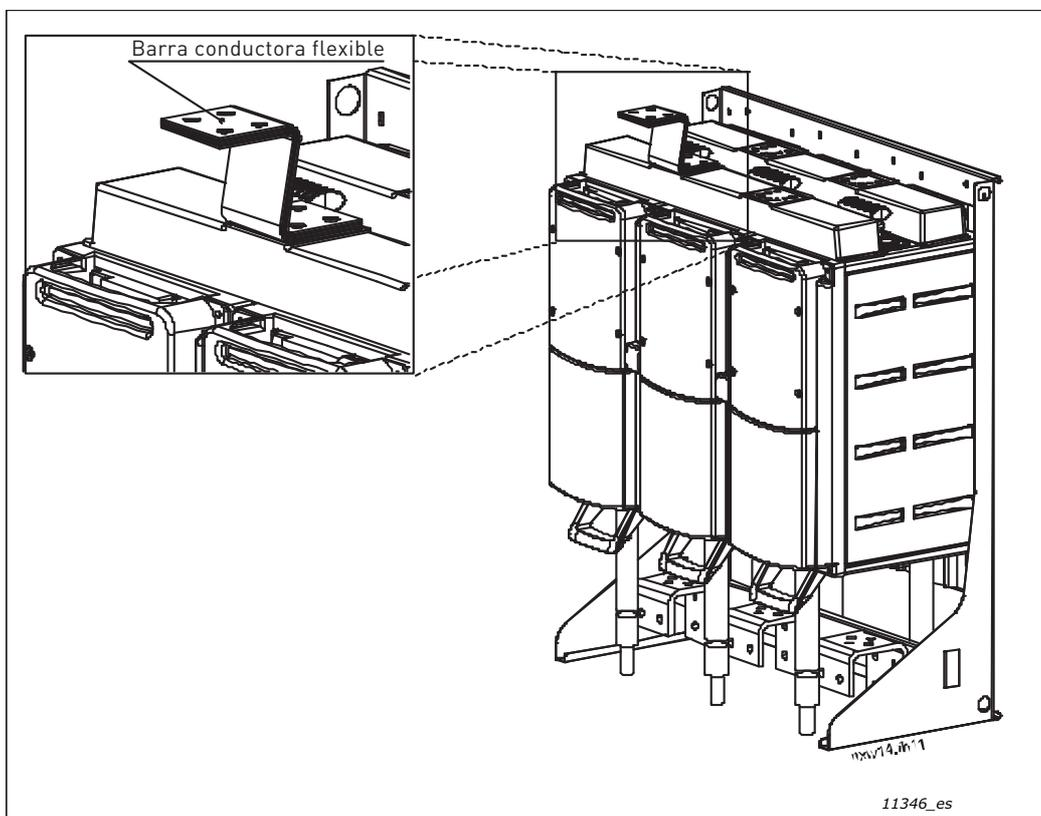
Figura 40. Montaje de la barra conductora flexible
