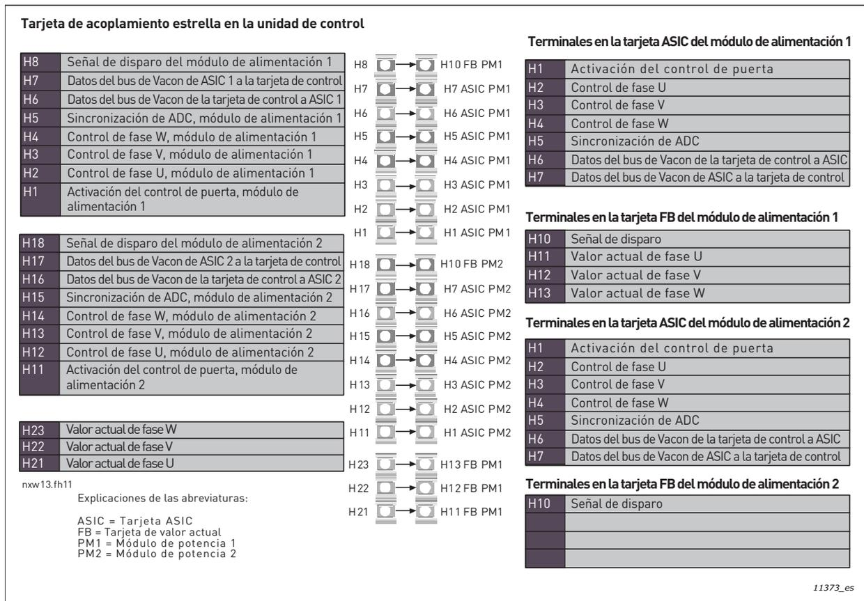
Figura 61. Terminales y conexiones entre la tarjeta de acoplamiento estrella, las tarjetas ASIC y las tarjetas de valor actual (CH64 y CH74)
