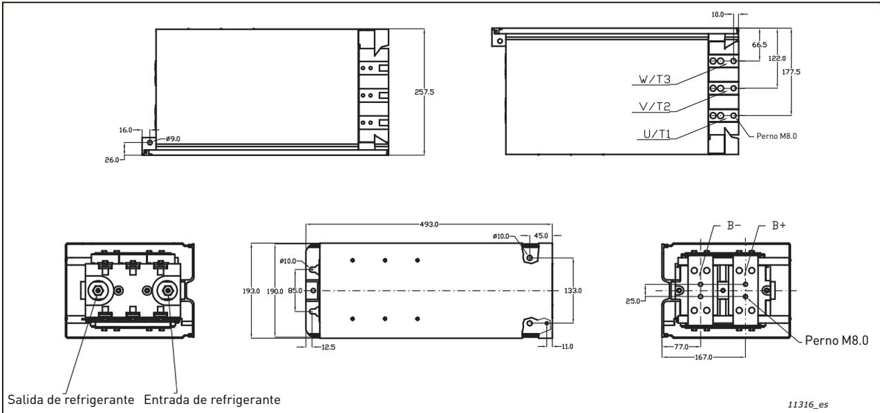
Figura 8. Dimensiones de la unidad de refrigeración líquida VACON® NX (inversor), CH4
