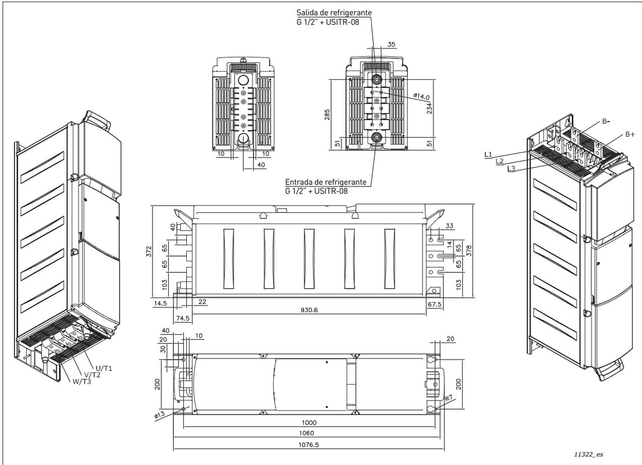
Figura 14. Convertidor de frecuencia de refrigeración líquida VACON® (6 pulsos), CH72
