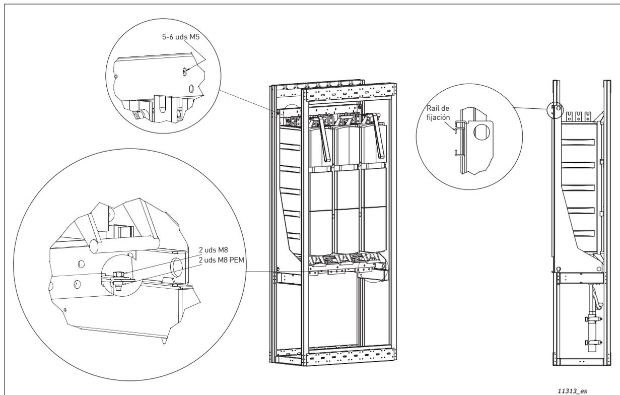
Figura 5. Fijación del convertidor al bastidor del armario
