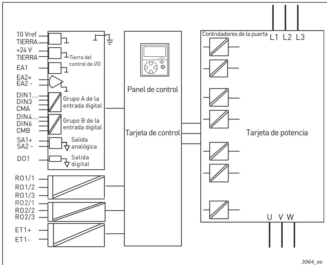
Figura 48. Barreras de aislamiento galvánico
