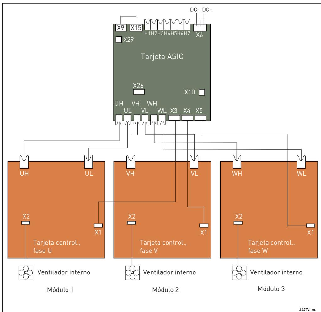
Figura 56. Terminales y conexiones entre ASIC y las tarjetas de controladores (CH64 y CH74)
