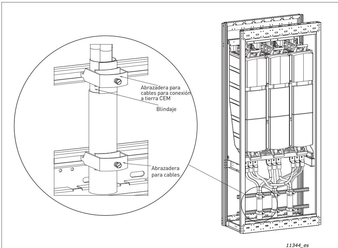
Figura 38. Sujete los cables del motor al bastidor del armario
