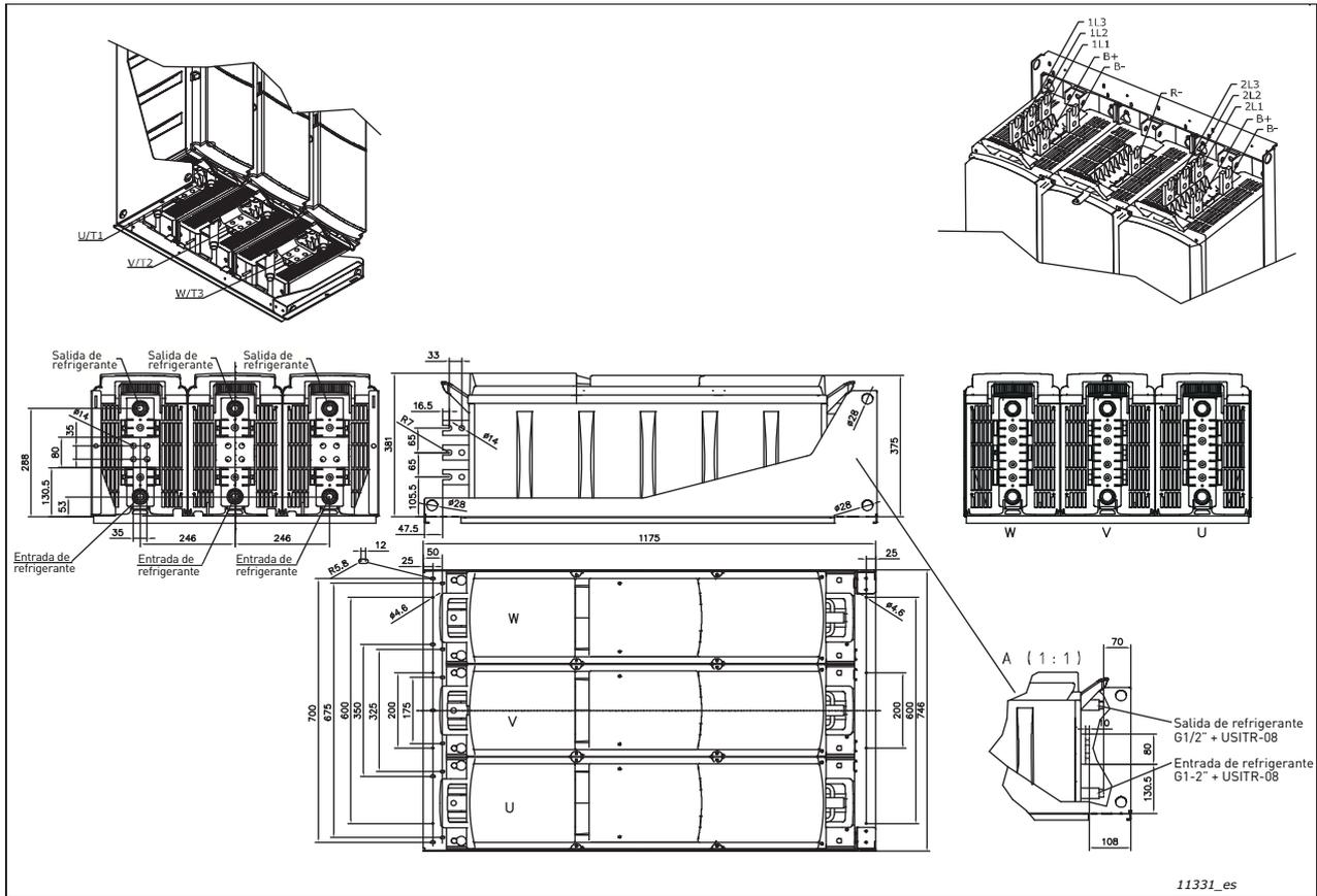
Figura 23. Dimensiones del convertidor de frecuencia de refrigeración líquida VACON® NX (12 pulsos) con chopper de frenado interno, CH74, IP00 (tipo abierto UL)
