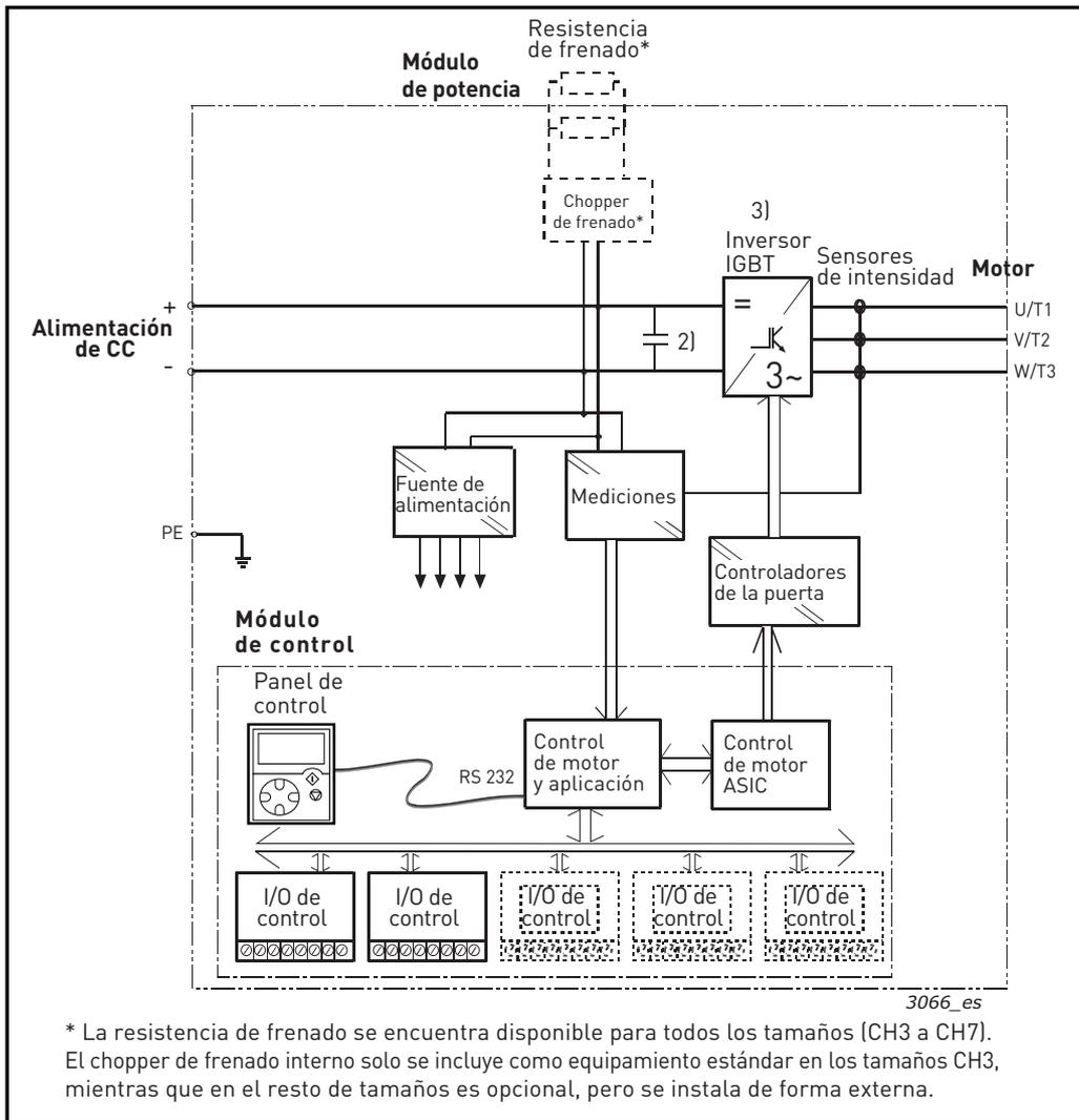
Figura 2. Diagrama de bloques principal del inversor de refrigeración líquida VACON® NX
