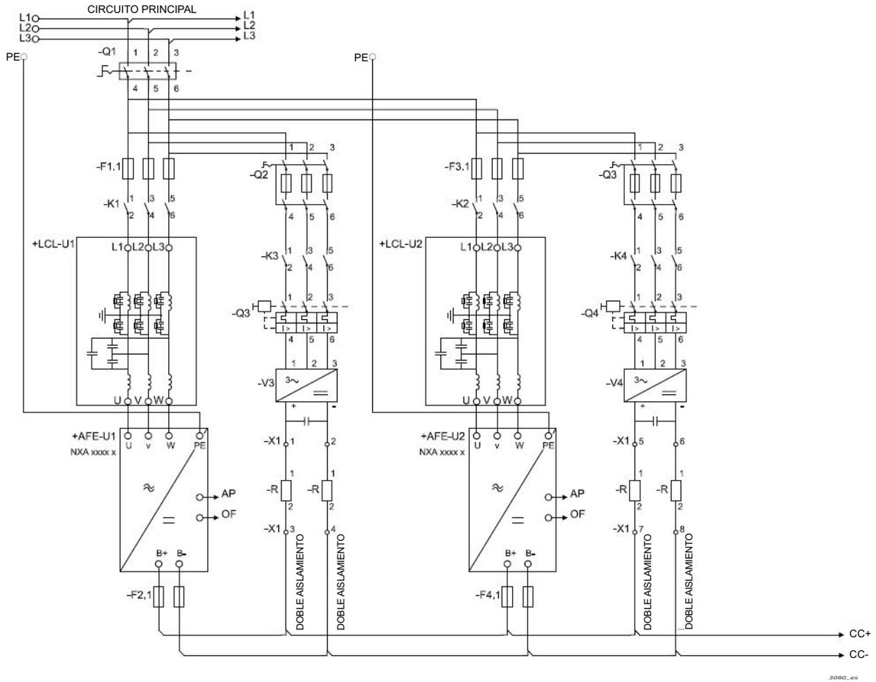
Figura 99. Conexión de unidades Active Front End en paralelo con sus propios circuitos de precarga
