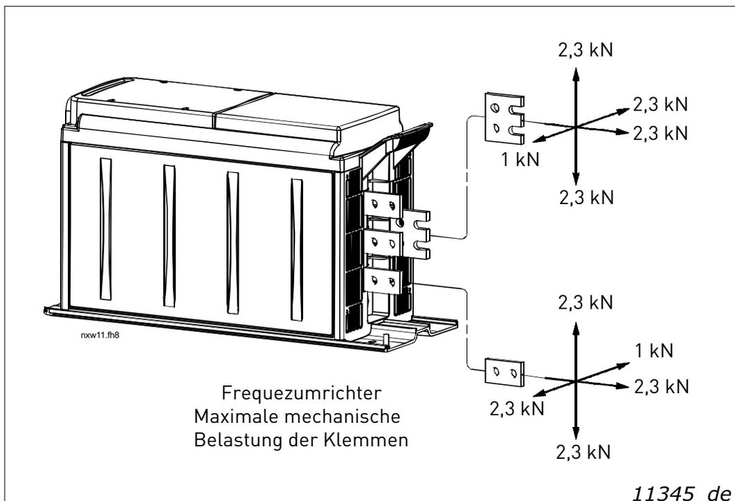
Abbildung 39. Maximale mechanische Belastung der Klemmen
