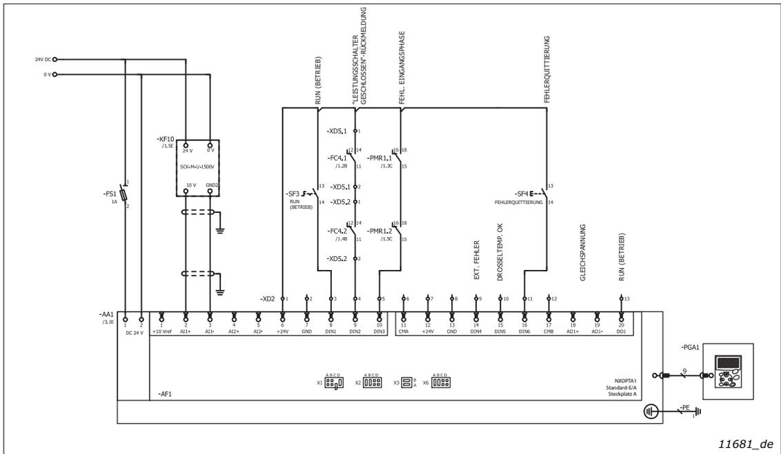
Abbildung 101. Anschlussschema für Steuerungen, OPTA1.
