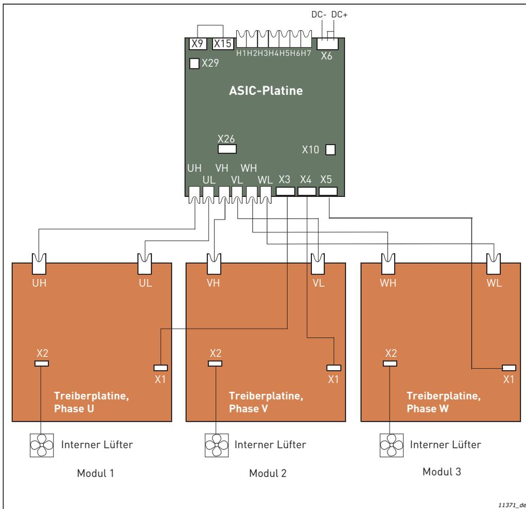
Abbildung 56. Klemmen und Anschlüsse zwischen ASIC- und Treiberplatten (CH64 und CH74)
