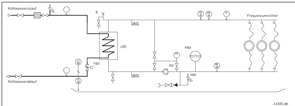
Abbildung 25. Beispiel: PI-Diagramm des Kühlsystems und der Anschlüsse
