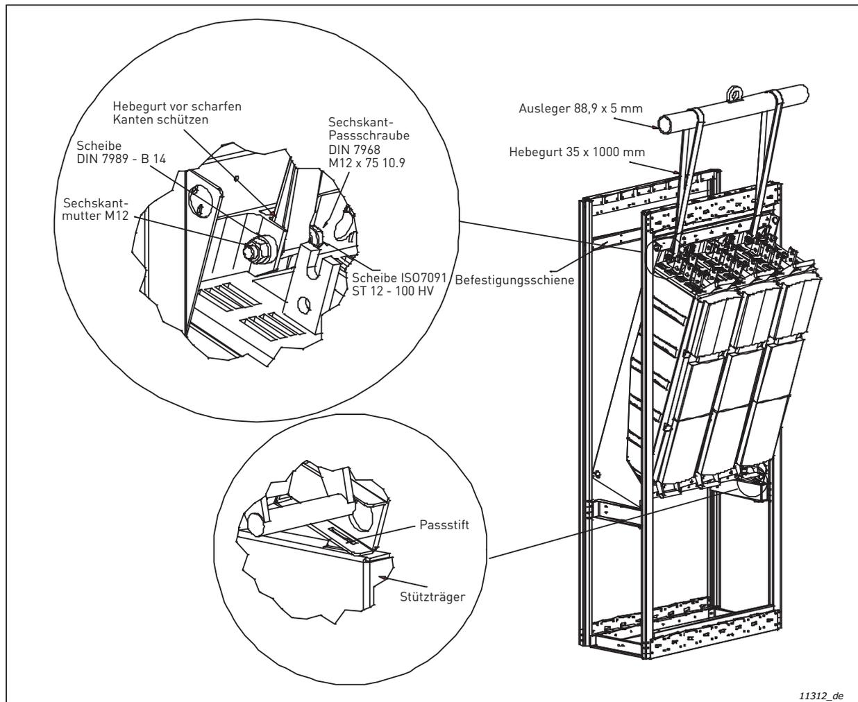
Abbildung 4. Heben des Antriebs in eine schmale Einbauposition
