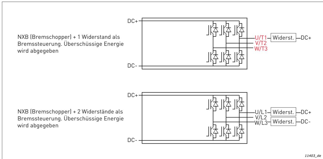
Abbildung 109. Topologie eines Bremschoppers
