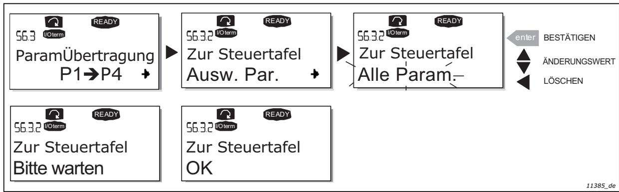
Abbildung 73. Kopieren von Parametern in die Steuertafel
