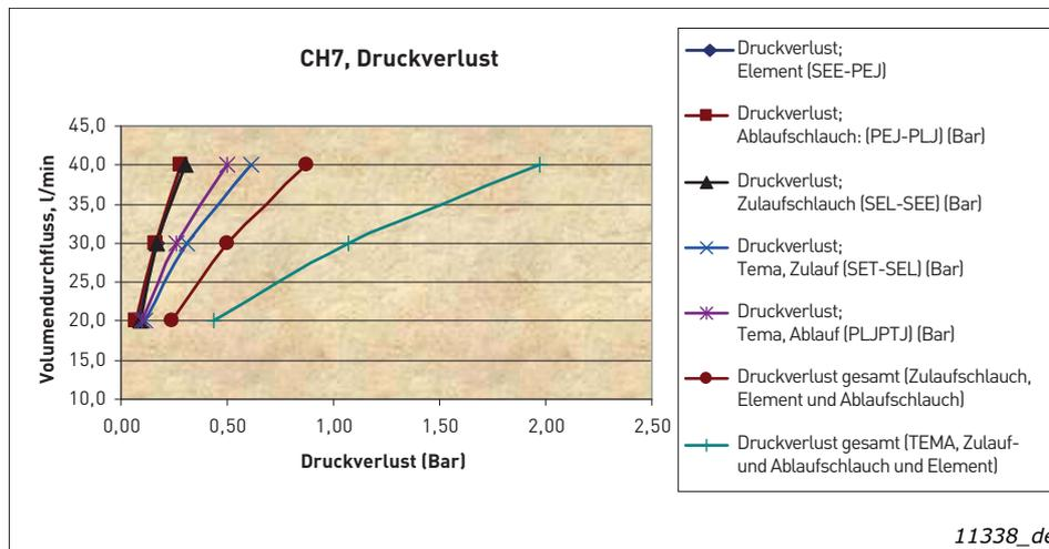
Abbildung 30. Druckverlust; CH7x
