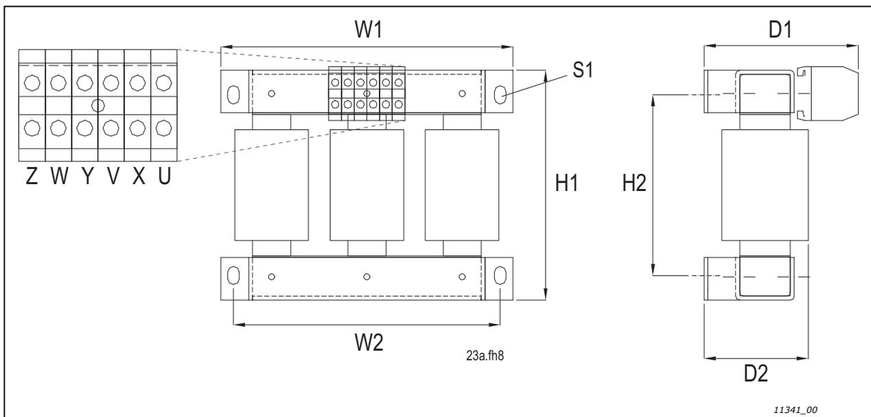
Abbildung 35. Beispiel für luftgekühlte Eingangsdroseln für flüssiggekühlte VACON® NX-Frequenzumrichter. Größen bis 62 A
