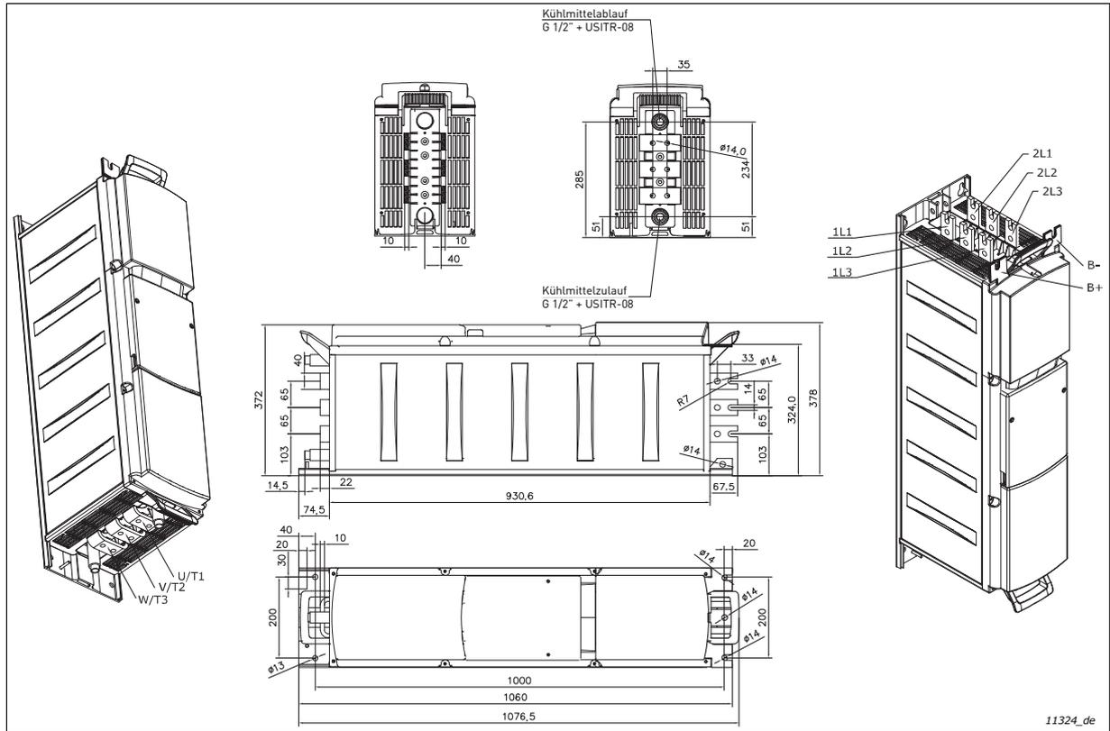
Abbildung 16. Flüssiggekühlter VACON<sup>®</sup>-Frequenzumrichter (12-pulsig) (CH72)
