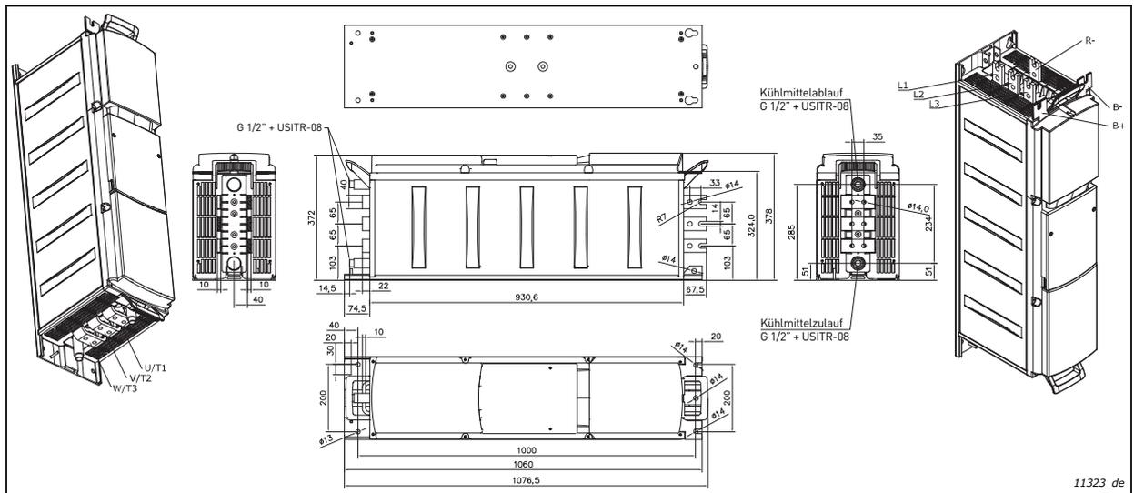
Abbildung 15. Flüssiggekühlter VACON®-Frequenzumrichter (6-pulsig) mit integriertem Bremschopper
