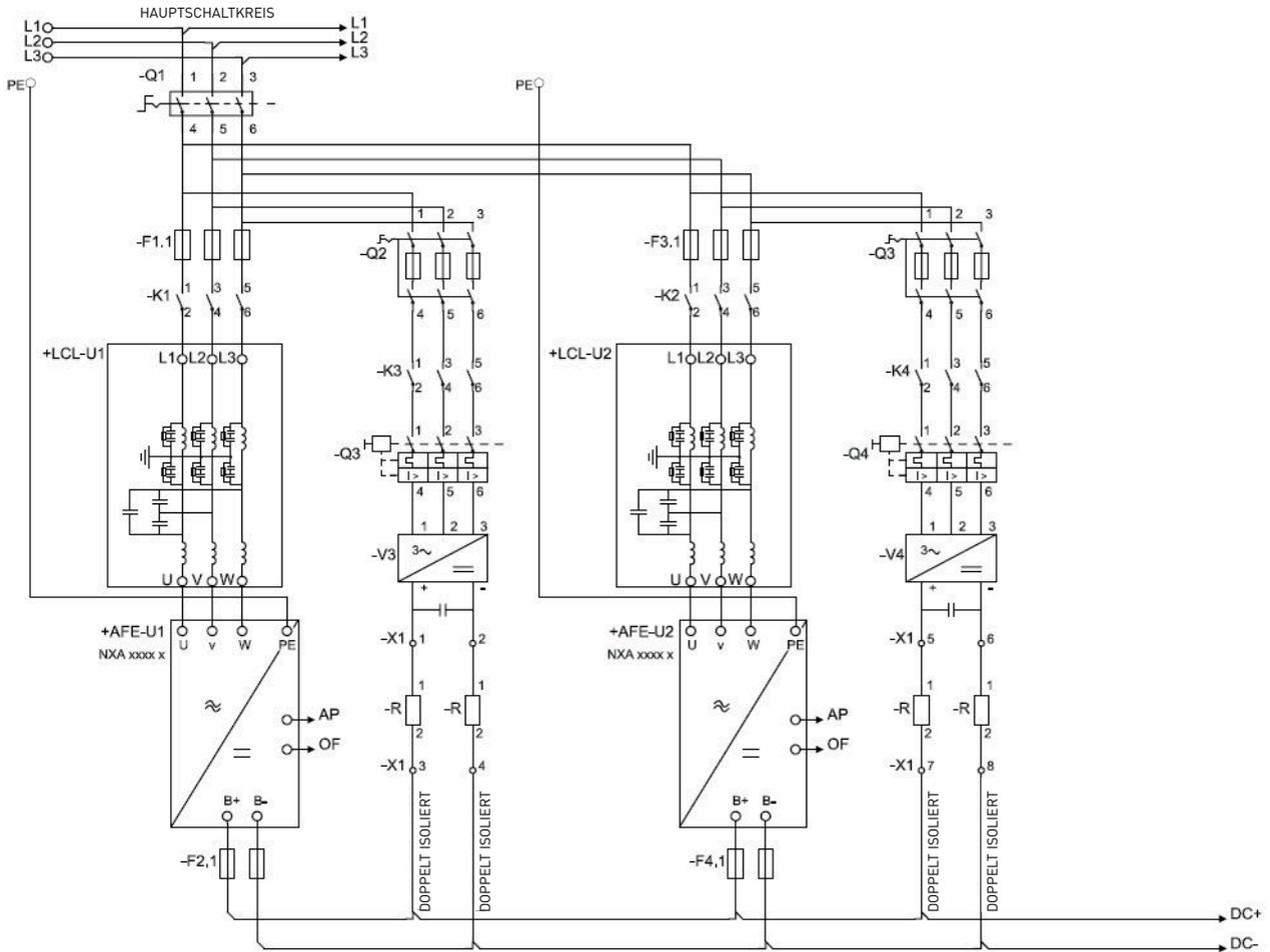
Abbildung 99. Parallelschaltung von Active-Front-End-Geräten mit eigenen Vorladeschaltungen
