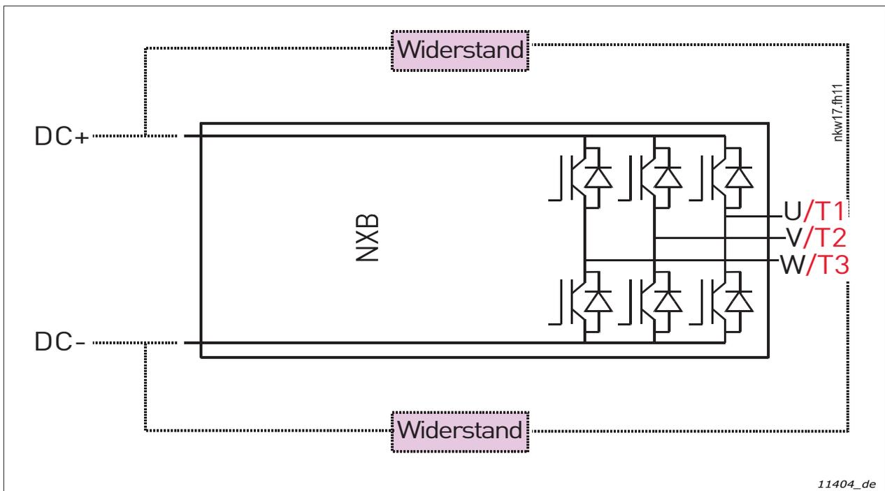
Abbildung 110. Anschlüsse eines VACON®-Bremschoppers
