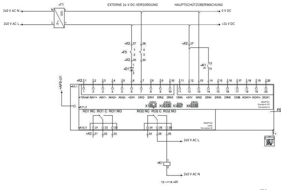
Abbildung 97. Anschlussschema für Steuereinheit
