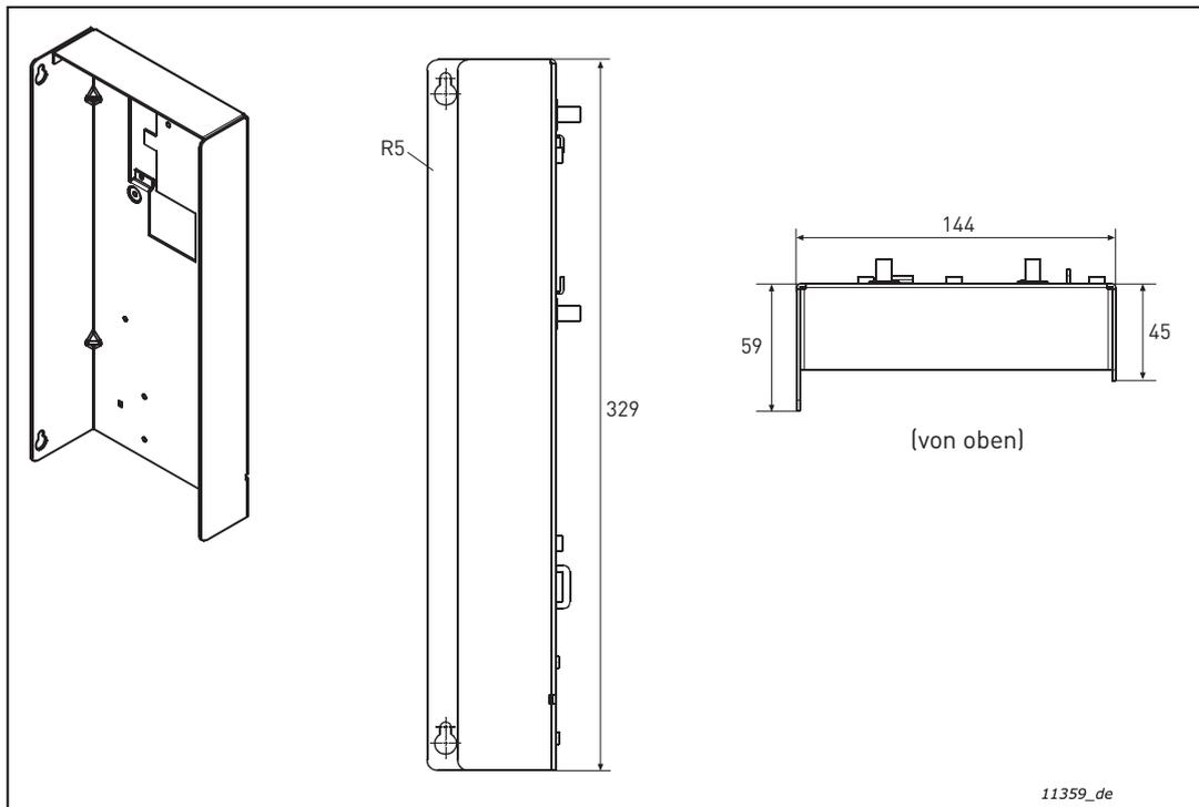
Abbildung 52. Abmessungen der Montagebox für die Steuereinheit
