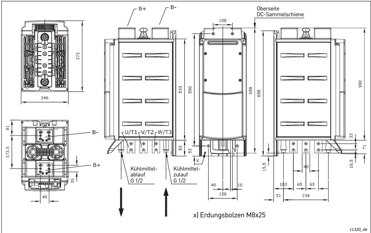
Abbildung 12. Flüssiggekühlter VACON®-Wechselrichter (CH61)
