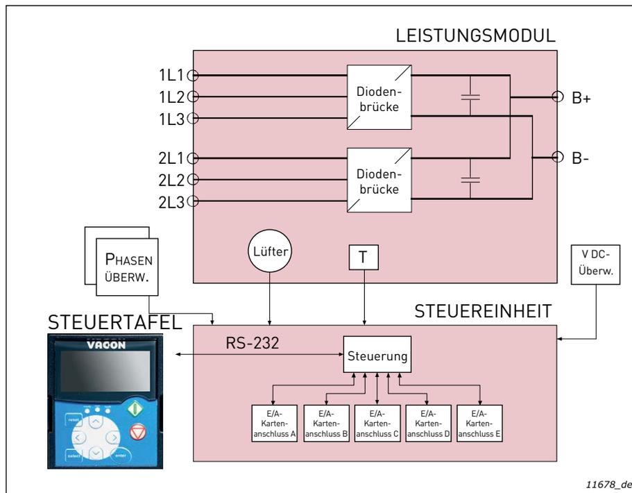
Abbildung 104. Blockschaltbild für das nicht rückspeisefähige Front End
