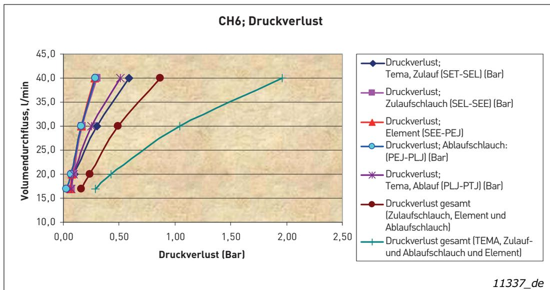
Abbildung 29. Druckverlust; CH6x
