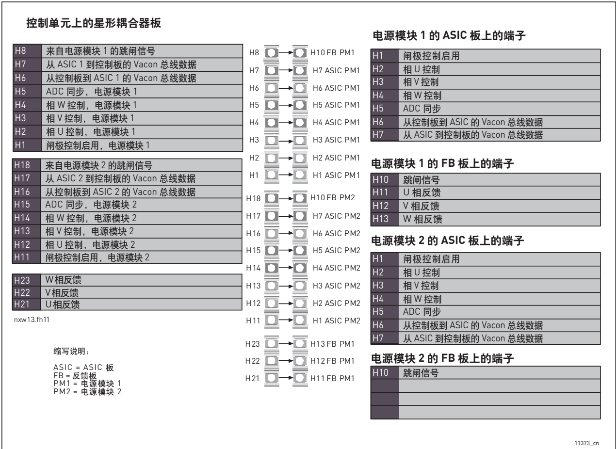
图 61. 星形耦合器板、ASIC 板和反馈板 ( CH64 和 CH74 ) 之间的端子和连接
