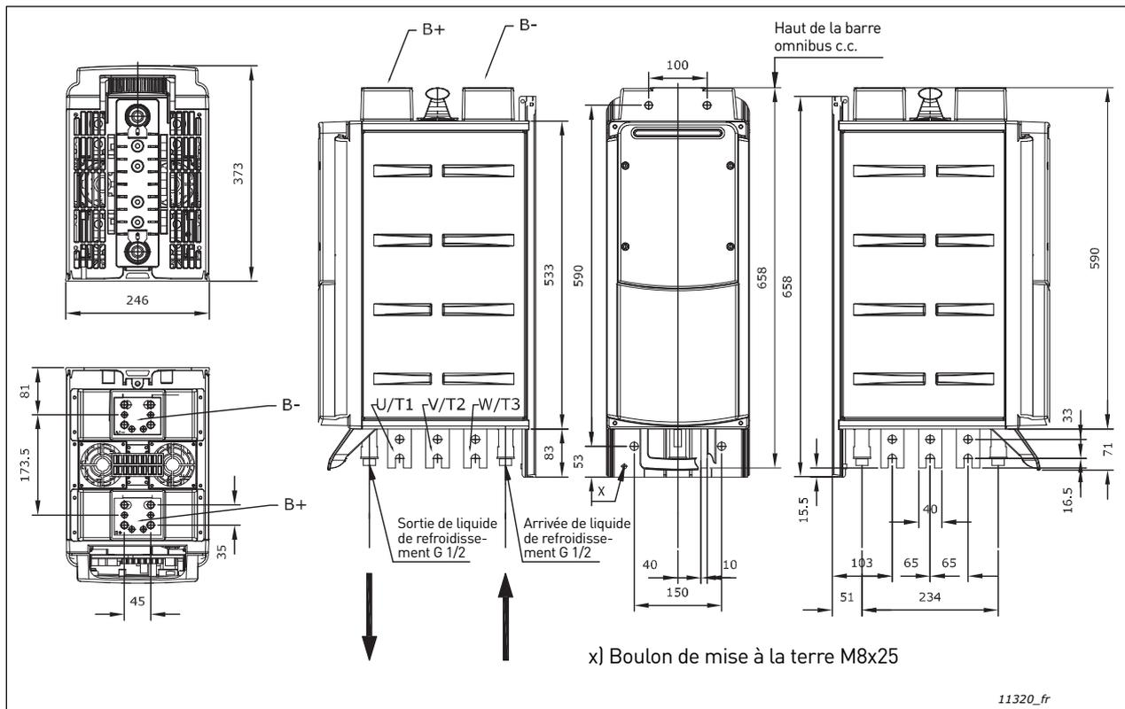
Figure 12. Onduleur VACON® refroidi par liquide, CH61
