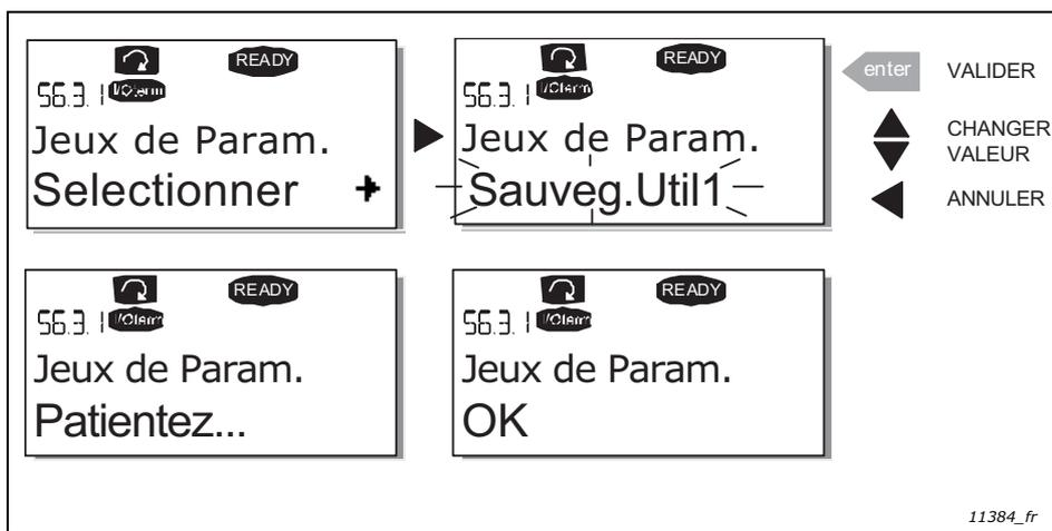
Figure 72. Stockage et chargement de jeux de paramètres
