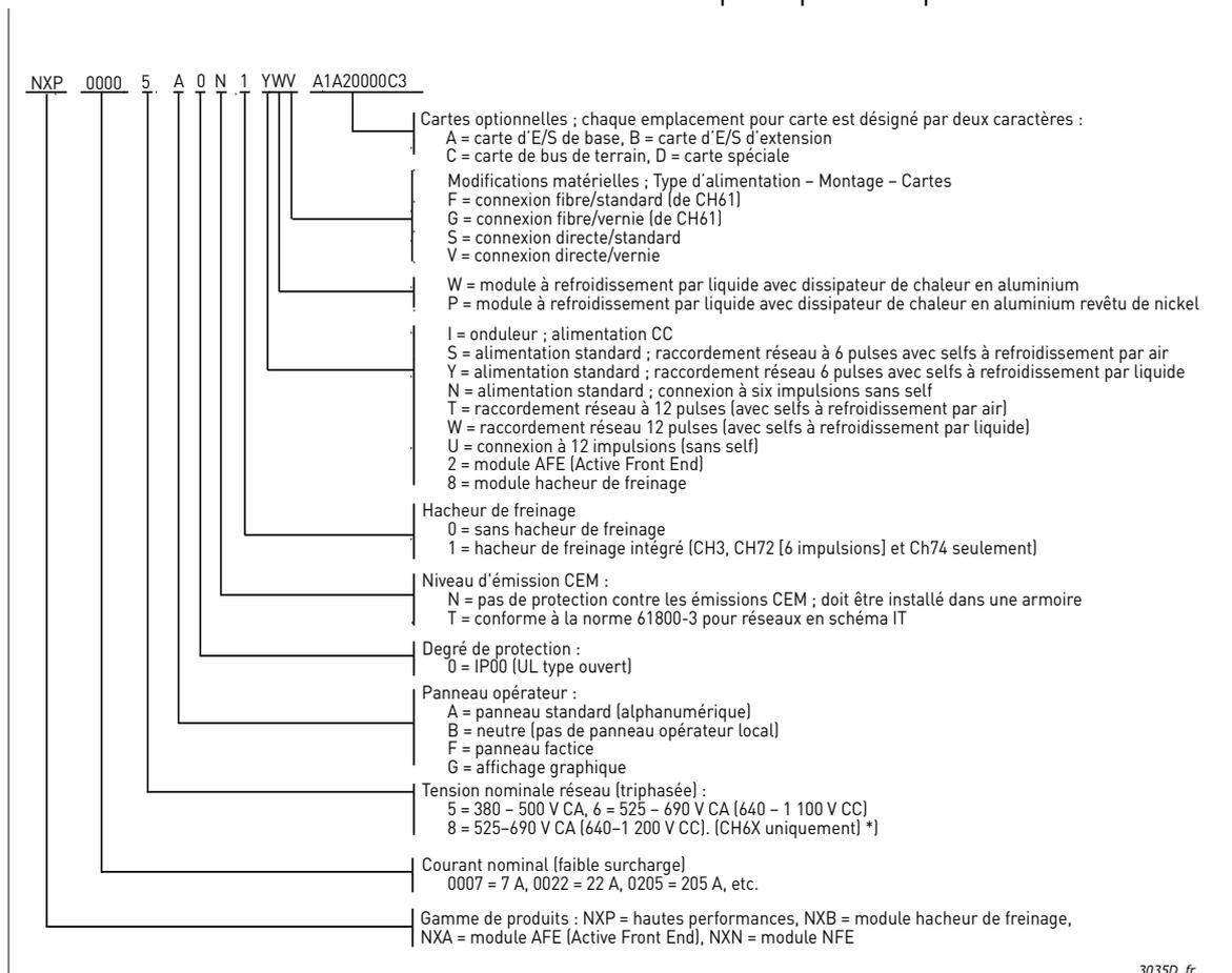
\*) Remarque ! L'unité de commande des convertisseurs NX\_8 (classe de tension 8) doit être alimentée par une source externe 4 Vc.c.
