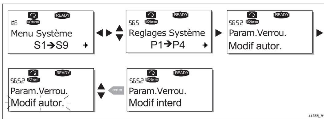
Figure 76. Verrouillage des paramètres
