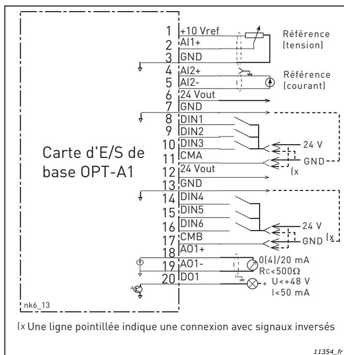
Figure 46. Schéma de câblage général de la carte d'E/S de base (OPT-A1)
