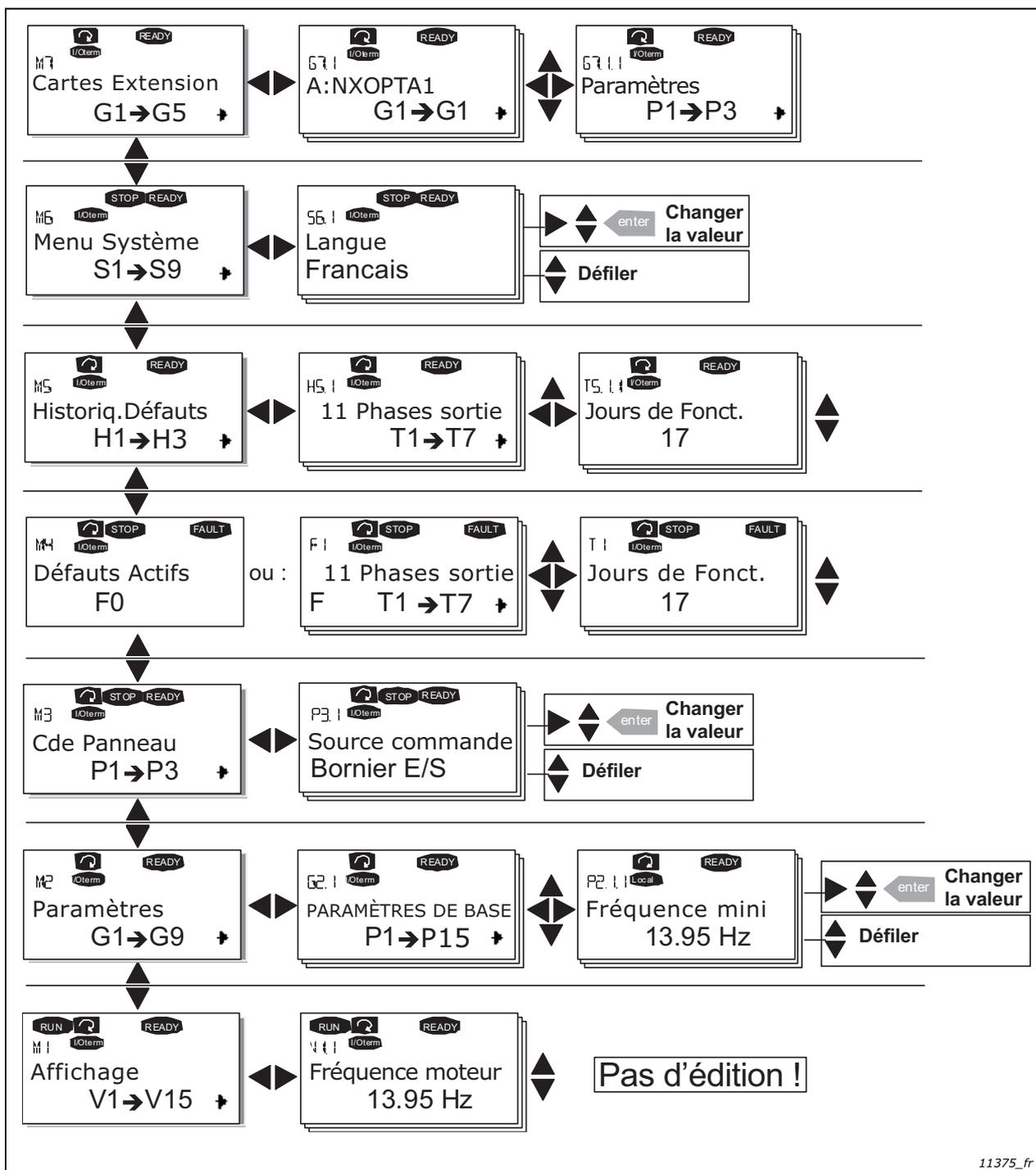
Figure 64. Diagramme de navigation du panneau opérateur
