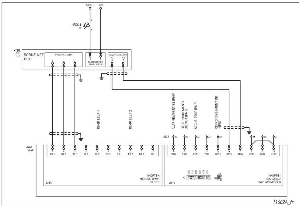
Figure 102. Schéma de câblage pour les contrôles, OPTBH, OPTB1
