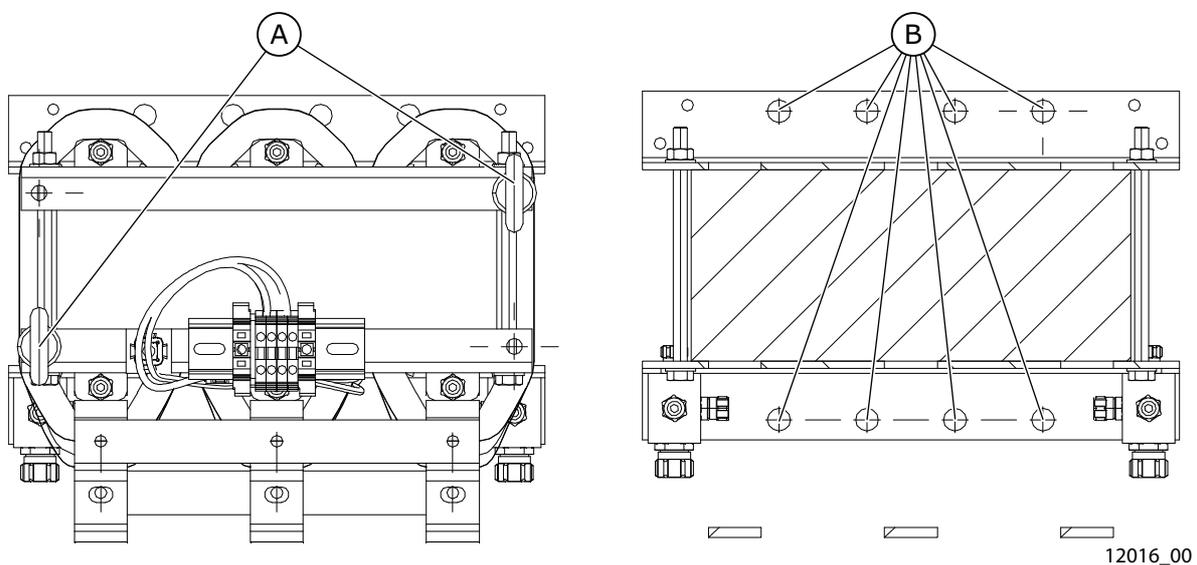
Figure 33. Les points de mise à la terre pour selfs d'entrée
