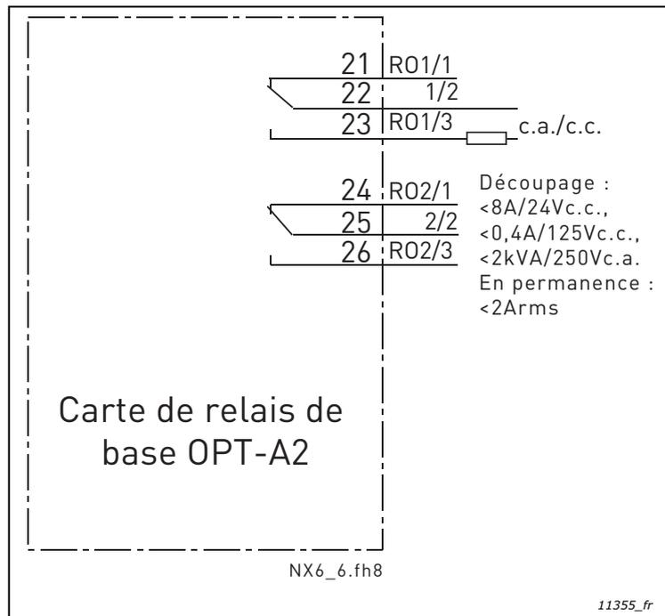
Figure 47. Schéma de câblage général de la carte de relais de base (OPT-A2)
