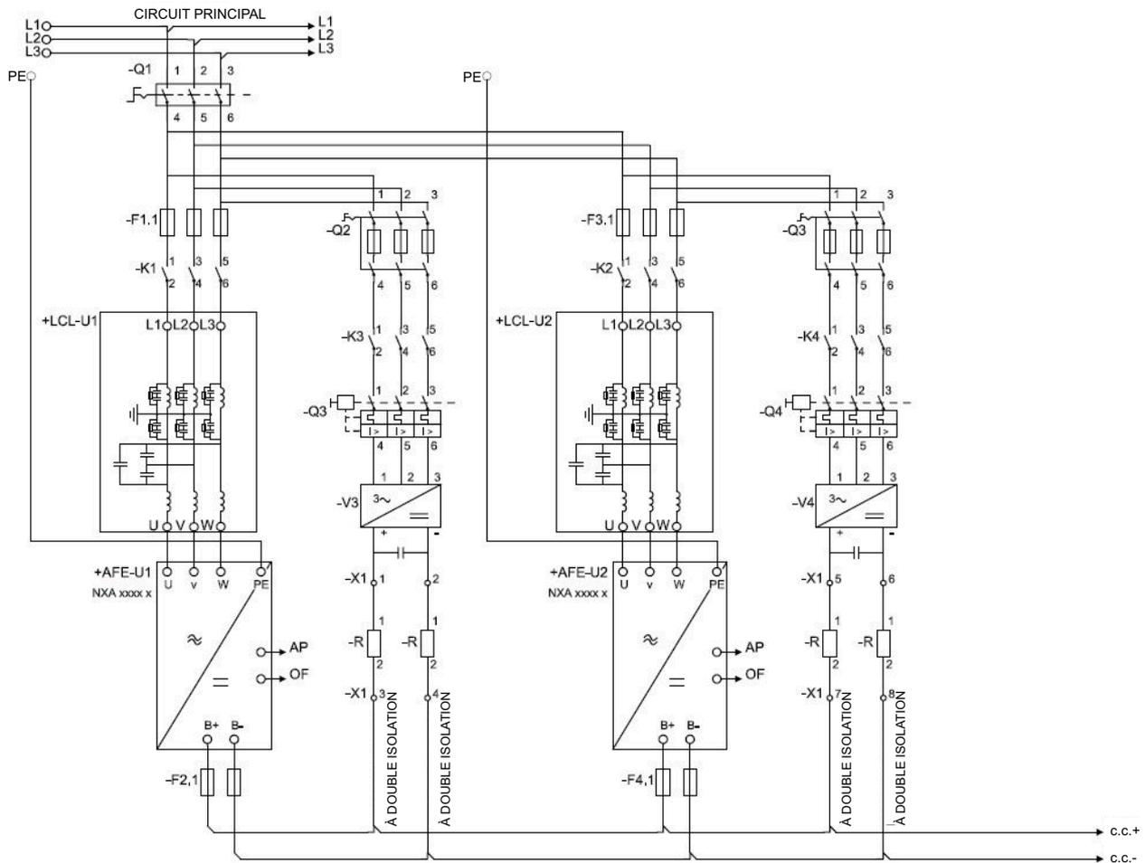
Figure 99. Branchement en parallèle des modules AFE avec circuits de précharge individuels
