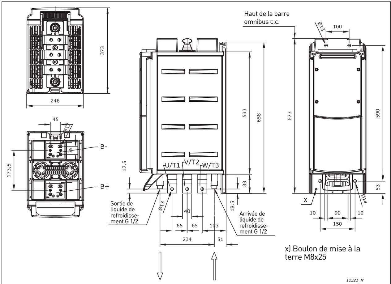
Figure 13. Onduleur VACON® refroidi par liquide, CH62
