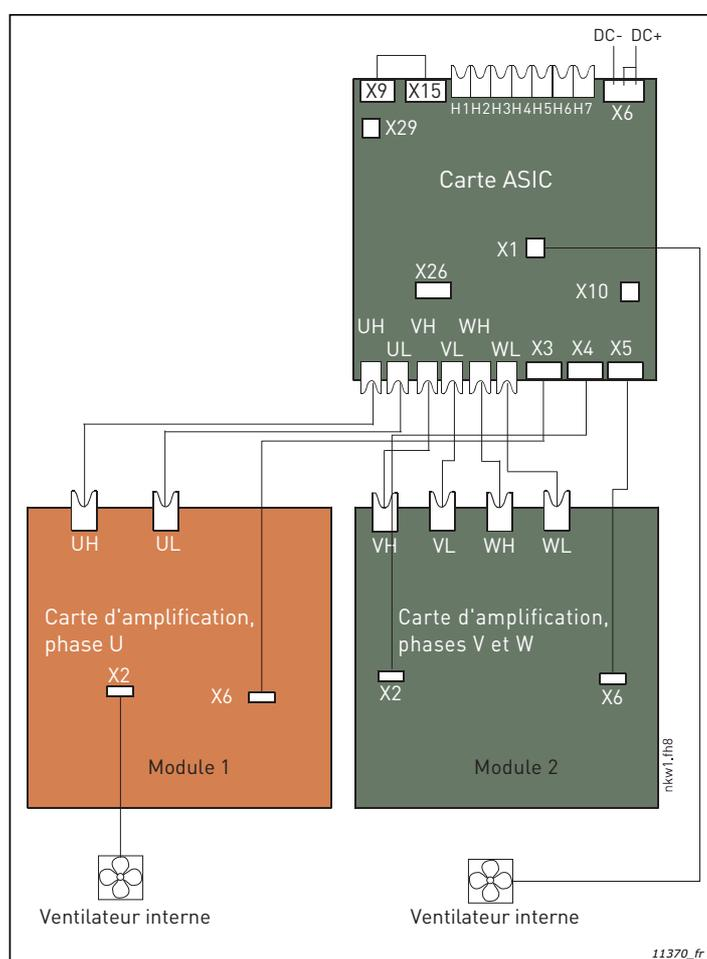
Figure 55. Bornes et raccordements entre la carte ASIC et les cartes Driver (CH63)
