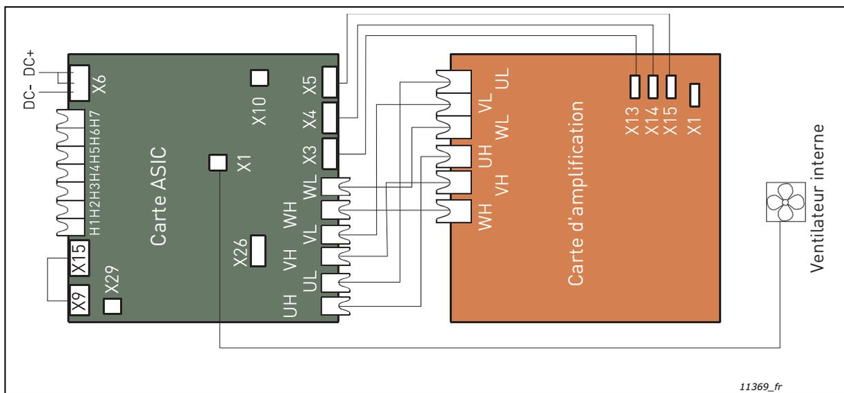
Figure 54. Bornes et raccordements entre la carte ASIC et la carte Driver (CH61, CH62 et CH72)
