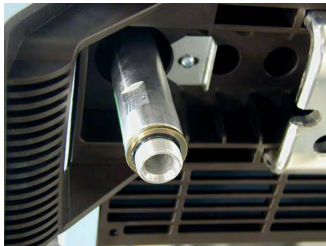
Abbildung 28. Außengewinde des Schlauchadapters
