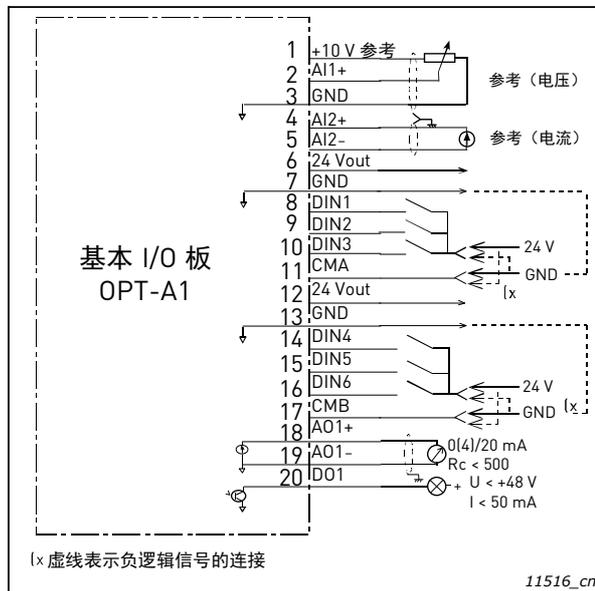
图 34. 基本 I/O 板 (OPT-A1) 的一般接线图
