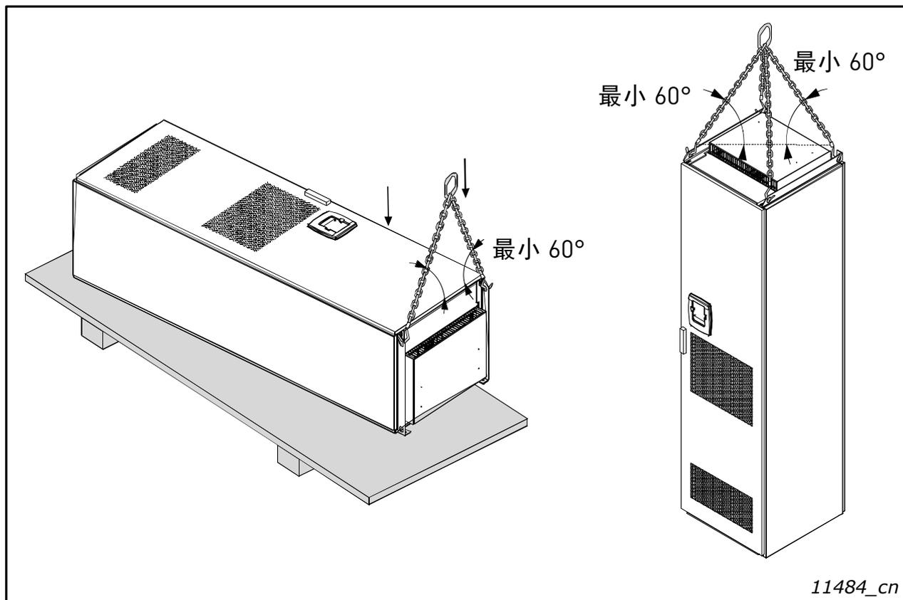
图 3. 吊起装置
