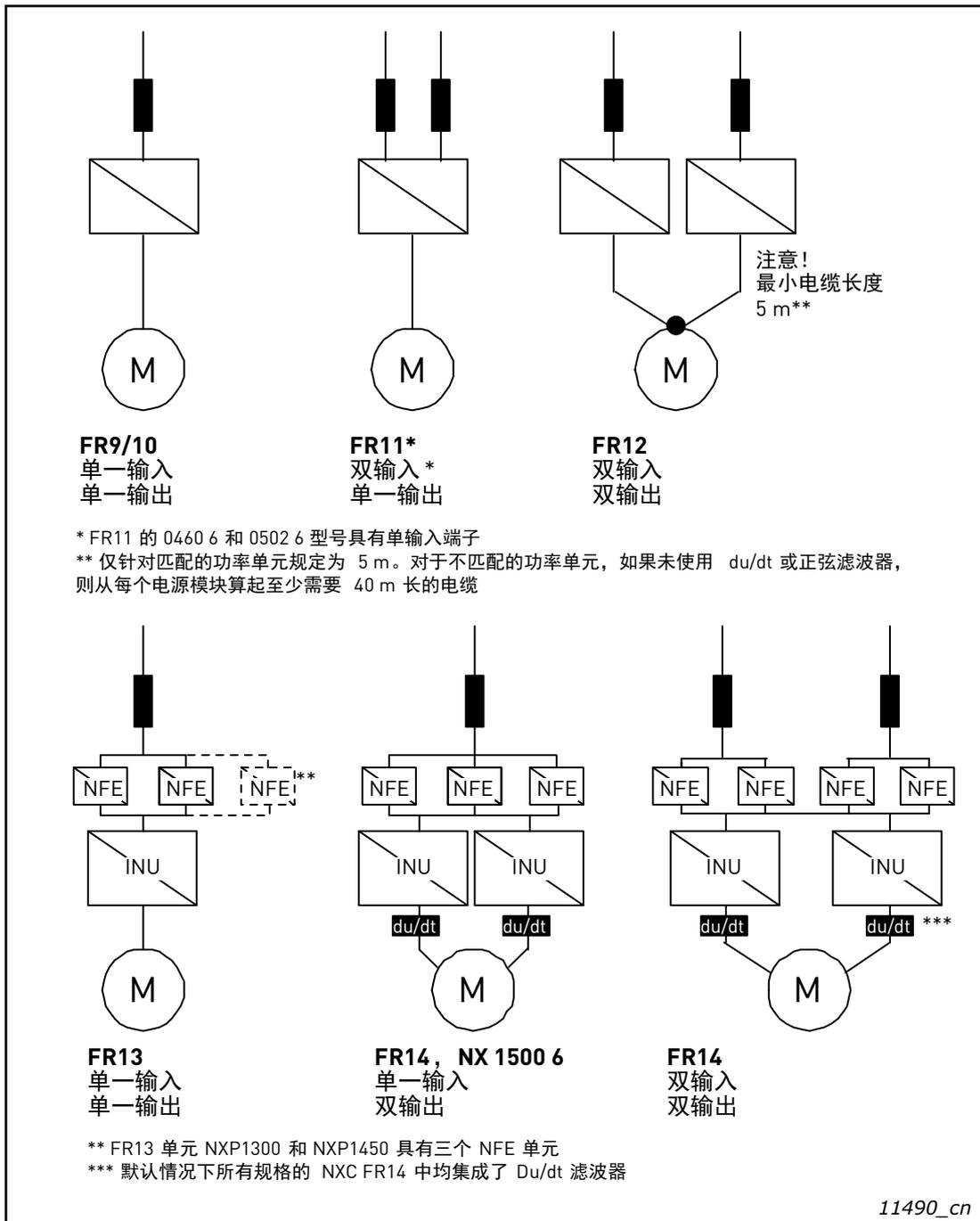
图 9. 机械尺寸 FR9–FR14、6/12 脉冲电源的拓扑结构
