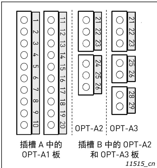
图 33. 基本板的 I/O 端子
