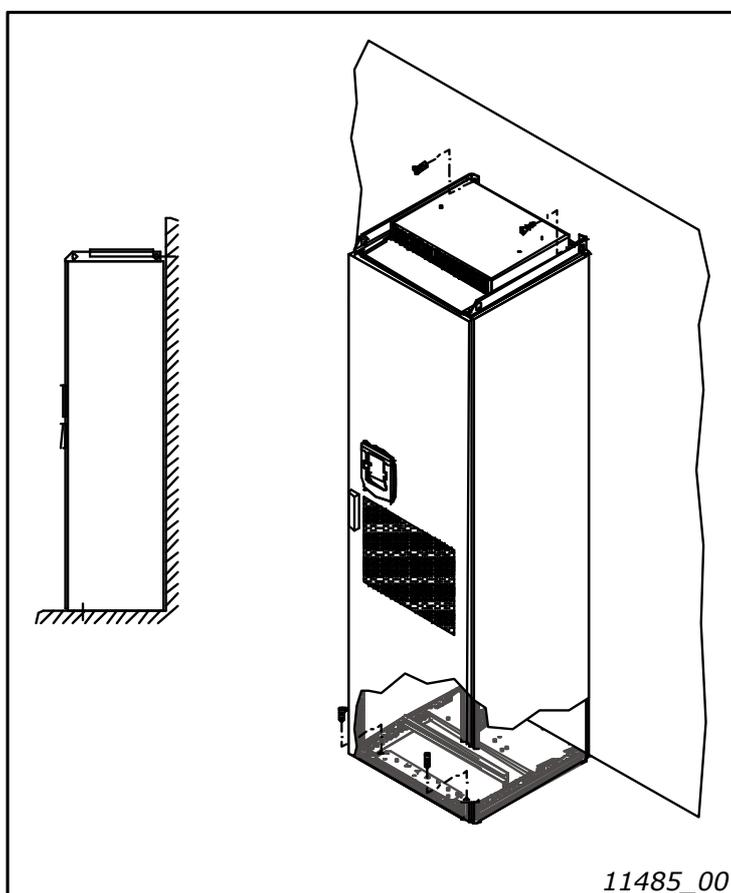
图 4. 将机柜固定在地板和墙上
