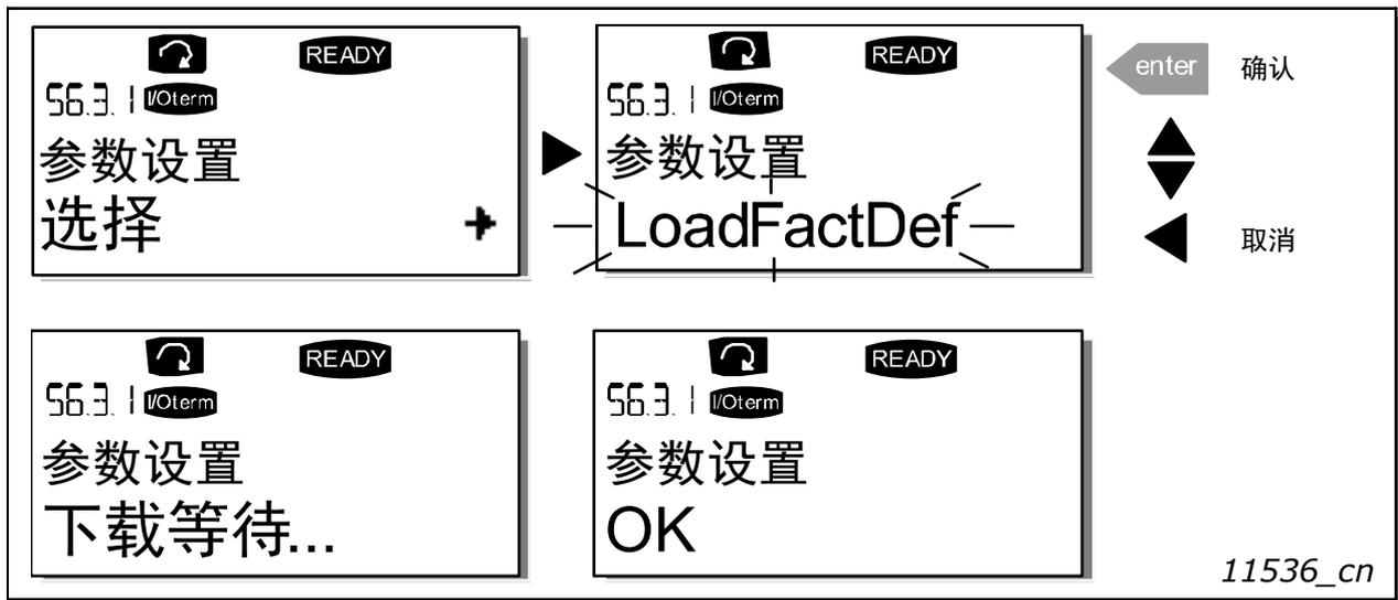
图 52. 参数集合的存储和加载
