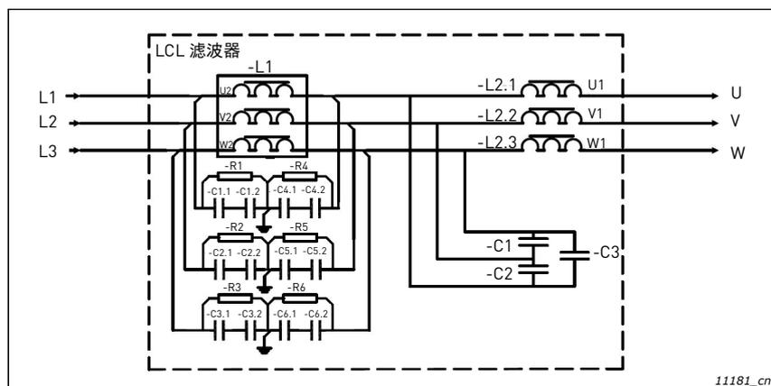
图 11. Vacon LCL 滤波器接线图
