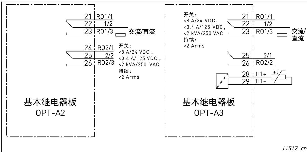
图 35. 基本继电器板 (OPT-A2/OPT-A3) 的一般接线图
