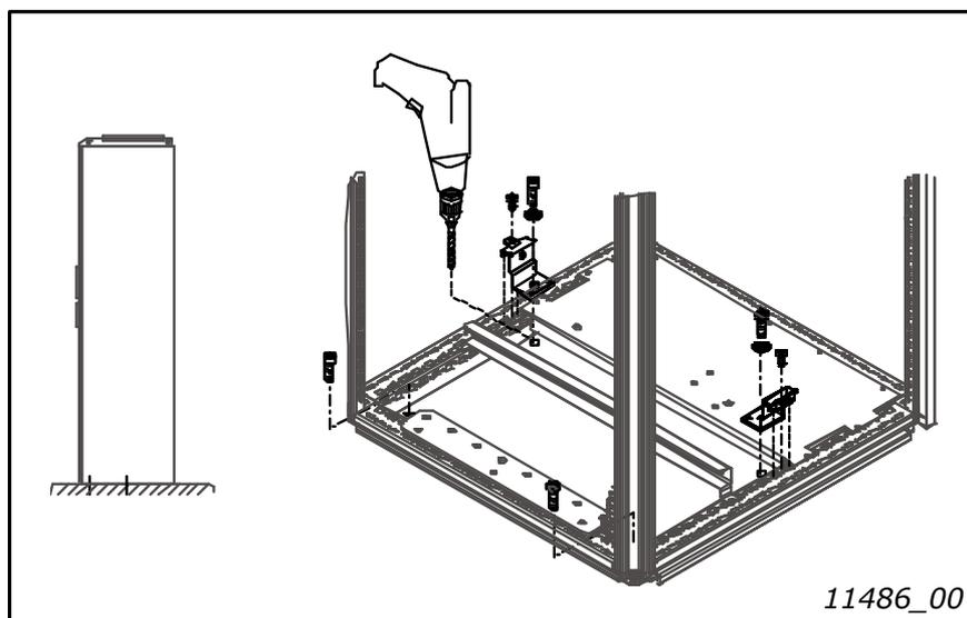
图 5. 将所有边角固定到地板上
