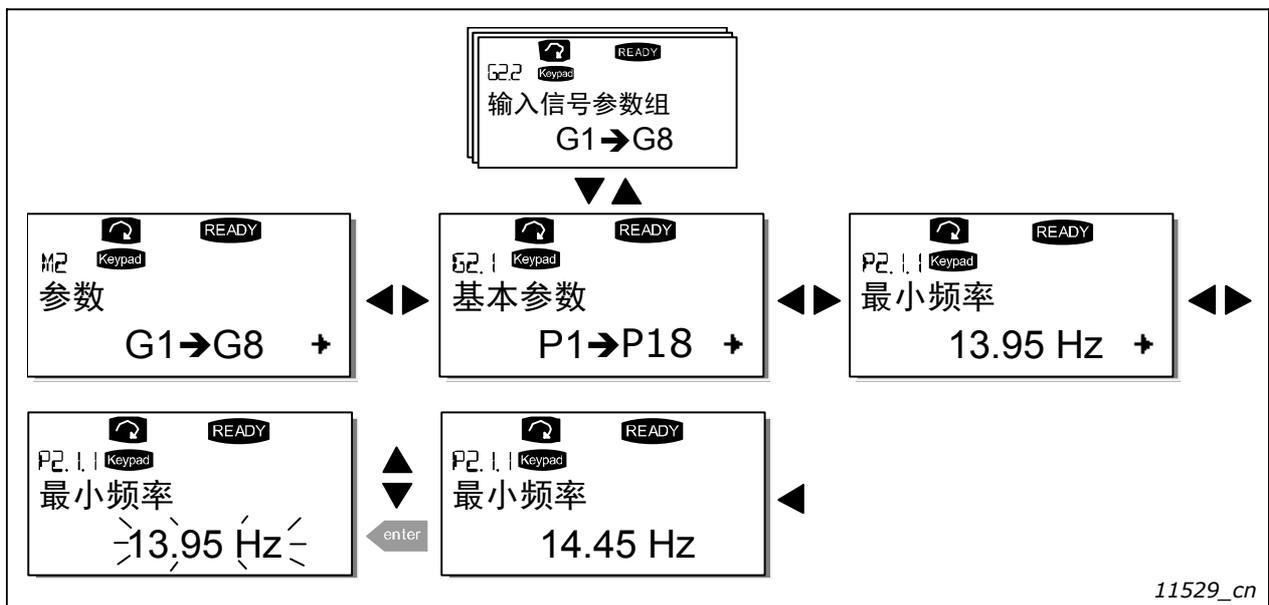
图 46. 参数值更改流程
