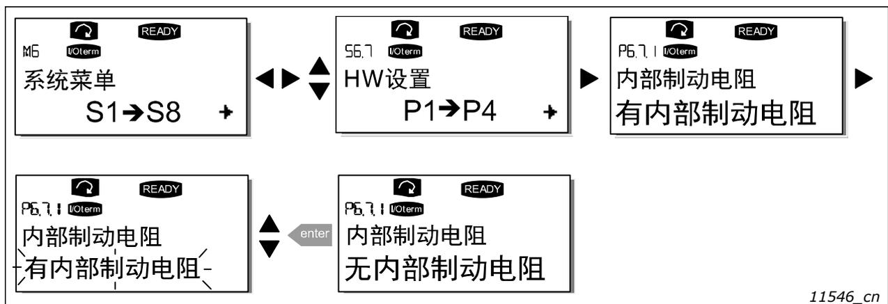
图 62. 内部制动电阻器连接
