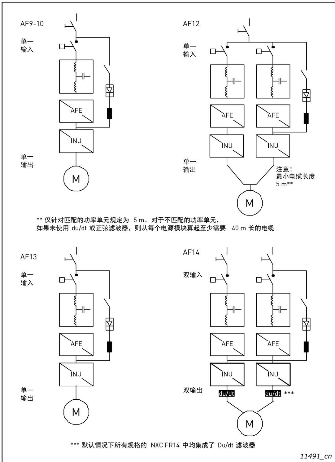
图 10. 机械尺寸 NXC 低谐波变频器 AF9 – AF14 的拓扑结构
