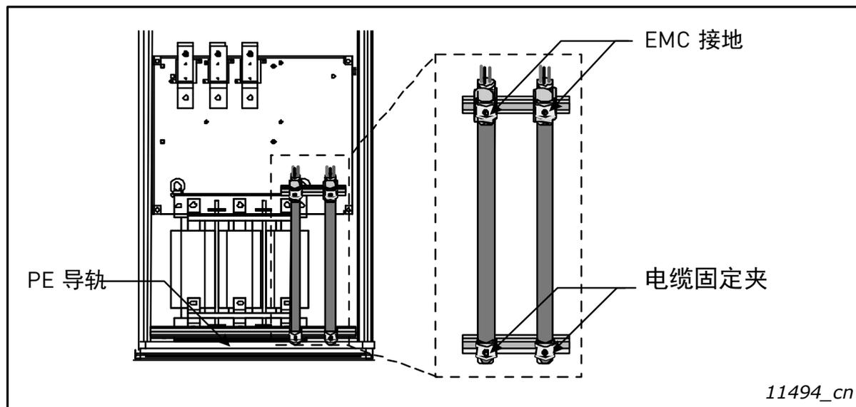
图 14. EMC 接地安装图
