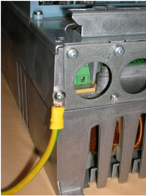
Abbildung 6-15. Zusätzliche Schutzleitung der MF4. Siehe kapitel 1.3
