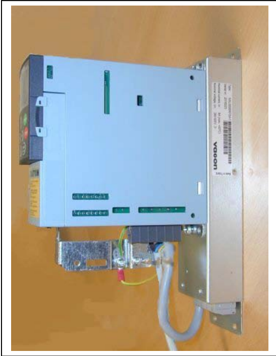
Kuva 6-10. MF2 RFI-suotimella RFI-0008-5-1 380...500V, 3-vaihesyöttö. Suodintyyppi RFI-0008-5-1
