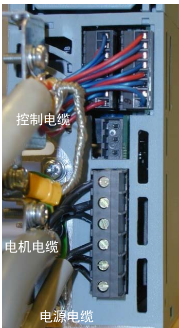
图 6-7. MF2 变频器的电缆安装 (500V, 3~)
