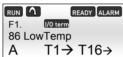
Рисунок 5.1-3, Аварийный сигнал при понижении температуры на панели NXP
