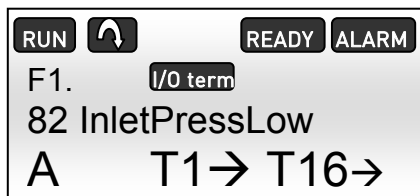
Рисунок 5.1-4, Аварийный сигнал при понижении давления на панели NXP
