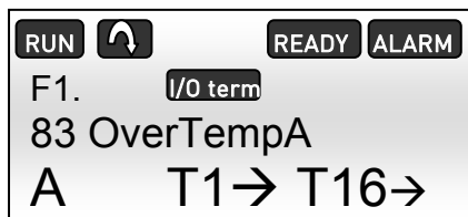
Рисунок 5.1-2, Аварийный сигнал о повышении температуры на панели NXP
