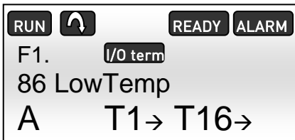
Abbildung 5.1-3, Untertemperatur-Alarm am Display der NXP-Steuertafel
