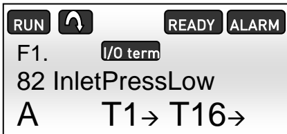
Abbildung 5.1-4, Unterdruck-Alarm am Display der NXP-Steuertafel
