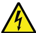
Les composants du module de puissance du convertisseur de fréquence sont **sous tension** lorsque le convertisseur Vacon NX refroidi par liquide est raccordé au secteur. **Tout contact avec cette tension est extrêmement dangereux et peut provoquer des blessures graves, voire mortelles.**
