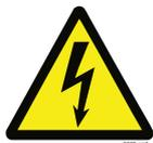
Les composants et cartes électroniques intégrés au convertisseur de fréquence sont **sous tension** lorsque le convertisseur Vacon NX refroidi par liquide est raccordé au secteur. **Tout contact avec cette tension est extrêmement dangereux et peut provoquer des blessures graves, voire mortelles.**
