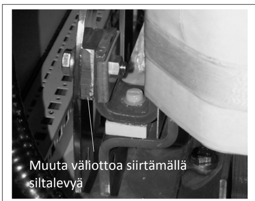
Kuva 7. Tulokuristimen säätö FR13/14-laitteissa
