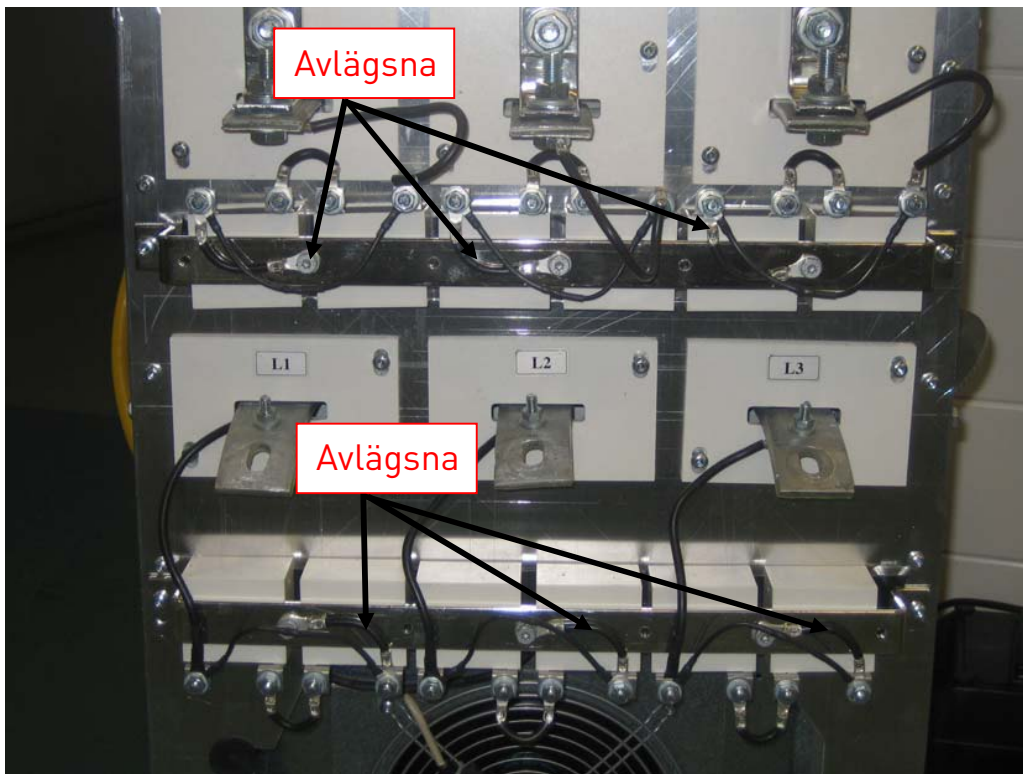
Figur 12. HF-kondensatorer i NXC regenerativa lågharmoniska omriktare, byggstorlekarna Fi9, Fi10 och Fi12, LCL-filter
