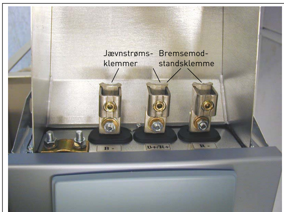
Figur 6-13. Klemkasse til bremsemodstand øverst på FR8
