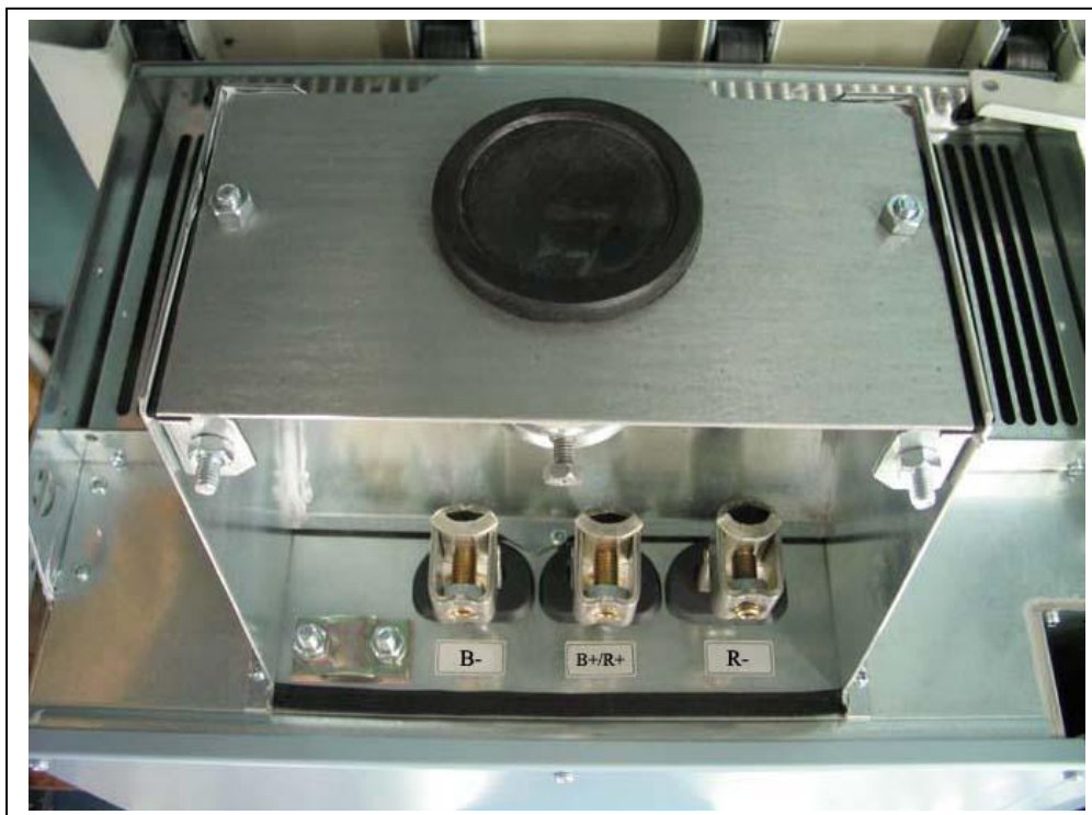
Figura 6-21. Terminais CC e do resistor do freio no FR9; Terminais CC marcados com B- e B+, terminais do resistor do freio marcados com R+ e R-
