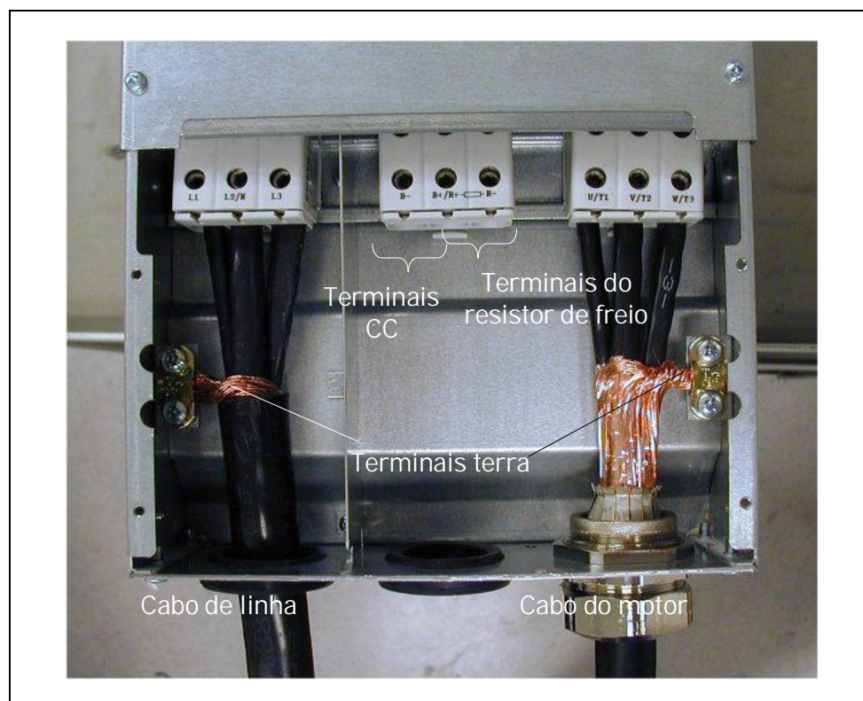
Figura 6-15. Instalação dos cabos no Vacon NXS/P, FR7
