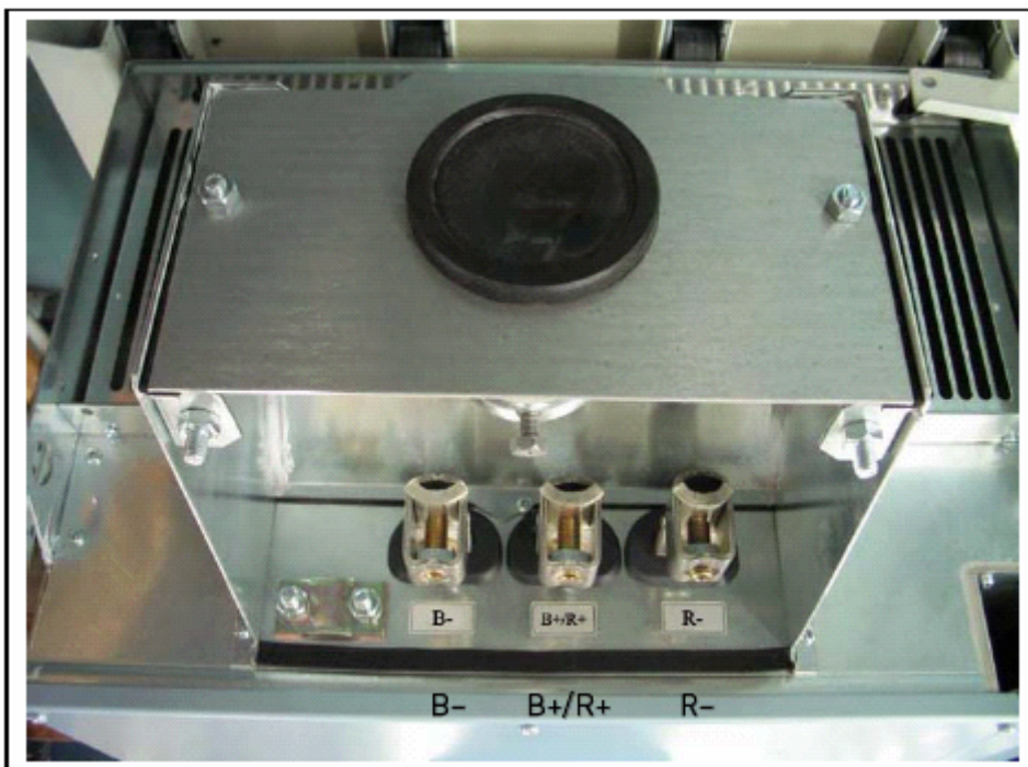
Rysunek 6-20. Zaciski DC i rezystora hamowania, podejście kabli od góry, wielkość mechaniczna FR9; zaciski obwodu DC oznaczone jako B- i B+, zaciski rezystora hamowania oznaczone jako R+ i R-.
