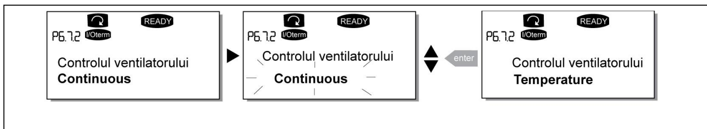
Figura 7-22. Funcția de control al ventilatorului
