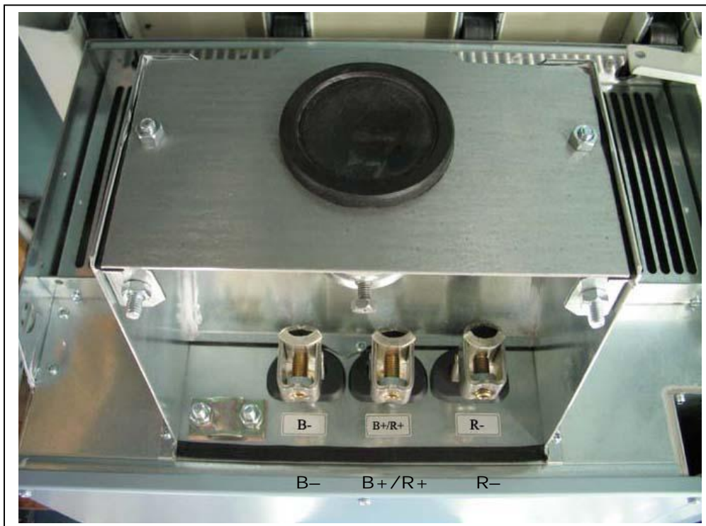
Figura 6-21. Terminalele CC și ale rezistenței frânei la FR9; Terminalele CC sunt marcate cu B- și B+, terminalele rezistenței frânei sunt marcate cu R+ și R-
