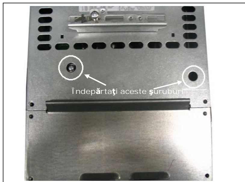
Figura 6-3. Modificarea clasei de protecție EMC, FR6. Nu este nevoie să îndepărtați capacul cablurilor
