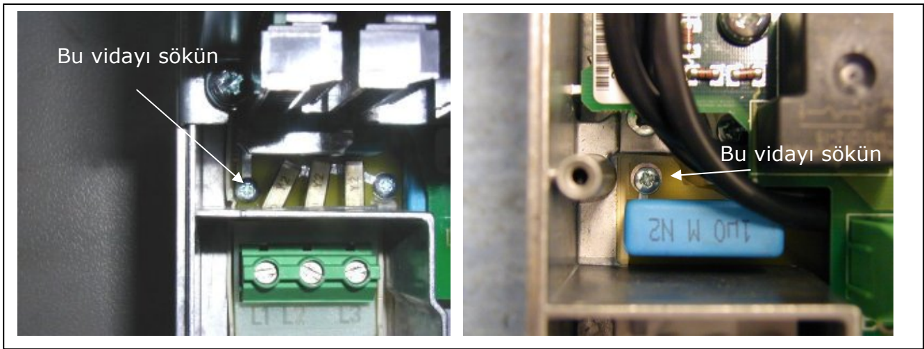
Şekil 5-18. EMC koruma sınıfının değiştirilmesi, FR4 (sol) ve FR5 (sağ).
