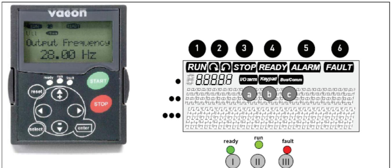
图 7-1. Vacon 控制面板和变频器状态指示
