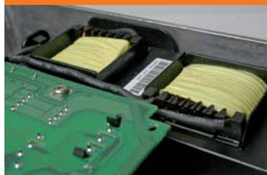
Les selfs DC réduisent les harmoniques et protègent le variateur
