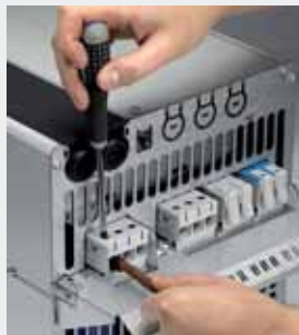
Collegamenti e morsetti per cavo motore sono localizzati nella parte inferiore dell'inverter per una facile e veloce installazione.
