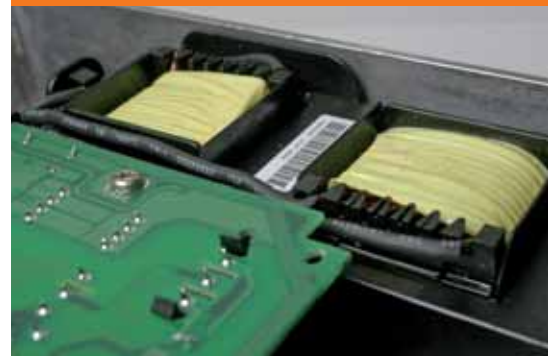
DC 리액터는 고조파 노이즈를 줄이고 인버터를 보호하여 줍니다. 또한 EMC 필터의 내장으로 EN55011 A2, A1 또는 B 등급의 규격을 충족 시켜줍니다.
