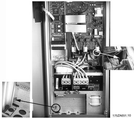
Kompaktformat IP 54/NEMA 12 VLT 8016 - 8032 380 - 480 V VLT 8006 - 8011 200 - 240 V
