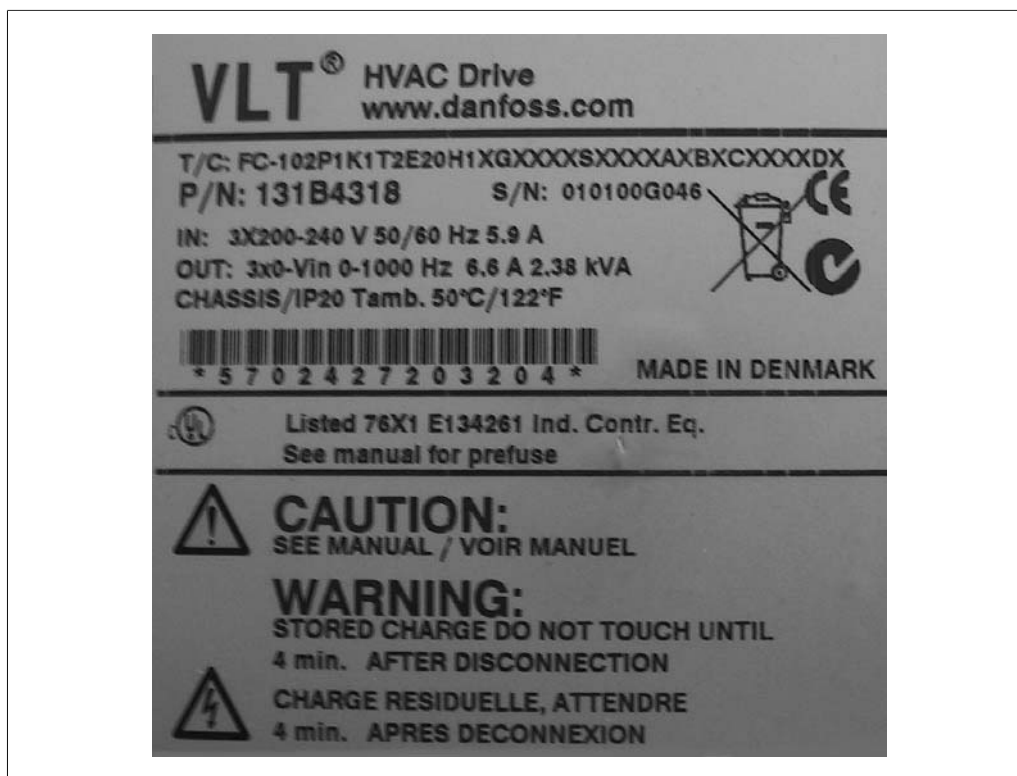
Illustration 2.1: Dit voorbeeld laat een identificatielabel zien.
