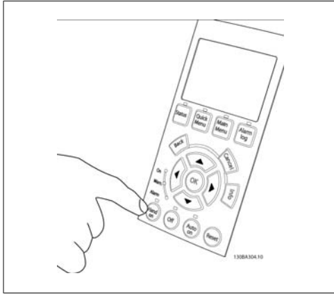
Illustration 4.23: Passo 5: Apertando o botão [Hand on] (Automático ligado), o LED do botão deve estar aceso e o motor poderá funcionar.
