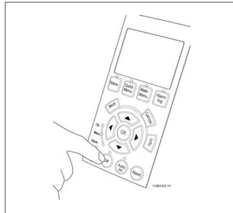
Abbildung 4.26: 8. Schritt: Drücken Sie die [Off]-Taste, um den Motor erneut zu stoppen.
