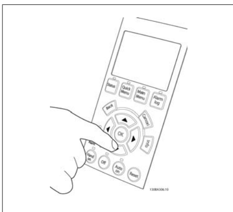
Abbildung 4.25: 7. Schritt: Den Cursor bewegen Sie mit den Pfeiltasten nach links ◀ und nach rechts ▶. Damit können Sie die Drehzahl in größeren Schritten ändern.
