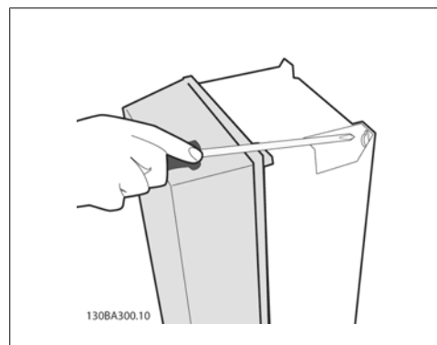
Disegno 3.14: Serraggio delle viti
