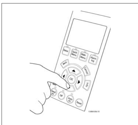
Bild 4.25: Steg 7: Använd pilknapparna vänster ◀ och höger ▶ för att flytta markören. Detta gör att varvtalet kan ändras i större steg.
