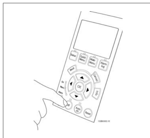
Bild 4.22: Steg 4: Slå på enheten och tryck på [Off]-knappen. I det här tillståndet ska motorn inte rotera. Du kan när som helst trycka på [Off] för att stoppa motorn. Observera att lysdioden på [Off]-knappen ska vara tänd. Om larm eller varningar blinkar, hittar du information om dessa i kapitel 7.
