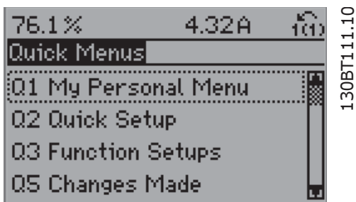
Illustration 6.3: Trin 2: Tryk på knappen [Quick Menu] (Kvikmenuens valgmuligheder vises).
