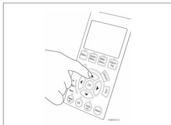
Abbildung 4.44: 6. Schritt: Die Drehzahl des Motors wird auf dem LCP angezeigt. Sie kann über die Pfeiltasten nach oben ▲ und unten ▼ geändert werden.
