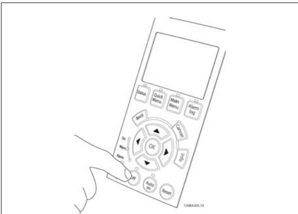
Illustration 4.46: Étape 8 : appuyer sur la touche [Off] pour arrêter le moteur.
