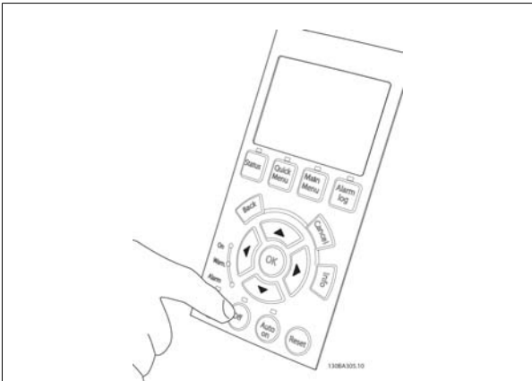
Ilustración 4.46: Paso 8: Pulse el botón [Off] (Apagar) para parar el motor de nuevo.
