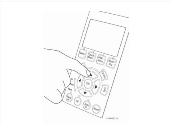
Ilustración 4.44: Paso 6: En el LCP se puede ver la velocidad del motor. Se puede ajustar pulsando los botones flecha arriba ▲ y flecha abajo ▼.
