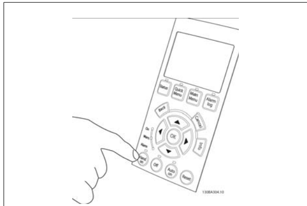
Ilustración 4.43: Al pulsar el botón [Hand on] (Marcha local), el LED situado encima del botón debería encenderse y el motor debería girar.
