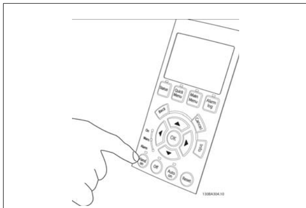
Disegno 4.43: Fase 5: Premendo il pulsante [Hand on], il LED sopra il pulsante dovrebbe essere illuminato e il motore può ruotare.
