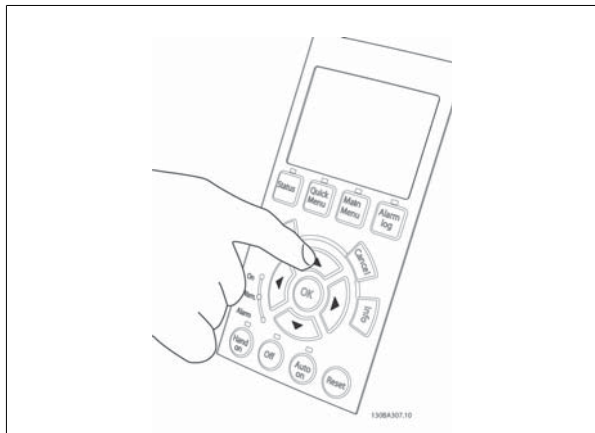
Disegno 4.44: Fase 6: La velocità del motore può essere visualizzata nell'LCP. Può essere regolata premendo i tasti a freccia Su ▲ e Giù ▼.
