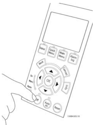
Bild 4.46: Steg 8: Tryck på [Off]-knappen för att stoppa motorn igen.
