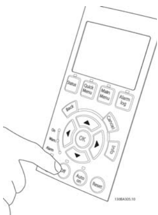
Bild 4.42: Slå på enheten och tryck på [Off]-knappen. I det här tillståndet ska motorn inte rotera. Du kan när som helst trycka på [Off] för att stoppa motorn. Observera att lysdioden på [Off]-knappen ska vara tänd. Om larm eller varningar blinkar, hittar du information om dessa i kapitel 7.
