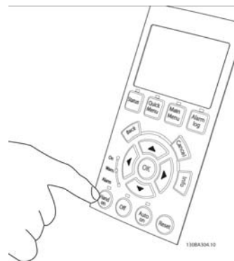
Bild 4.43: Vid tryck på knappen [Hand on] ska lysdioden ovanför ovanför knappen tändas och motorn rotera.
