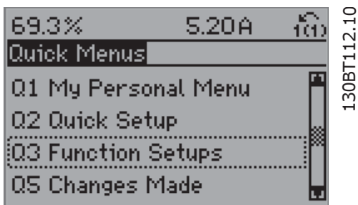
Bild 6.4: Steg 3: Använd navigeringsknapparna upp/ned för att bläddra ned till Funktionsinställningar. Tryck på [OK]
