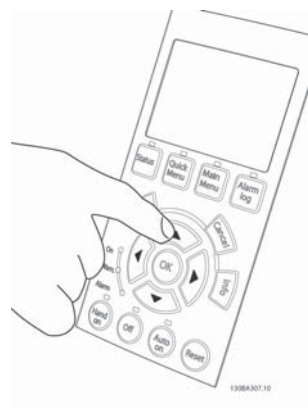
Bild 4.44: Steg 6: Motorns varvtal visas på LCP:n. Det kan justeras med pilknapparna upp ▲ och ned ▼.
