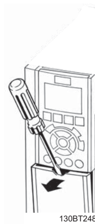
Ilustración 4.46: Acceso a los terminales de control de las protecciones A2, A3, B3, B4, C3 y C4
