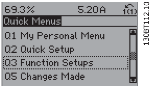
Kuva 6.4: Vaihe 3: Vieritä alas toimintoasetuksiin navigointinäppäimillä ylös/alas. Paina [OK]-näppäintä.
