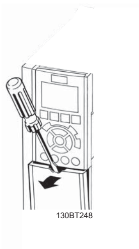
Abbildung 4.38: Zugriff auf Steuerklemmen in den Gehäusen A2, A3, B3, B4, C3 und C4
