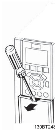
Ilustração 4.38: Acesso aos terminais de controle dos gabinetes metálicos A2, A3, B3, B4, C3 e C4
