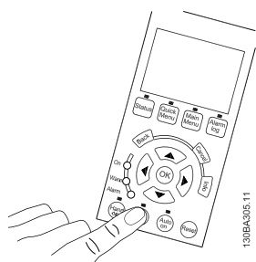
図 4.48: ステップ 8: [Off] ボタンを押して、モーターをもう一度停止します。
