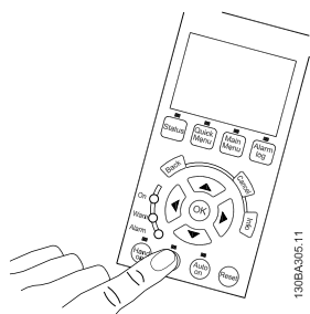
図 4.44: ステップ 4: ユニツトに電源を入れて、[Off] ボタンを押します。モーターが回転していないことを確認します。[Off] を押すと、いつでもモーターを停止できます。[OFF] ボタンの LED が点灯していることを確認してください。警報または警告がフラッシュしている場合は、第 7 章を参照してください。
