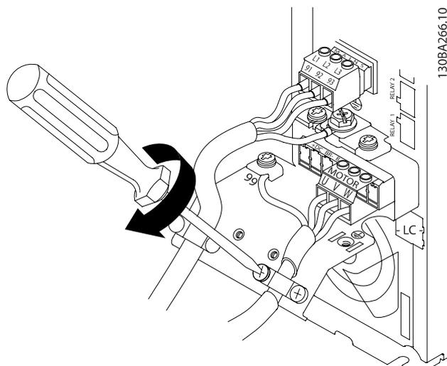
図 4.18: ケーブル・クランプを取り付けて、シヤースとシールド間の 360 度の接続を確保します。クランプの下に来るモーター・ケーブル部分の外側の絶縁体が除去されていることを確認してください。
