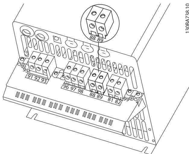
図 4.22: エンクロージャー C3 の直流バス接続。
