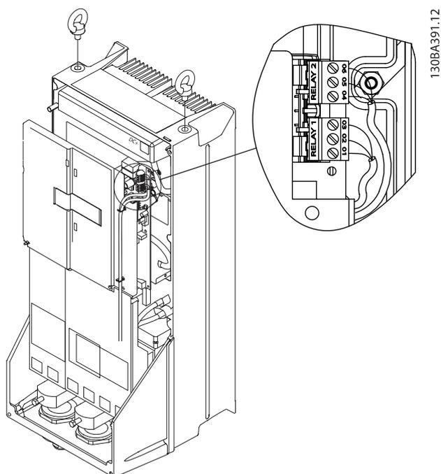
図 4.28: リレー接続用端末 C1 および C2 エンクロージャー
