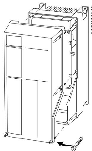
図 4.33: A4、A5、B1、B2、C1、C2 エンクロージャコントロール端子にアクセス
