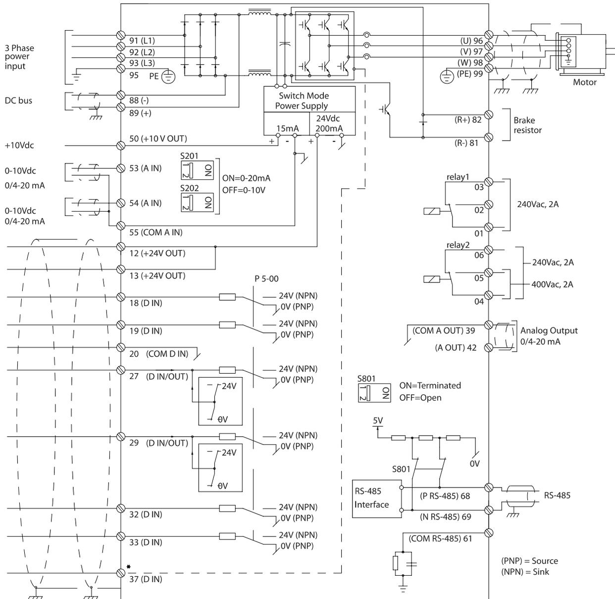
図 4.1: すべての電気的端子を示す図 (端子 37 は安全停止機能付きのユニットにのみ使用できます。)
