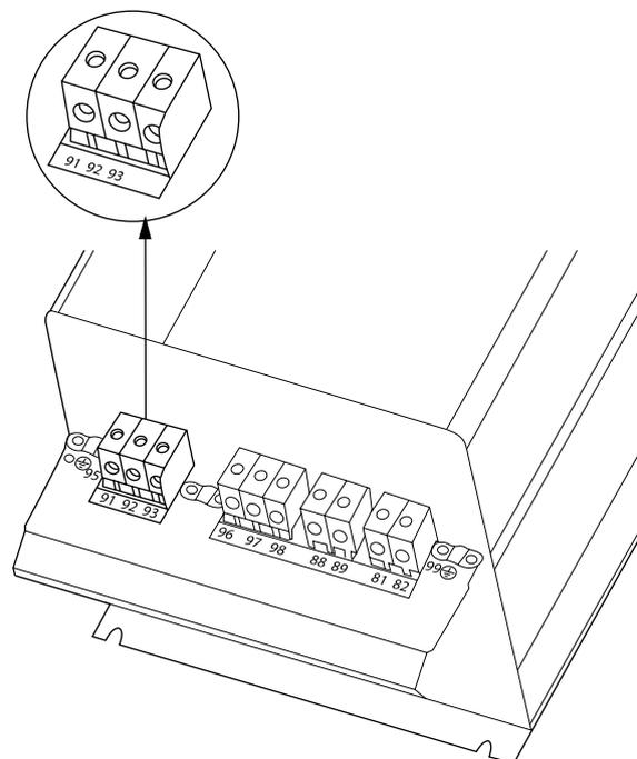
図 4.14: C3 を主電源と接地に接続する方法。
