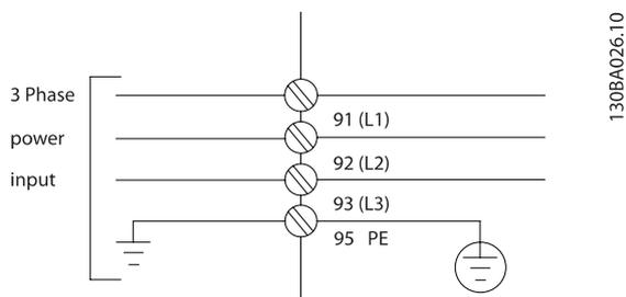
図 4.2: 主電源と接地の端末
