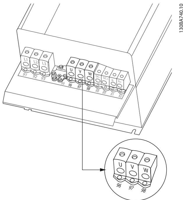
まずモーターの接地線を終端させ、モーターの U、V、W ワイヤを端子板に取り付けて締め付けます。EMC クランプの下に来るモーター・ケーブル部分の外側の絶縁カバーが除去されていることを確認してください。
