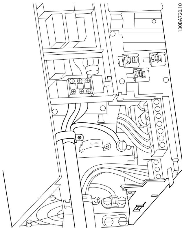
図 4.11: RFI を伴う B3 の主電源と接地への接続方法
