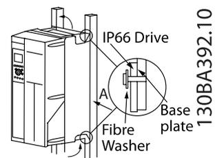
フレームサイズ A4、A5、B1、B2、B3、B4、C1、C2、C3、C4 を堅固でない背面壁に実装する場合には、ヒート・シンクの冷却用の空気が不十分になるためドライブに背板 A を取り付けてください。
