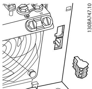
図 4.29: B3 のリレー接続用端末。工場では、ひとつのリレー
