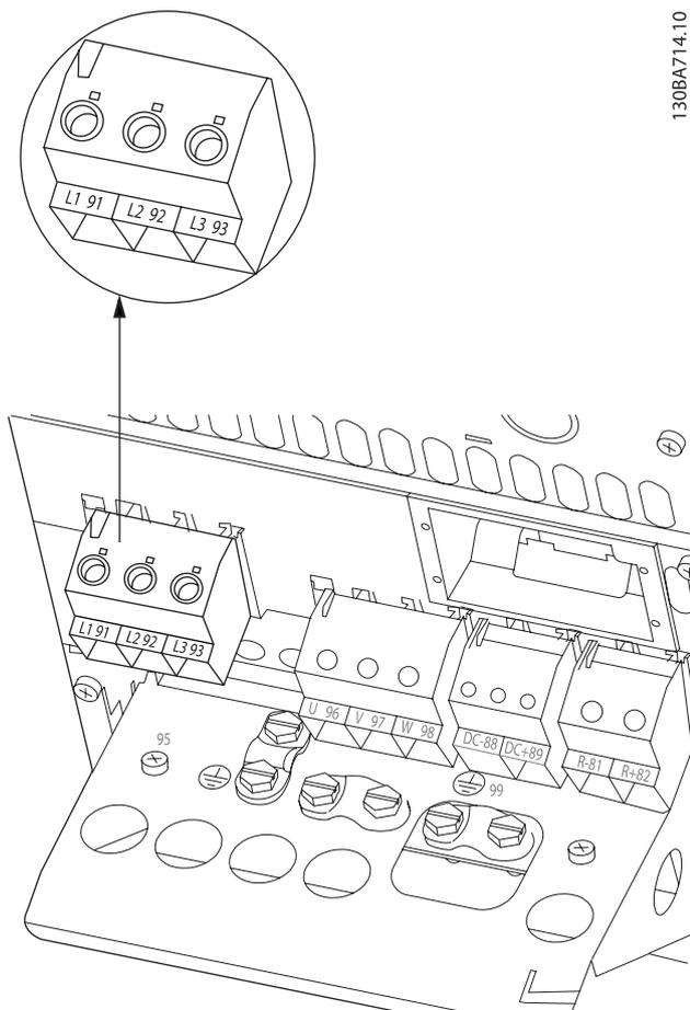
図 4.12: B4 を主電源と接地に接続する方法。
