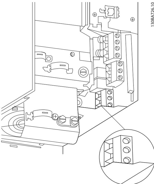
まずモーターの接地線を終端させ、モーターの U、V、W ワイヤを端子板に取り付けて締め付けます。EMC クランプの下に来るモーター・ケーブル部分の外側の絶縁カバーが除去されていることを確認してください。
