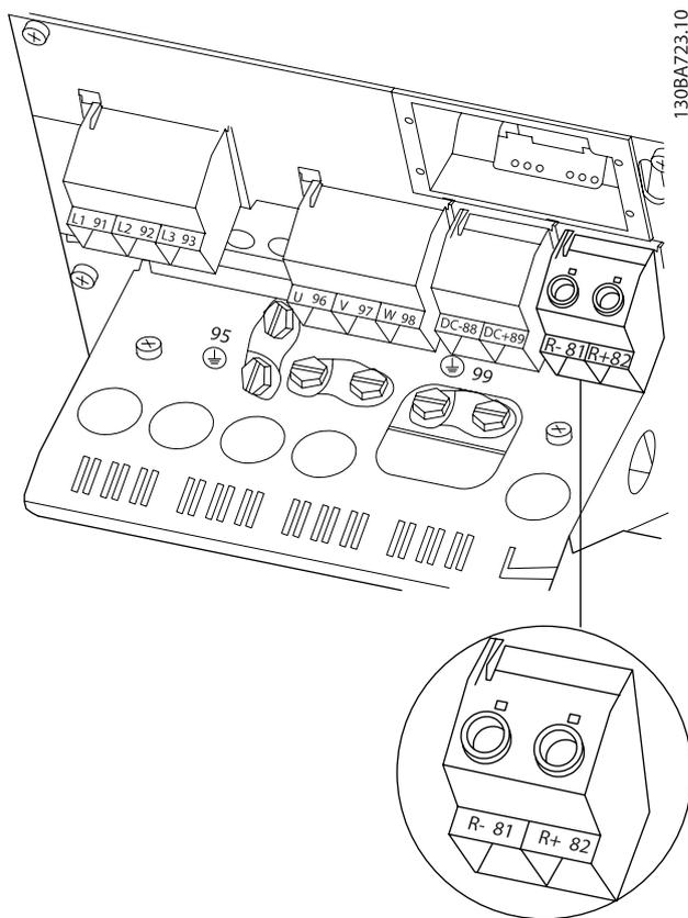
図 4.25: B4 のブレーキ接続端末のブレーキ接続端末
