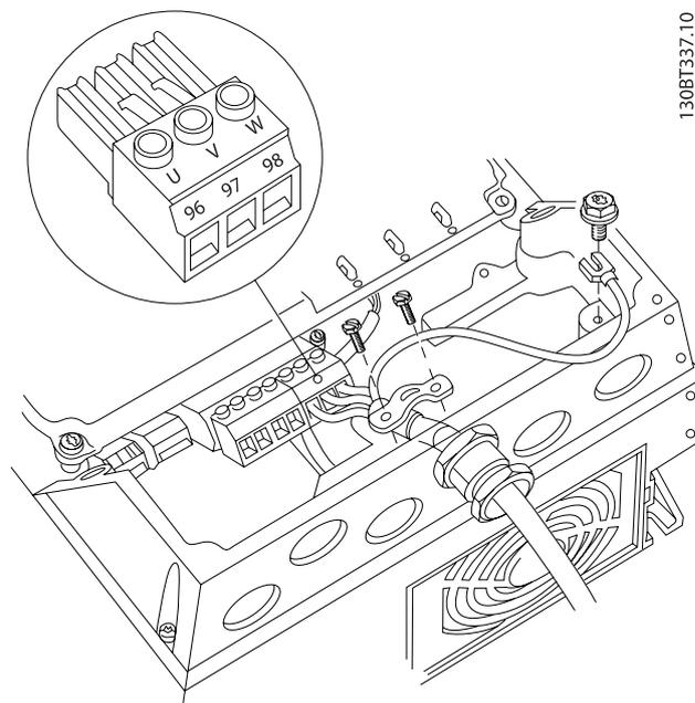
図 4.19: まずモーターの接地線を終端させ、モーターの U、V、W ワイヤを端子板に取り付けて締め付けます。EMC クランプの下に来るモーター・ケーブル部分の外側の絶縁カバーが除去されていることを確認してください。
