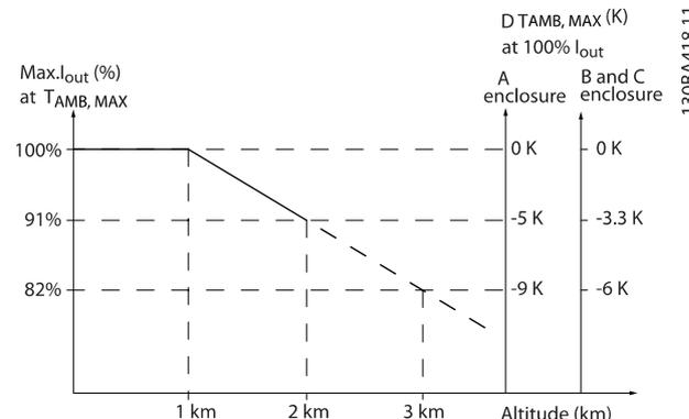
図 9.1: フレームサイズ A、B、C のための  $T_{AMB, MAX}$  における出力電流の定格値の低減。標高 2 km を超える場合の PELV については、Danfoss にお問い合わせください。
