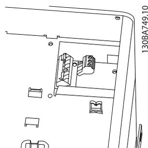
図 4.31: C3 および C4 のリレー接続用端末。周波数変換器の右上
