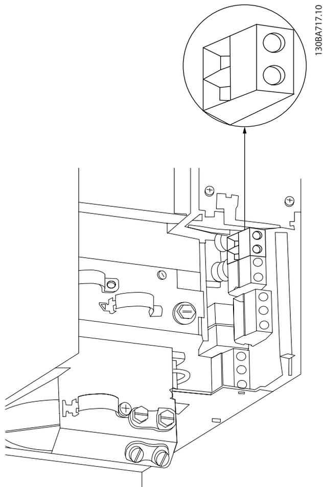
図 4.20: エンクロージャー B3 の直流バス接続。
