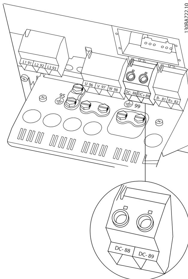
図 4.21: エンクロージャー B4 の直流バス接続。
