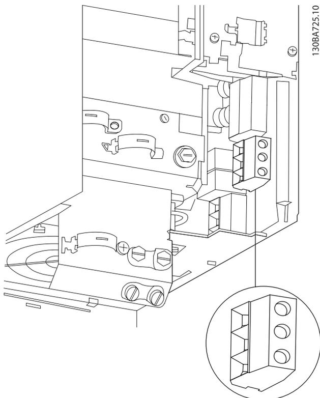
図 4.10: RFI を伴わない B3 の主電源と接地への接続方法
