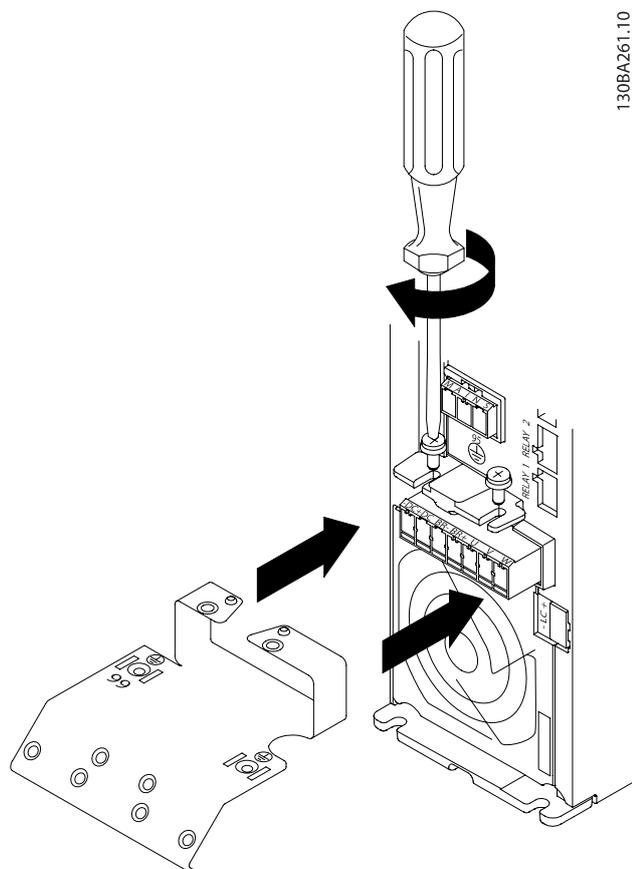
図 4.3: まず、取り付け板に 2 本のネジを取り付け、定位置までスライドしてから完全に締め付けます。
