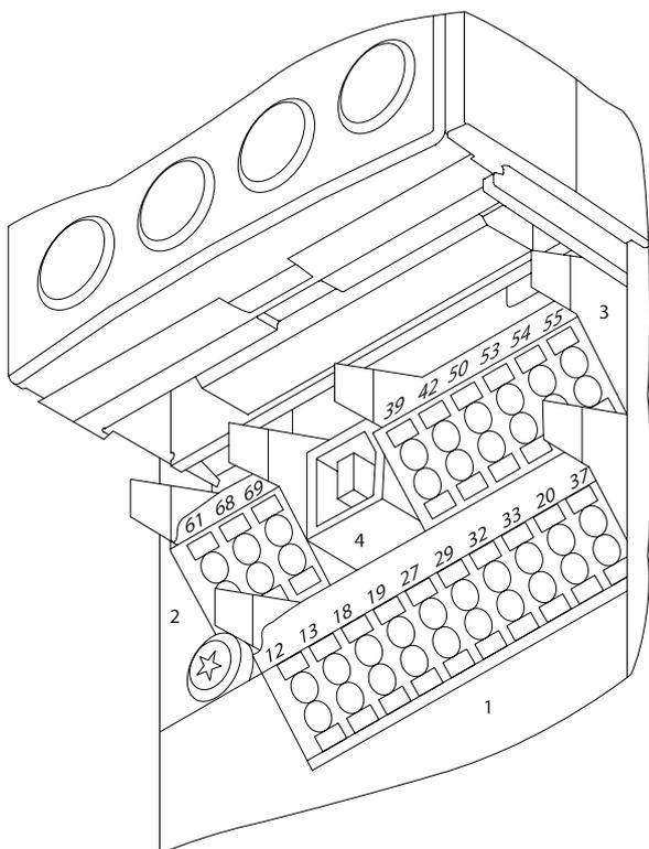
図 4.34: コントロール端末 (すべてのエンクロージャ)
