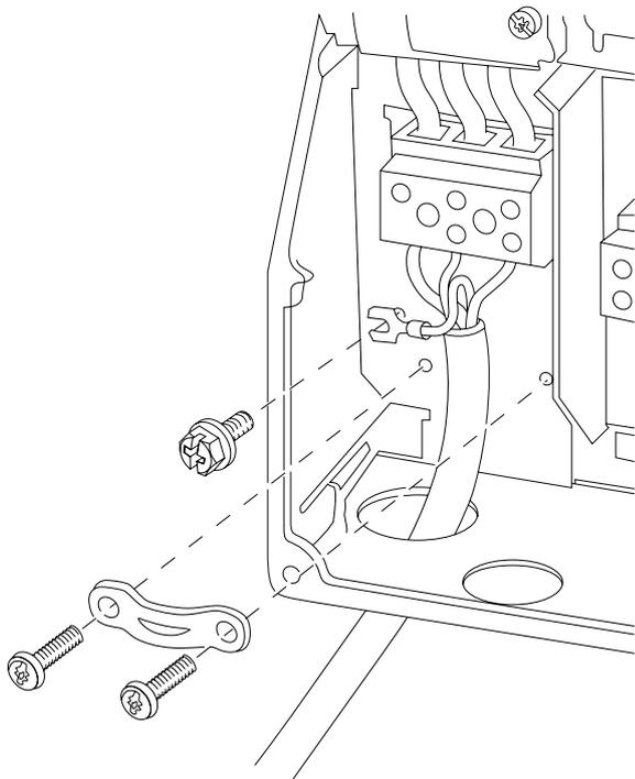
図 4.9: B1 and B2 の主電源と接地への接続方法
