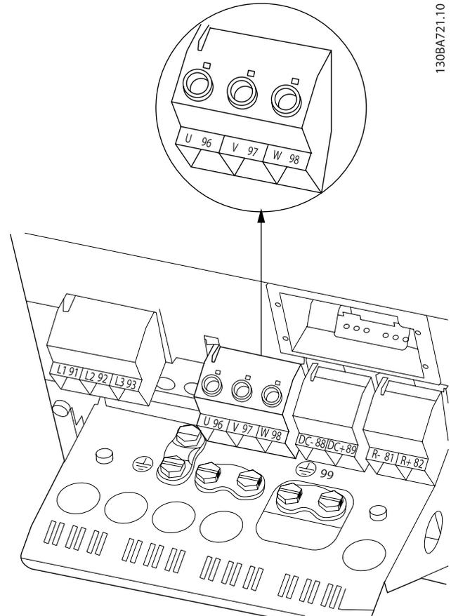
まずモーターの接地線を終端させ、モーターの U、V、W ワイヤを端子板に取り付けて締め付けます。EMC クランプの下に来るモーター・ケーブル部分の外側の絶縁カバーが除去されていることを確認してください。
