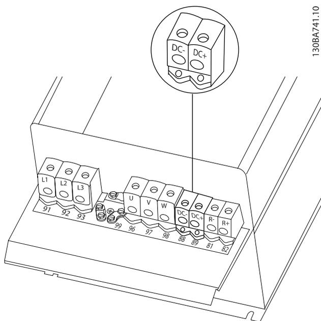
図 4.23: エンクロージャ C4 の直流バス接続。
