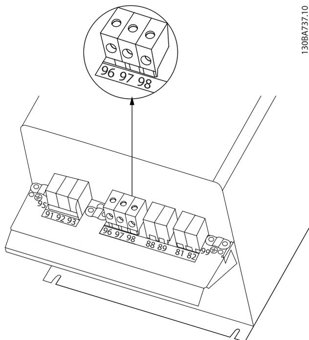
まずモーターの接地線を終端させ、モーターの U、V、W ワイヤを適切な端子板に取り付けて締め付けます。EMC クランプの下に来るモーター・ケーブル部分の外側の絶縁カバーが除去されていることを確認してください。
