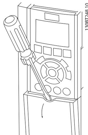
図 4.32: A2、A3、B3、B4、C3、C4 エンクロージャコントロール端子にアクセス
