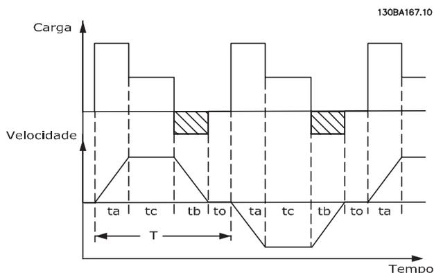
A Danfoss oferece resistores de freio com ciclo útil de 5%, 10% e 40% apropriados para uso com a série VLT® HVAC Drive conversor de frequência. Se for aplicado um resistor com ciclo útil de 10%, pode-se absorver a potência de frenagem até 10% da duração do ciclo, com os 90% restantes sendo utilizados para dissipar o calor do resistor.
