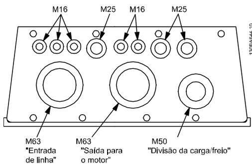
**Ilustração 5.13 Furos para entrada de cabo no gabinete metálico C2.** As sugestões de uso dos furos compreendem apenas recomendações; outras soluções são possíveis.
