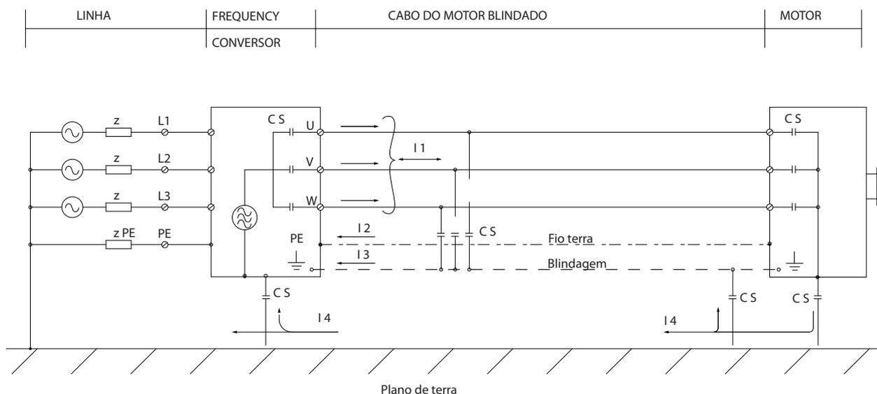
Se a blindagem deve ser colocada em uma placa de montagem do conversor de frequência, a placa de montagem deve ser metálica porque as correntes da blindagem devem ser conduzidas de volta à unidade. Além disso, garanta um bom contacto elétrico da placa de montagem, por meio dos parafusos de montagem, com o chassi do conversor de frequência.
