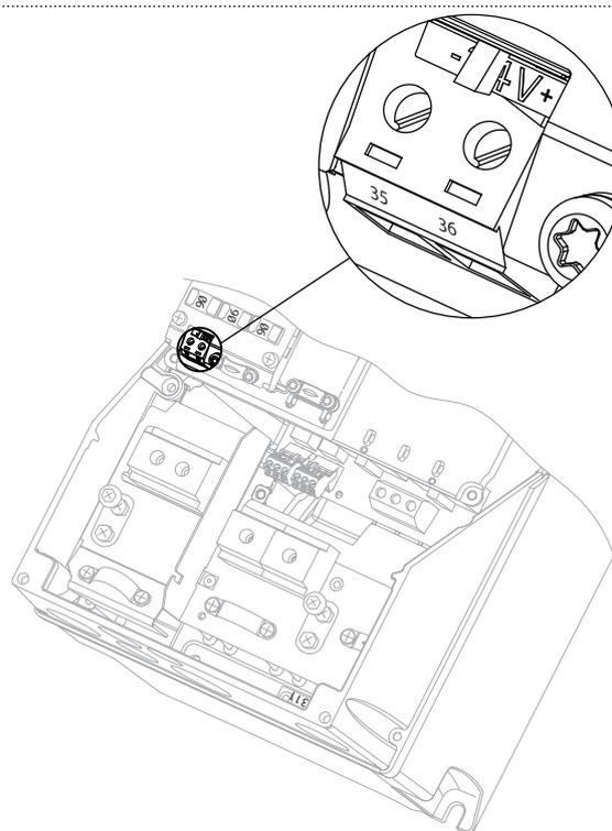
**Ilustração 3.5** Conexão à alimentação de reserva de 24 V (A5-C2).
