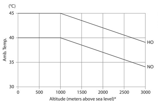
Derating da corrente de saída versus altitude na T<sub>AMB, MAX</sub> para chassis de tamanho D, E e F.
