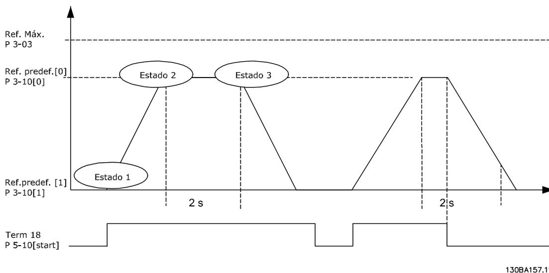
Programar os tempos de rampa nos par. 3-41 *Ramp 1 Ramp Up Time* e 3-42 *Ramp 1 Ramp Down Time* com os valores desejados
