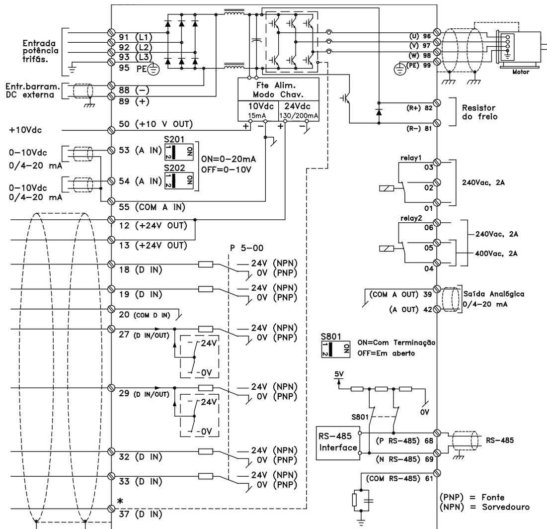
Ilustração 5.23 Diagrama que exhibe todos os terminais elétricos.
