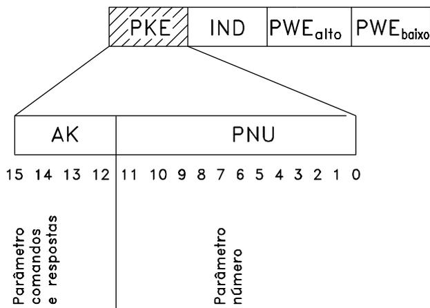
Os bits nºs. 12-15 são usados para transferir comandos de parâmetro, do mestre para o escravo, e as respostas processadas, enviadas de volta do escravo para o mestre.
