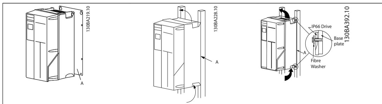
Tabela 5.2 Ao montar gabinetes metálicos tamanhos A5, B1, B2, B3, B4, C1, C2, C3 e C4 em uma parede traseira não sólida, o drive deverá estar equipado com uma placa traseira A devido à insuficiência de ar para resfriamento do dissipador de calor.
