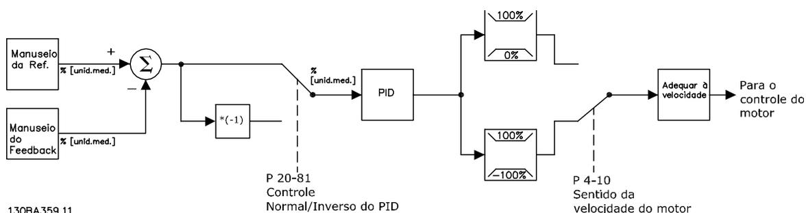
**Ilustração 2.11 Diagrama de Blocos do Controlador de Malha Fechada**
