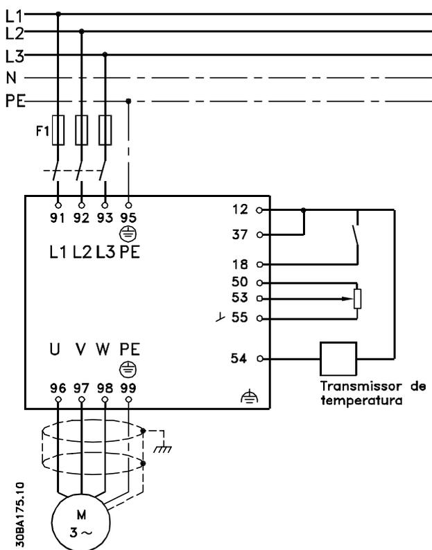
Ilustração 5.26 Diagrama de Conexão Elétrica.
