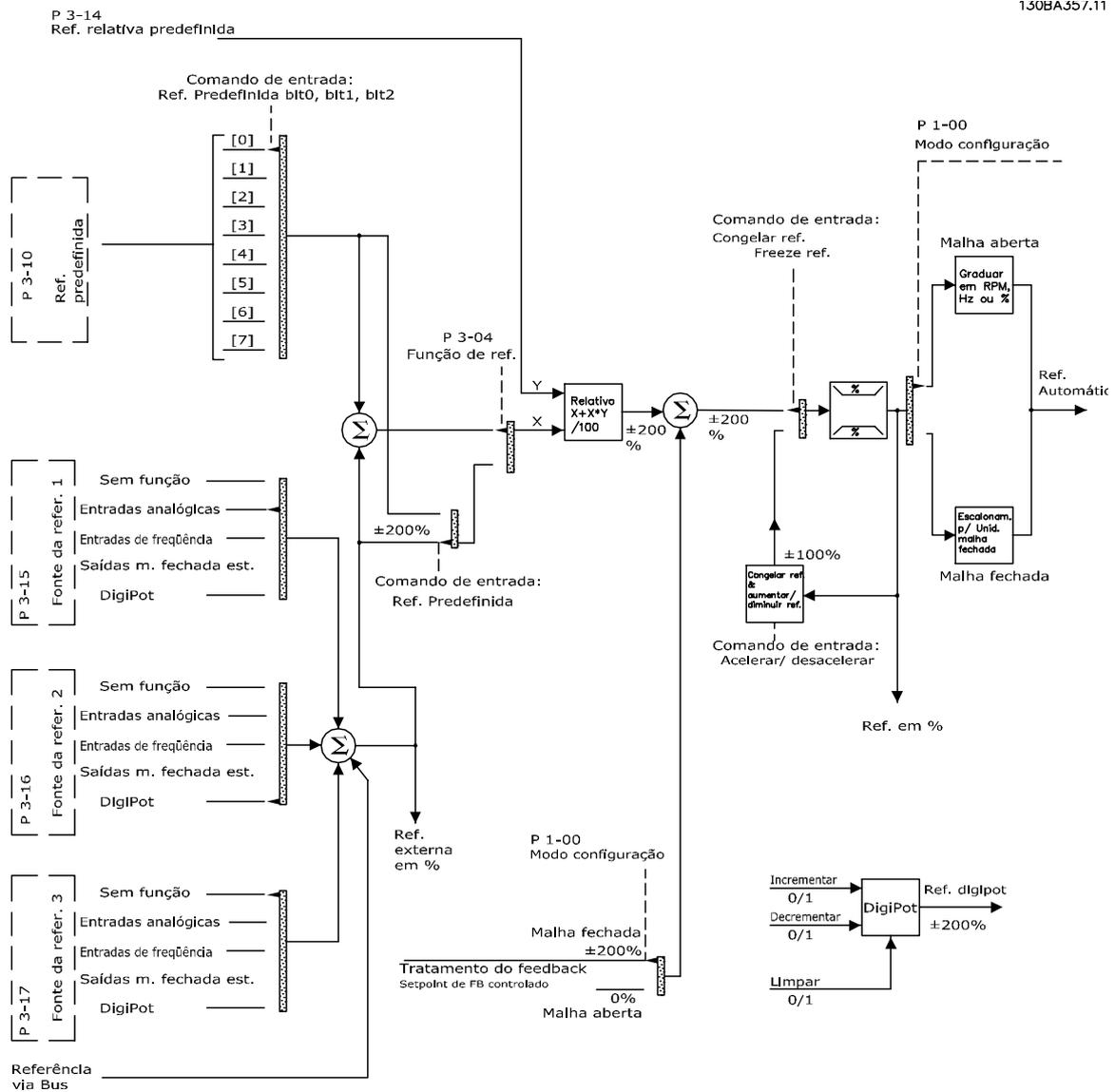
Ilustração 2.13 Diagrama em Bloco Mostrando Referência Remota
