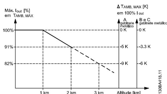
**Ilustração 8.2 Derating da corrente de saída versus altitude na TAMB, MAX para chassi de tamanho A, B e C. Em altitudes acima de 2 km, entre em contato com a Danfoss em relação à PELV.**
