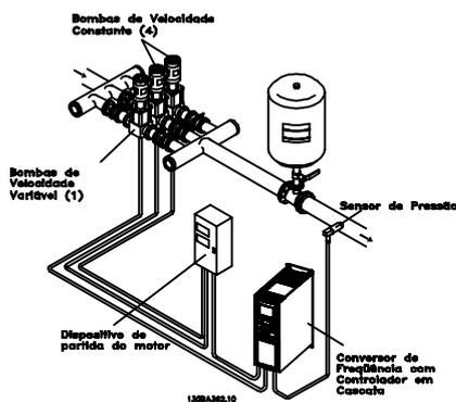
O Controlador em Cascata BÁSICO é usado para aplicações de bombas em que uma pressão ("carga hidráulica") ou nível determinado precisa mantido em um intervalo dinâmico amplo. Fazer uma bomba grande funcionar com velocidade variável, em uma larga faixa, não é uma solução ideal, devido à baixa eficiência da bomba e porque há uma limitação prática de cerca de 25% da velocidade nominal, com plena carga da bomba em funcionamento.
