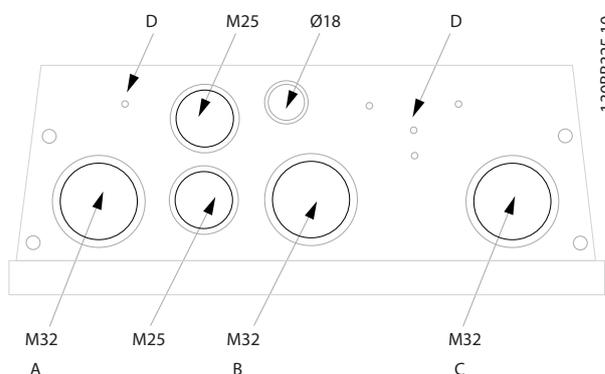
**Ilustração 5.9 Furos para entrada de cabo no gabinete metálico B1.** As sugestões de uso dos furos compreendem apenas recomendações; outras soluções são possíveis.
