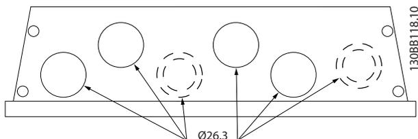
**Ilustração 5.7 Furos para entrada de cabo no gabinete metálico A5.** As sugestões de uso dos furos compreendem apenas recomendações; outras soluções são possíveis.
