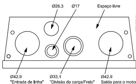
**Ilustração 5.10 Furos para entrada do cabo no gabinete metálico B2.** As sugestões de uso dos furos compreendem apenas recomendações; outras soluções são possíveis.
