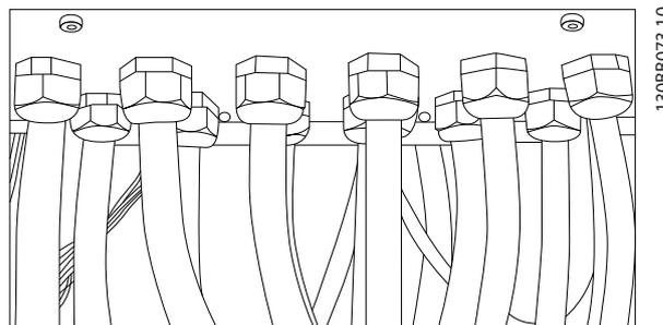
**Ilustração 5.14 Exemplo de Instalação Correta da Placa da Bucha.**
