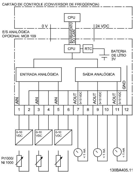
**Ilustração 3.6 Diagrama de princípios para E/S Analógica montada no conversor de frequência.**
