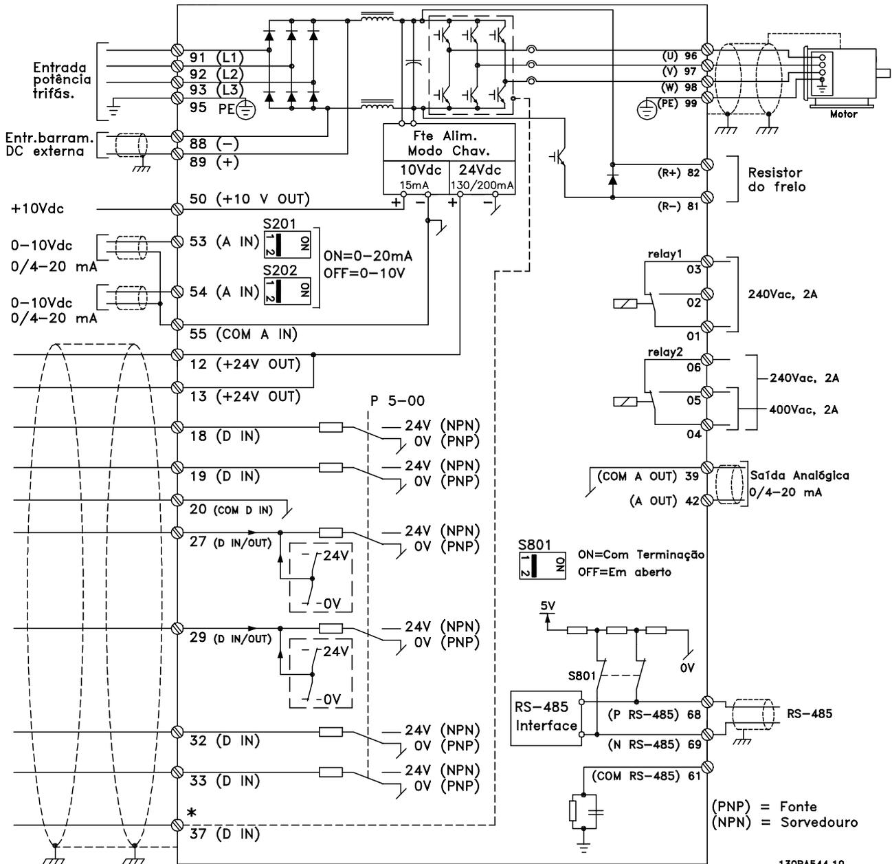
Ilustração 2.1 Diagrama exibindo todos os terminais elétricos. (O terminal 37 estará instalado somente nas unidades com a Função Parada Segura.)
