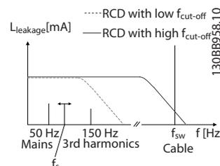
Ilustração 2.17 Croqui das Contribuições Principais para a Corrente de Fuga
