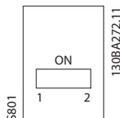
Ilustração 7.3 Configuração de Fábrica da Chave de Terminação
