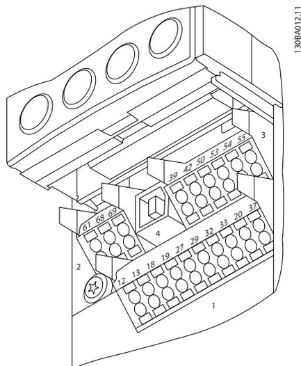
Ilustração 5.21 Terminais de controle (todos os gabinetes metálicos)
