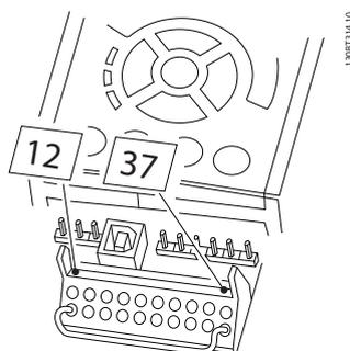
Ilustração 2.2 Coloque um jumper de conexão entre o terminal 37 e os 24 VCC.
