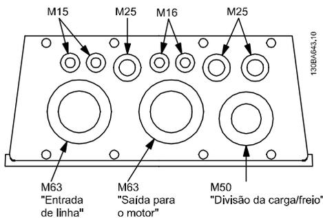
**Ilustração 5.12 Furos para entrada do cabo no gabinete metálico C1.** As sugestões de uso dos furos compreendem apenas recomendações; outras soluções são possíveis.
