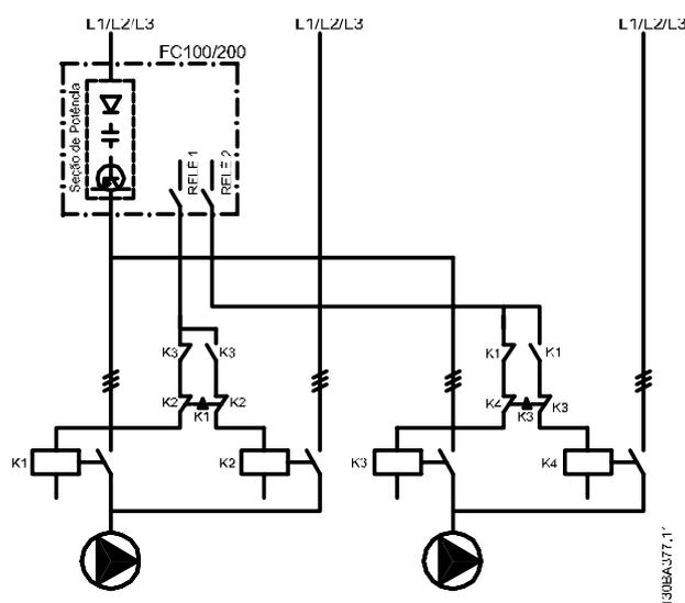
Cada bomba deve estar conectada a dois contactores (K1/K2 e K3/K4) com uma trava mecânica. Os relés térmicos, ou outros dispositivos de proteção do motor, devem ser aplicados, de acordo com a regulamentação local e/ou exigências individuais.
