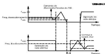
Com a alternância da bomba de comando ativada, pode-se controlar um máximo de duas bombas. Em um comando de alternância, a bomba de comando acelerará até uma frequência mínima ( $f_{min}$ ) e, após algum tempo, acelerará até a frequência máxima ( $f_{max}$ ). Quando a velocidade da
