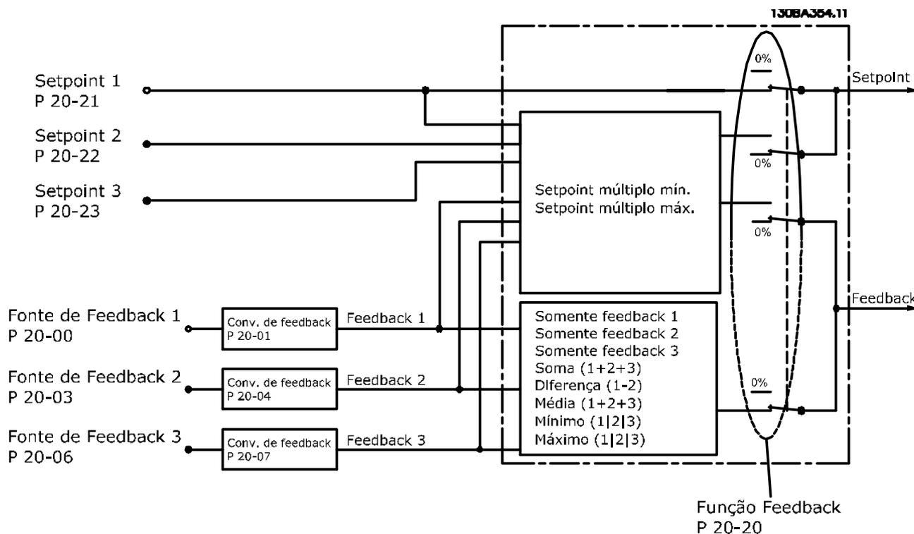
Ilustração 2.12 Diagrama de Blocos de Processamento de Sinal de Feedback
