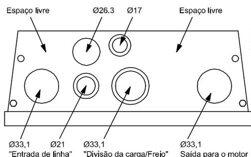
**Ilustração 5.8 Furos para entrada de cabo gabinete metálico B1.** As sugestões de uso dos furos compreendem apenas recomendações; outras soluções são possíveis.
