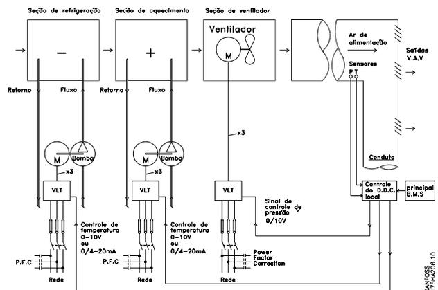
Ilustração 2.8 A figura mostra um sistema de ventiladores controlado por conversores de frequência.
