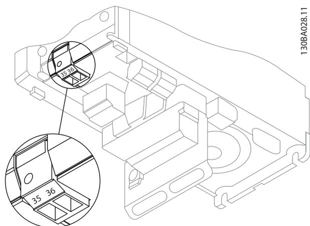
**Ilustração 3.4** Conexão à alimentação de reserva de 24 V (A2-A3).
