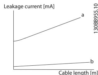
**Ilustração 2.15 Desenho do princípio mostrando como a corrente de fuga é influenciada pelo comprimento do cabo e pelo tamanho da potência.  $P_a > P_b$ .**
