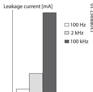
Ilustração 2.18 Desenho de Princípios Mostrando como a Frequência de Desativação do RCD Influenciará o que é Respondido/Medido.
