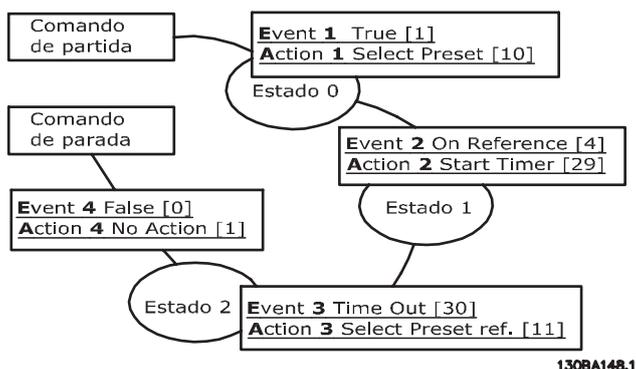
Programa o Smart Logic Control no 13-00 SL Controller Mode para ON (Ligado).
