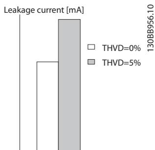
Ilustração 2.16 Desenho de princípios mostrando como a corrente de fuga é influenciada pela distorção da linha.
