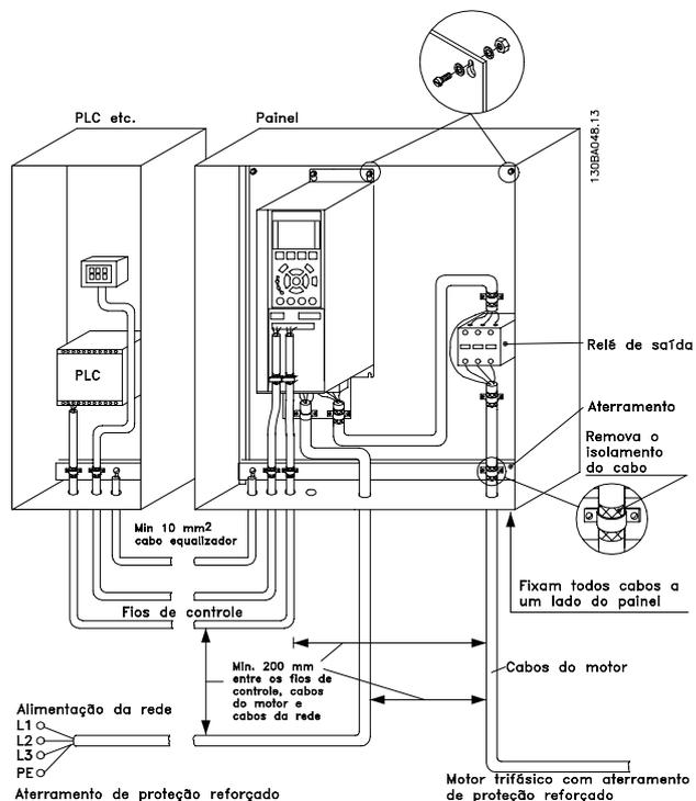
Ilustração 5.25 Instalação elétrica em conformidade com a EMC de um Conversor de Frequência no painel elétrico.
