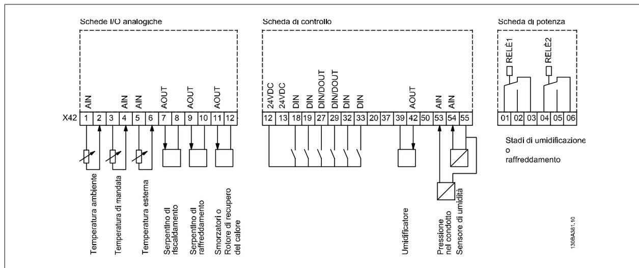
Mostra un tipico climatizzatore (AHU). Com'è evidente, l'aggiunta dell'opzione I/O analogici offre la possibilità di controllare tutte le funzioni dal convertitore di frequenza, come serrande di aspirazione, ritorno e scarico o bobine di riscaldamento/raffreddamento leggendo le misurazioni della temperatura e della pressione dal convertitore di frequenza.
