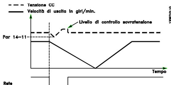
Disegno 3.2: Rampa di decelerazione controllata - guasto di rete breve. Decelerazione fino all'arresto seguita da accelerazione fino al riavvicinamento.
