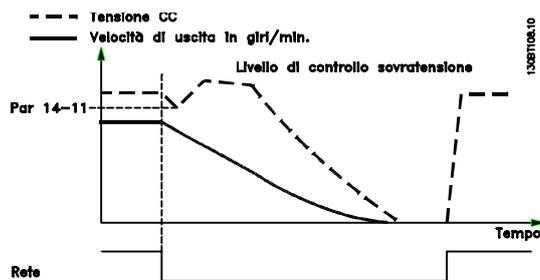
Disegno 3.3: Rampata di decelerazione controllata, guasto di rete prolungato. Decelerazione fin quando l'energia nel sistema lo consente, poi il motore è in evoluzione libera.
