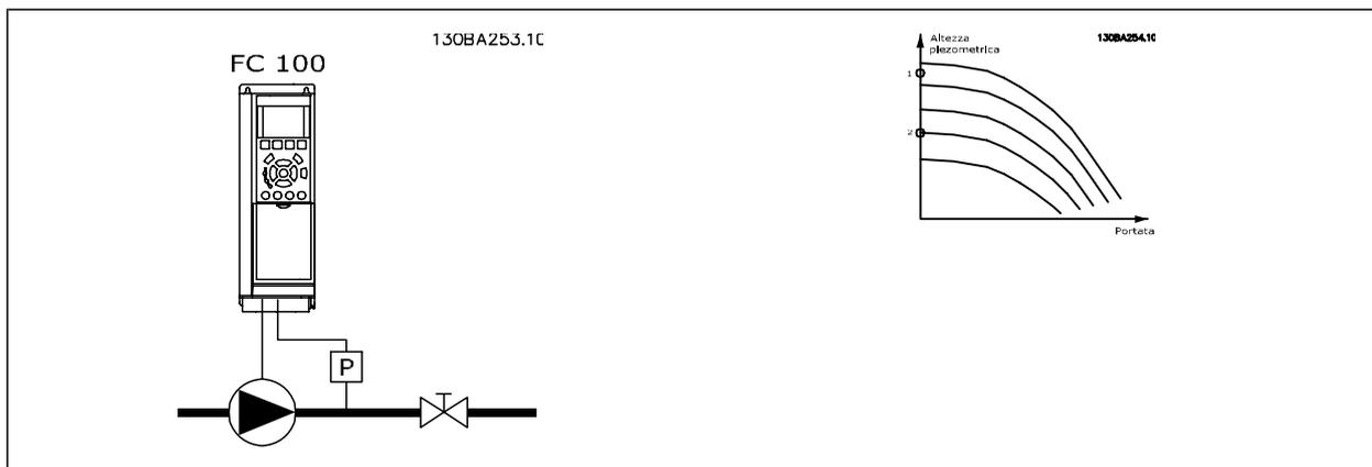
*Rilevam. portata nulla* è basato sulle misurazioni di velocità e potenza. Per una data velocità, il convertitore di frequenza calcola la potenza in assenza di flusso.
