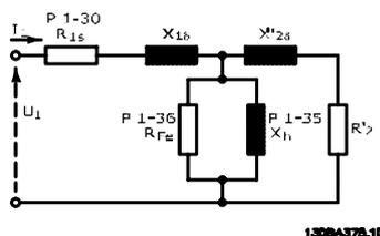
Disegno 3.1: **Grafico equivalente di un motore asincrono**
