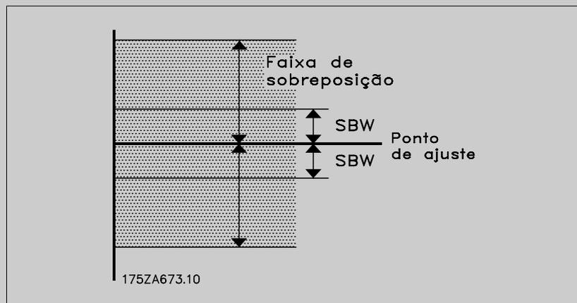
A configuração de OBW muito próxima de SBW poderia anular o propósito, com freqüentes escalonamentos nas alterações momentâneas de pressão. A configuração de OBW muito alta poderia resultar em pressão inaceitavelmente alta ou baixa no sistema, enquanto os temporizadores da SBW estiverem funcionando. O valor pode ser otimizado com a familiaridade crescente com o sistema. Consulte par.25-25 *Tempo da OBW*.
