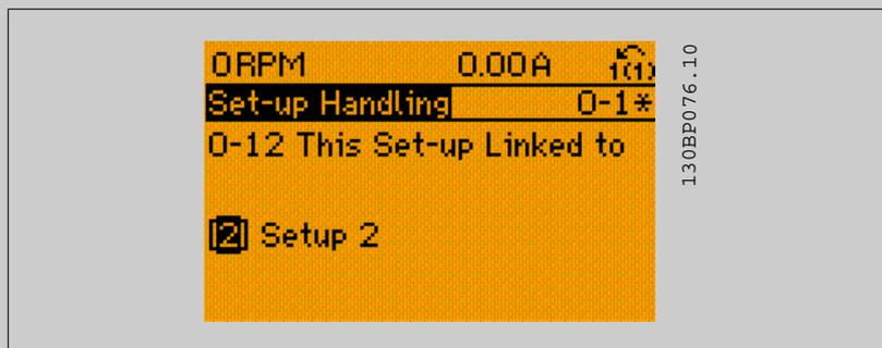
Depois que a conexão estiver completa, o par.0-13 *Leitura: Setups Conectados* exibirá {1,2} para indicar que todos os parâmetros 'não alteráveis durante a operação', agora, são os mesmos no Setup 1 e no Setup 2. Se houver alteração de um parâmetro 'não alterável durante a operação', por ex., o par.1-30 *Resistência do Estator (Rs)*, em Setup 2, eles também serão alterados automaticamente no Setup 1. Desse modo, torna-se possível alternar entre o Setup 1 e o Setup 2, durante a operação.
