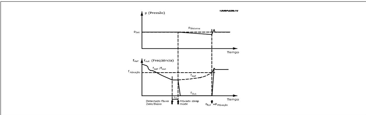
Quando for detectada baixa energia ou velocidade baixa, o motor é parado, mas o sinal de referência ( $f_{ref}$ ) do controlador externo ainda é monitorado e devido à baixa pressão criada, o controlador aumenta o sinal de referência para ganhar pressão. Quando o sinal de referência atingir um valor programado  $f_{wake}$ , o motor dá partida novamente.
