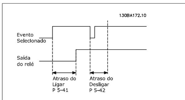
Se a condição do Evento seleccionado mudar, antes do estado de ligado - ou desligado- do temporizador de atraso expirar, a saída do relé não é afetada.
