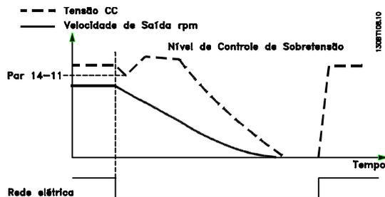
Ilustração 3.3: Desaceleração Controlada, falha de rede elétrica mais longa. Desaceleração enquanto a energia no sistema permitir, em seguida o motor é parada por inércia.
