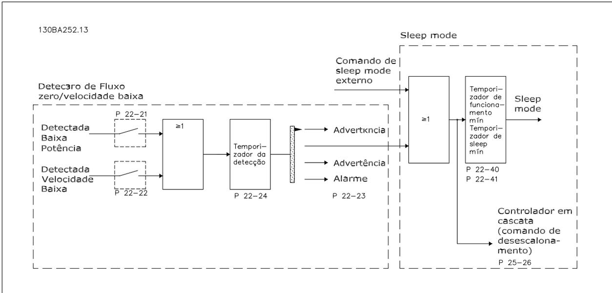
O conversor de frequência inclui funções para detectar se as condições de carga no sistema permitem que o motor seja parado:
