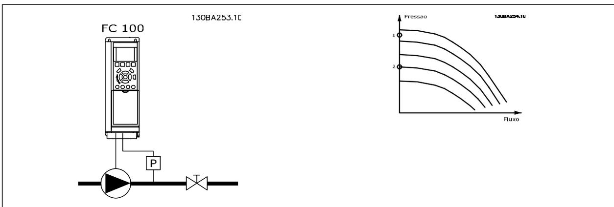
*Detecção de Fluxo Zero* baseia-se nas medidas de velocidade e potência. Para uma determinada velocidade, o conversor de frequência calcula a energia com fluxo zero.
