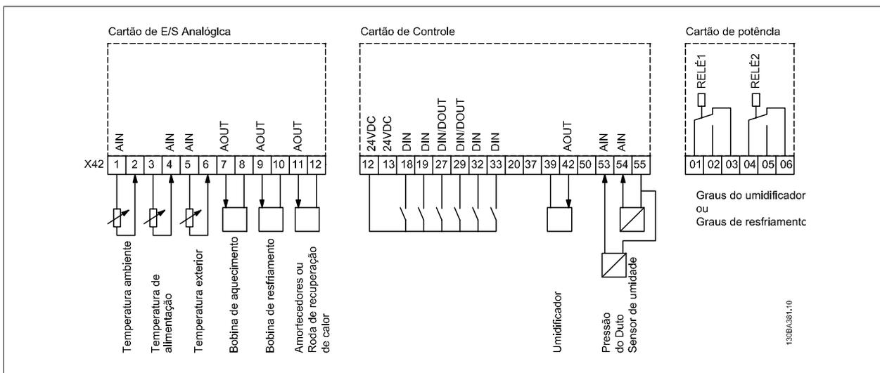
Este diagrama mostra uma Unidade de Tratamento de Ar (AHU-Air Handling Unit). Pode-se notar que a adição do opcional de E/S Analógica permite controlar todas as funções a partir do conversor de frequência, tais como a entrada, retorno e amortecedores de exaustão ou as bobinas de aquecimento/resfriamento, com medições de temperatura e pressão sendo lidas pelo conversor.
