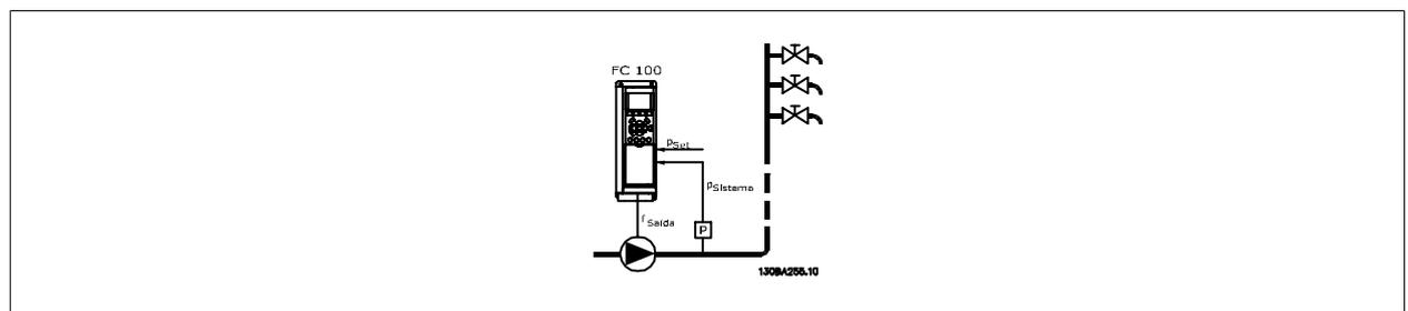
1) Sistemas onde o controlador PI integrado é utilizado para controlar a pressão ou temperatura, p.ex., sistemas de boost com um sinal de feedback de pressão aplicado ao conversor de frequência, a partir de um transdutor de pressão. O par.1-00 *Modo Configuração* deve ser programado para Malha Fechada e o Controlador de PI com os sinais de referência e de feedback desejados.
