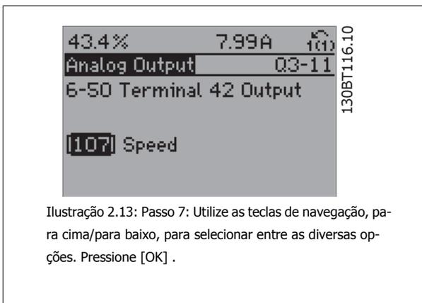
Ilustração 2.13: Passo 7: Utilize as teclas de navegação, para cima/para baixo, para seleccionar entre as diversas opções. Pressione [OK] .
